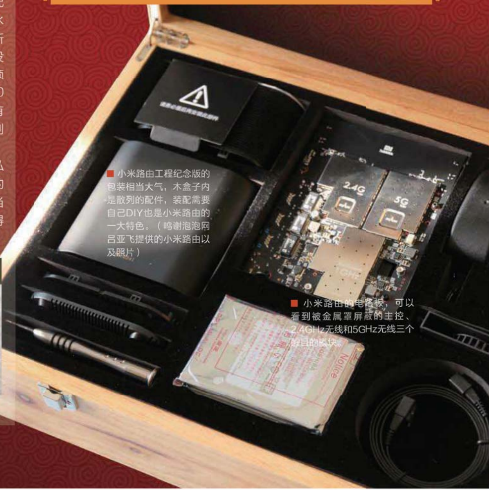
■ 需要先安装好电路板后再装入硬盘，最后盖上底盖。
