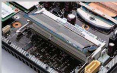
>> 提供了两根内存插槽，加上设计有专门的内存升级窗口，因此可以很方便地升级内存。
