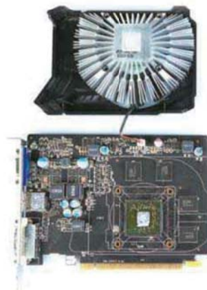
② 蓝宝石R7 250采用2+1相供电设计，每相核心供电搭配了3个SO-8封装形式的MOSFET。
