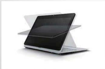
Fit 13A, 利用屏幕上的转轴来实现模式的切换,但令人吃惊的是并没有明显增加机身厚度,唯一的遗憾就是转轴没有阻尼,不能悬停在任意角度。
