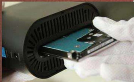
■ 需要先安装好电路板后再装入硬盘，最后盖上底盖。
