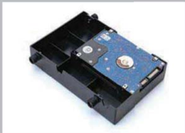
>>标配了1TB的2.5英寸硬盘，但是预留的是3.5英寸硬盘的免工具安装位，扩展性更强。
