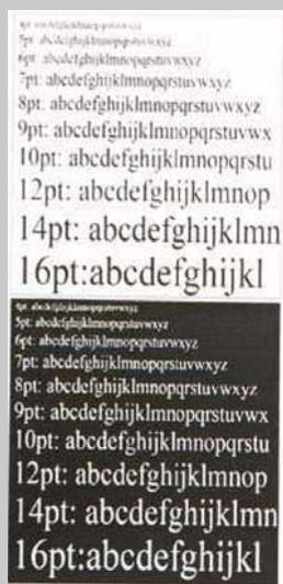
>> 使用默认的常规打印质量打印，样张字迹清晰锐利，可分辨最小4pt字样。
