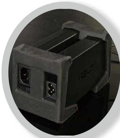
■ 因为配置偏高, ROG 20直接采用了两个电源转换器捆绑的方式, 分别为显卡和主板系统进行供电。
