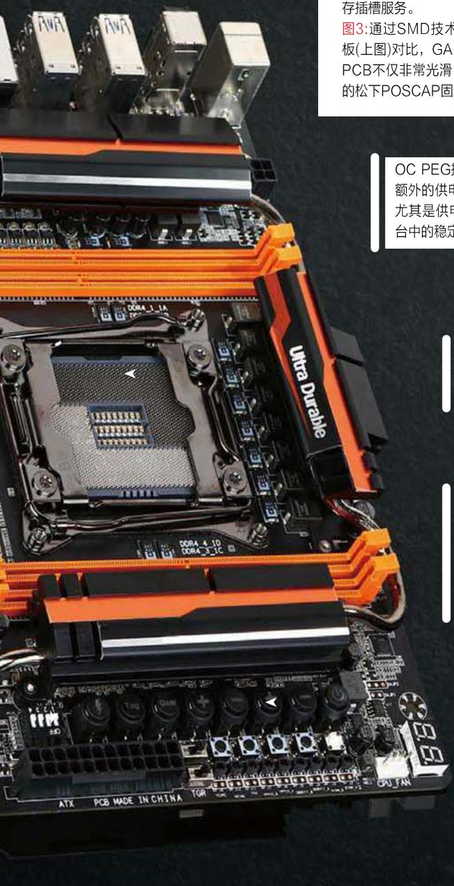
图1:配备服务器级电感、松下POSCAP固态电容、第二代PowIRstage一体式MOSFET等高品质元件的8相供电电路。
