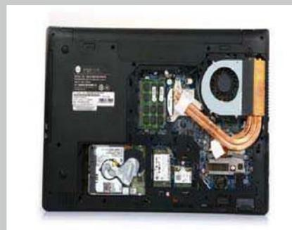
>> 雷神G150MG的散热系统用料实在, 采用大口径风扇以及三铜管模组, 另外显卡部分还采用了纯铜散热块覆盖。
