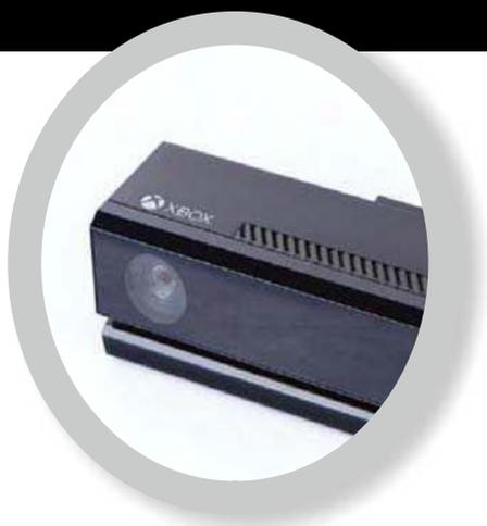
■ 相比上一代, Kinect 2.0变大了“一圈”,也变得更方正了,它也同样加入了大面积的通风散热设计。此外,其内置的摄像头也变大了。这也使得它能识别的区域更广。
