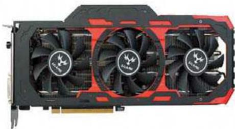
**推荐理由:**七彩虹iGame970烈焰战神X-4GD5 TOP在造型上颇有些“九段”风范,只是在色调方面,红黑配色看上去更加凶猛。散热部分采用了我们熟悉的三风扇加六热管设计,仍支持AirKit散热套件,在一些极限条件下能进行辅助散热。拆开散热模块,华丽的8+3相供电模组映入眼帘,它们能为GPU和显存带来更强劲且精确的供电,为GPU冲击更高频率提供帮助。产品设计了一个双频切换开关,一键提升核心频率。超频后测试,显卡成绩领先公版产品约5%左右。近期有意入手游戏显卡的玩家们,不妨关注这款产品。
