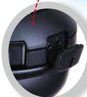
■ 右耳罩底部有一个橡胶盖,打开它可以看到里面有两个接口,功能分别是连接 Xbox 手柄实现通话和将耳机的声音分享给另一个耳机,它们的旁边是电源开关。
