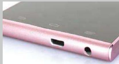
>> 底部的micro USB接口和耳机插孔处理得不够合理,如果将USB接口移至底部中央,将耳机接口放置在侧面或者顶部会显得更合理一些。
