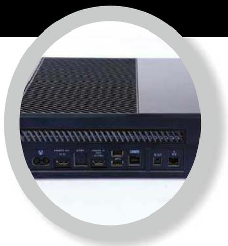
■ Xbox One拥有丰富的接口,包括一个HDMI输入、一个HDMI输出、三个USB(两个在背面一个在侧面)以及一个光纤音频接口和一个千兆以太网接口,可谓是有求必应。
