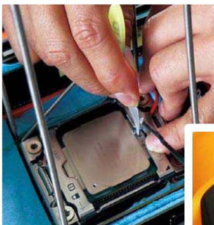
■ 对Haswell-E处理器进行极限超频的关键技术点在于控制好温度,如能稳定、持续地将处理器温度控制在-120℃左右是最好的。
