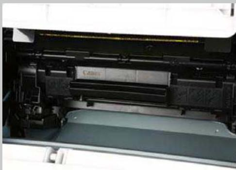
>> 向上掀开出纸口底板，就可以看见打印机硒鼓部分（CRG 925），硒鼓上标有图示，拆装方便。
