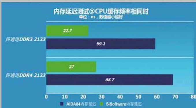
**测试点评:** 可以看到，在进行这一变化后，DDR4 2133内存的性能有了明显的提升，与DDR3 2133相比已经非常接近，其中在AIDA64内存写入带宽的测试中还反超DDR3 2133，其总体内存性能已达到DDR3 2133内存的95%，同时虽然其延迟仍高于DDR3内存，但也从先前的71.2ns缩短到68.7ns。
