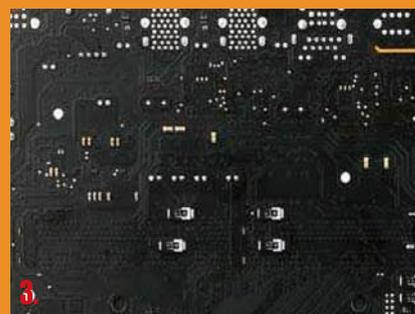
MOSFET部分,GA-X99-SOC Force LN2主板虽然仍采用国际整流器公司的PowIRstage MOSFET,但它的型号却由IR3551、IR3553M升级为IR3556第二代PowIRstage一体式MOSFET。它最大可输出50A的电流,拥有更加精确的电流与温度检测算法,其转换效率提升到最高90%,并减少了MOSFET开关时产生的干扰信号,以及驱动器与MOSFET之间的控制延迟,而其特别的DEM工作模式则可以
