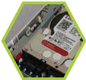
安装好一块硬盘之后，另一块硬盘需使用随机附带的数据线连接，大大缩小了双盘位NAS的体积。
