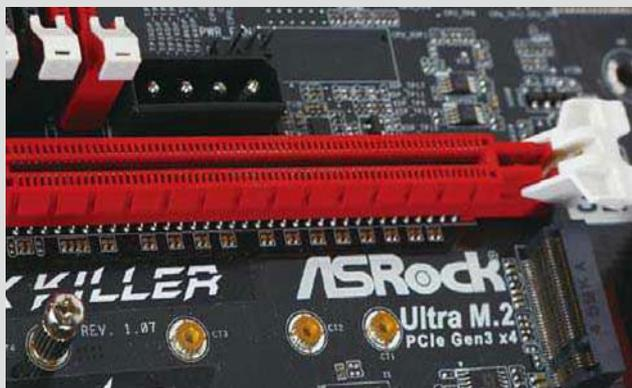
① 超级M.2接口连接PCIe 3.0 x4通道,不让接口成为SSD性能发挥的瓶颈。
