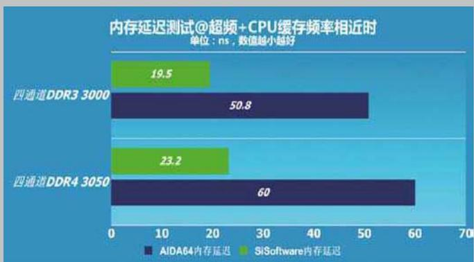
**测试点评:** DDR3内存有一个很特殊的特性, CAS、TRCD、TRP三大延迟对内存性能有极大的影响, 如果将这几个延迟设置得较高, 即便内存可以工作在更高的频率下, 但其性能也会受到大幅损失。如图所示, 其在DDR3 3000下的内存带宽甚至还低于其在DDR3 2133下的成绩。因此如果为了频率, 将延迟设置为15-17-17-37@2T, 只会进一步令性能受损。而DDR3内存的这一特性也早已被业界所了解, 往往DDR3 3000以上的频率都采用高延迟设置, 只是用来冲击内存频率的产物, 其性能并不会有多好。
