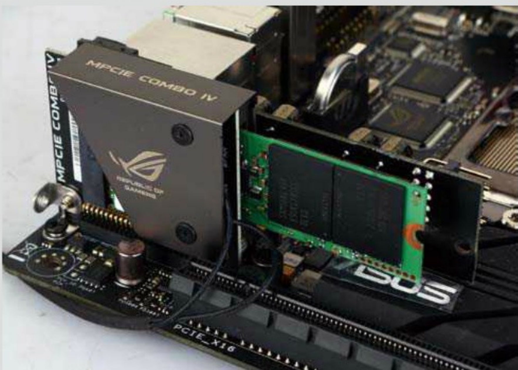
① 相比主板上的M.2接口,在mPCIe Combo IV子卡上安装M.2固态硬盘更加方便,无需螺丝,只要将固态硬盘插入接口即可固定,且硬盘长度不受限制。
