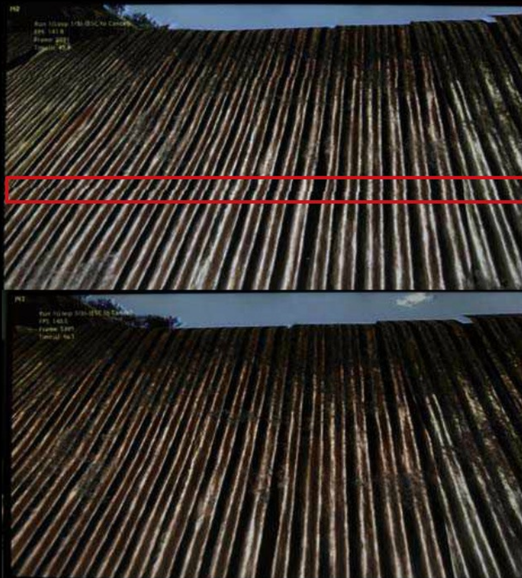
■ 在《FarCry2》的游戏画面中，我们通过相机进行了画面捕捉，可以看到上图（未开启G-SYNC）出现了明显画面撕裂现象；而下图（开启G-SYNC）则没有出现，以此证明ROG SWIFT PG278Q显示器在游戏画面的优化方面确实有改善。
