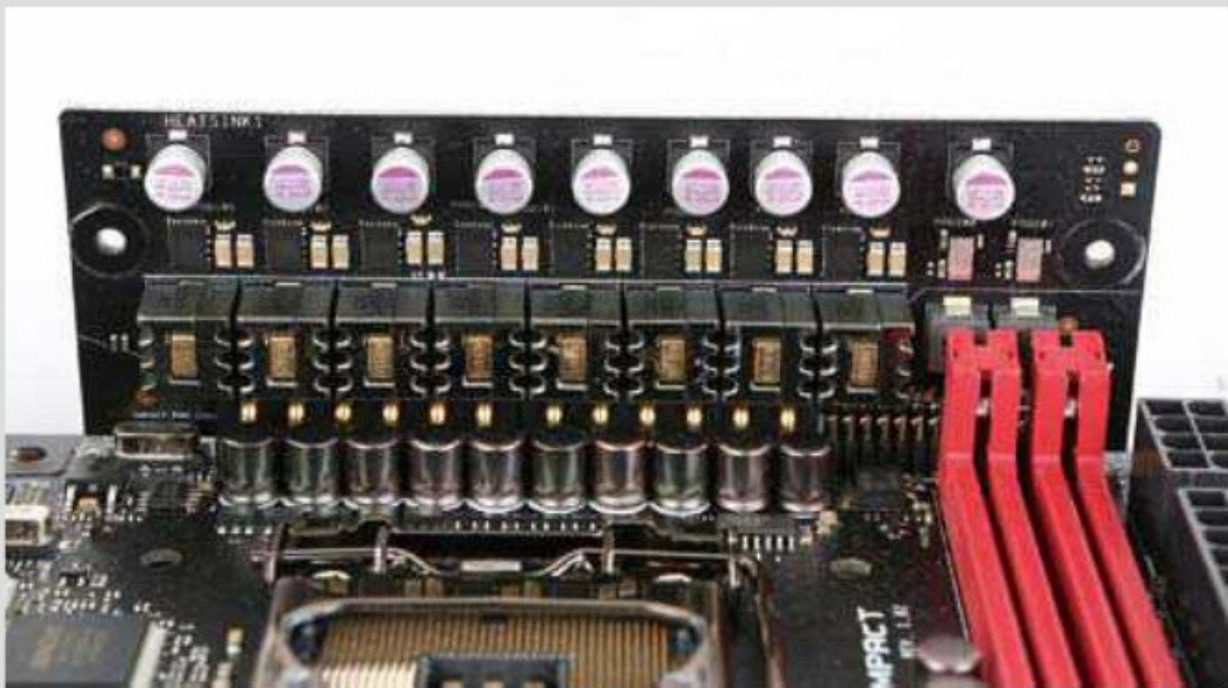
① 处理器与内存供电电路全部被安装在名为IMPACT POWER II的独立PCB上,其中处理器供电电路采用8相供电设计,搭配FPCAP日系固态电容(在105°C高温下,可工作5000小时)、IR 3553M PowIRstage一体式MOSFET与最大可承载60A电流的黑翼电感。其内存供电电路则采用两相设计,换用德州仪器的NexFET封装MOSFET。
