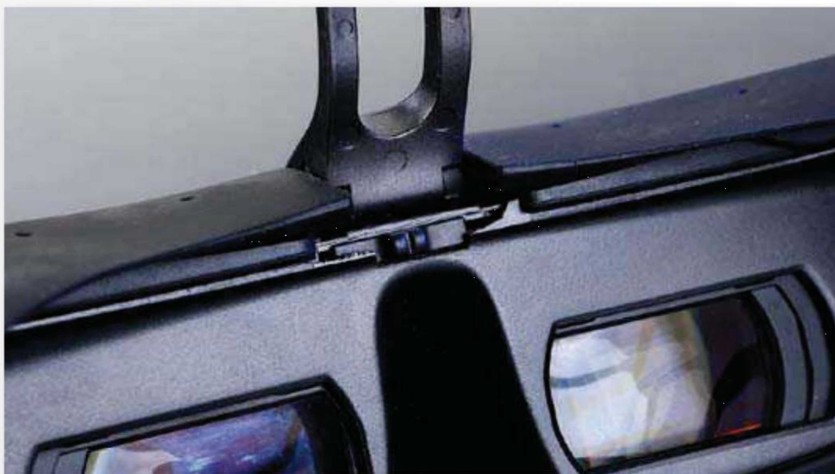
■ 额头支撑器可以较大范围调节，它增加了一个锁定键用于固定调节位置。
