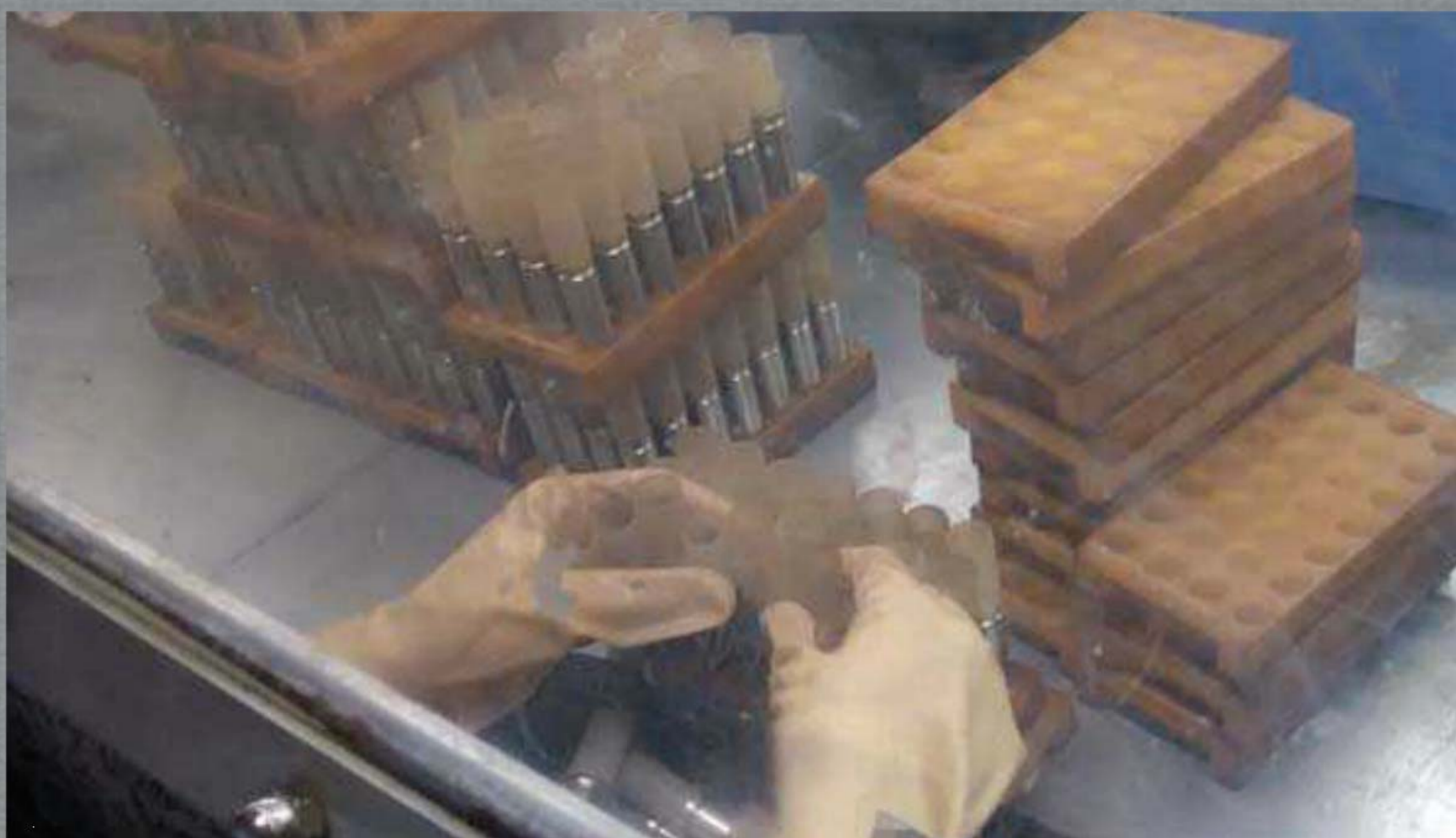
■ 工人在充满惰性气体氩气的手套箱内注入电解液,手套箱内氧气浓度必须低于10ppm (接近无氧环境),防止电极氧化。
