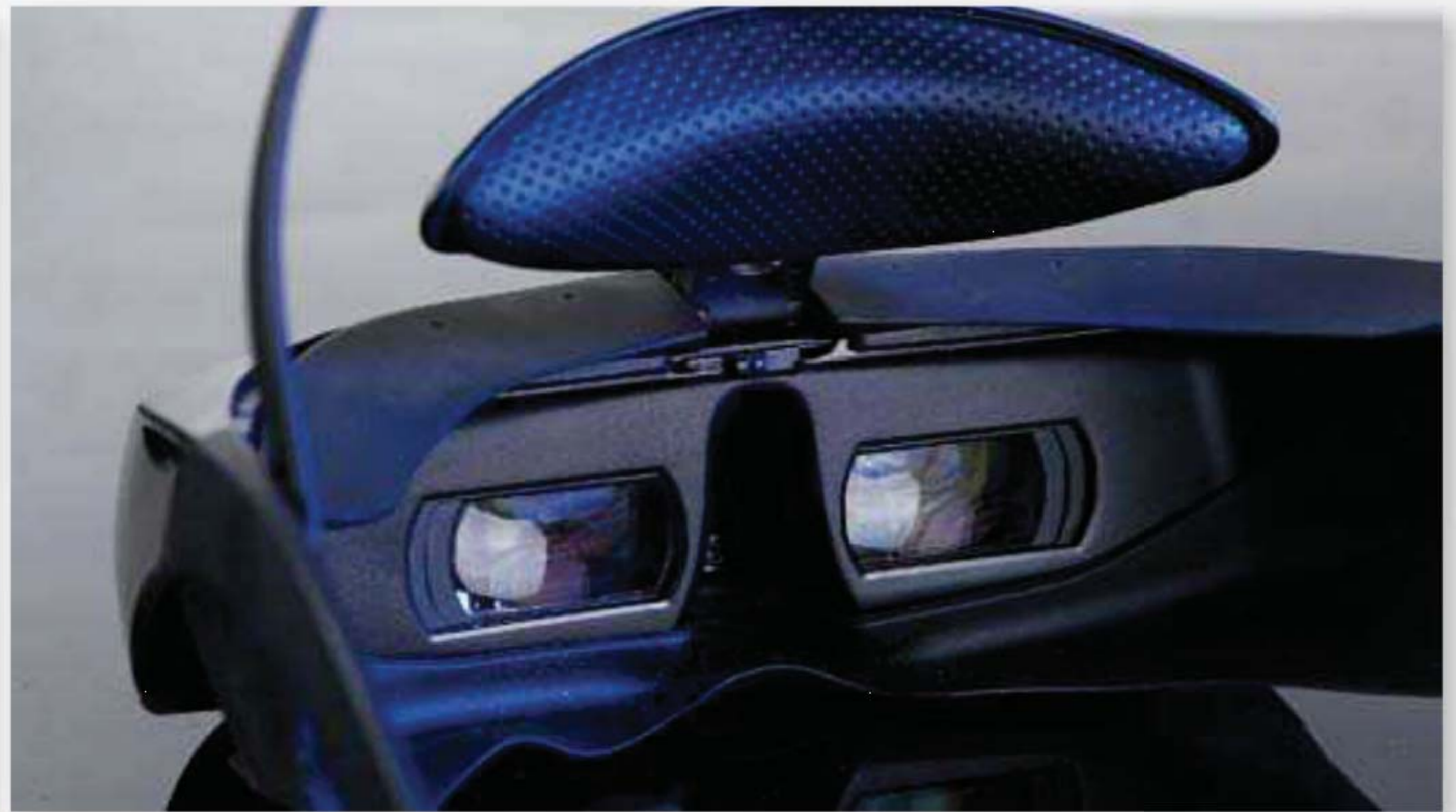
■ 上下方都有厚厚的可以拆卸的遮光罩，用以营造全黑视界，实际效果很不错。
