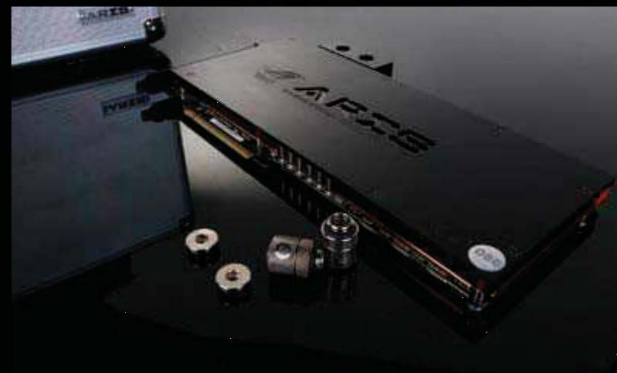
ARES III 显卡采用 DIY 水冷设计, 因它, 我们组建了华丽的 DIY 水冷系统。
