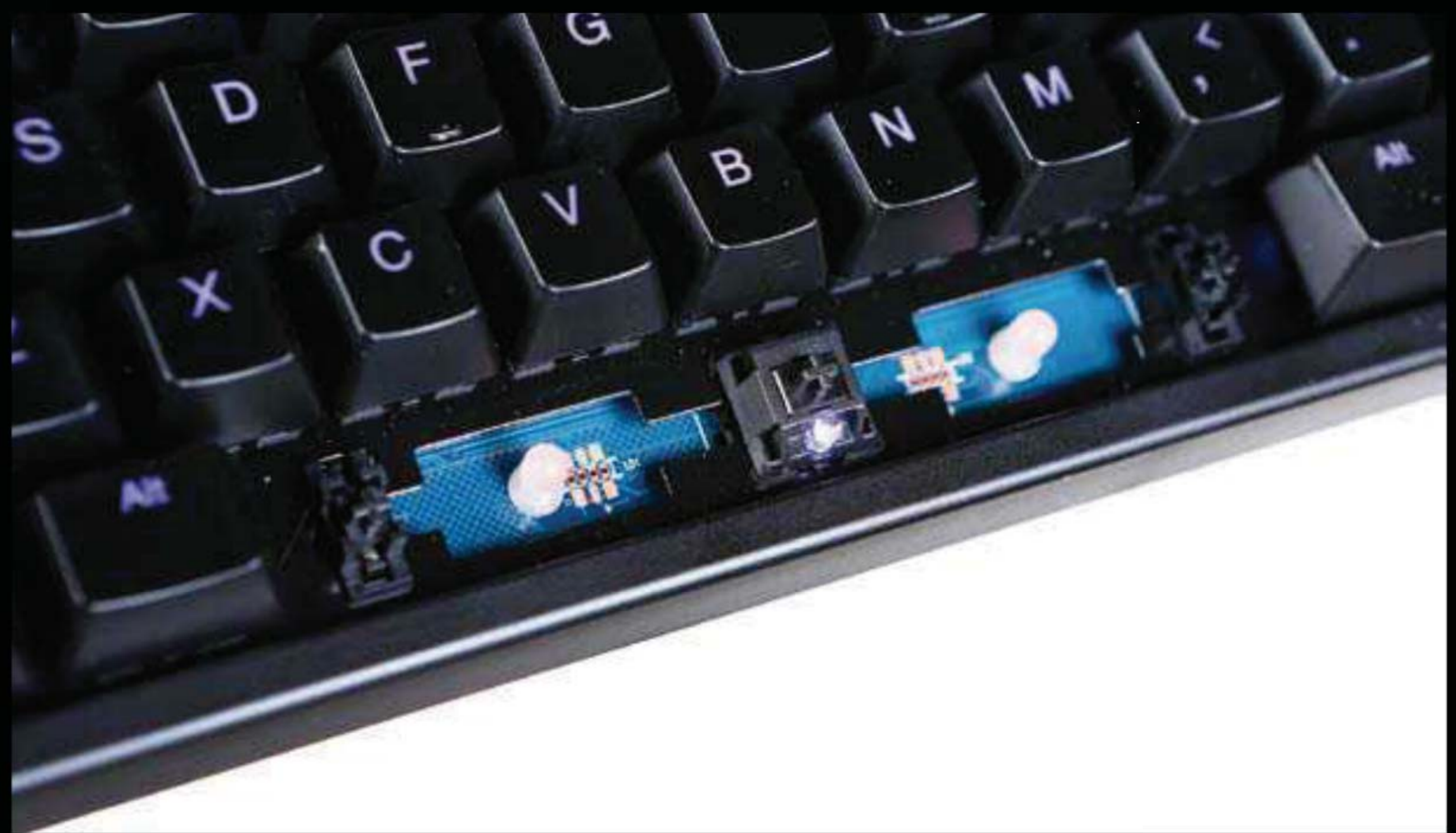
■ 空格键左右两边有卫星轴改善手感，两颗RGB LED可以自己调节色彩。
