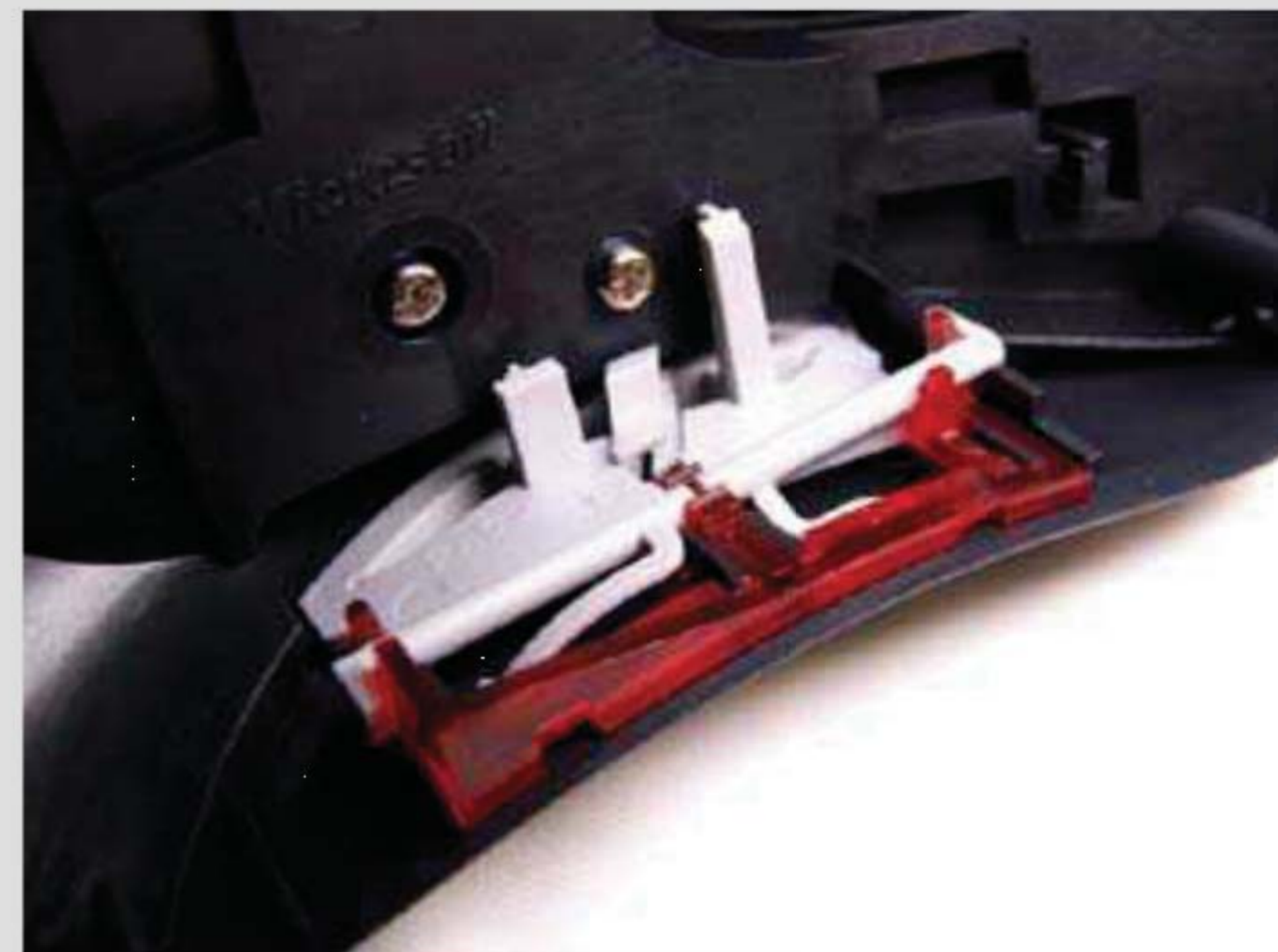
■ 拆开鼠标后可以看到侧键与微动的接触方式很复杂，这也是导致侧键手感差的最大的原因。
