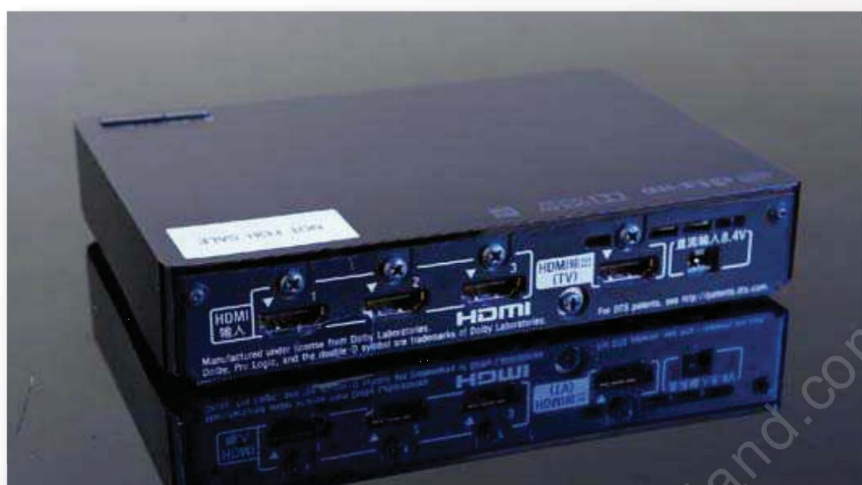
■ 发射器具备三组 HDMI 输入,有效距离不算太远,但至少在一个房间里摆脱了束缚。
