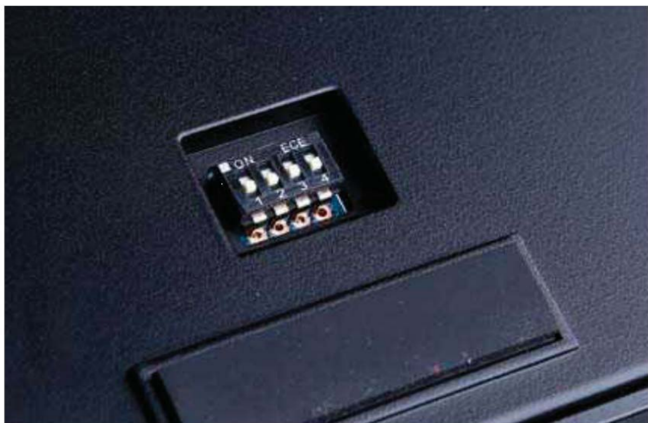
■ 后部的四个DIP开关可以设置特殊按键的键位。
