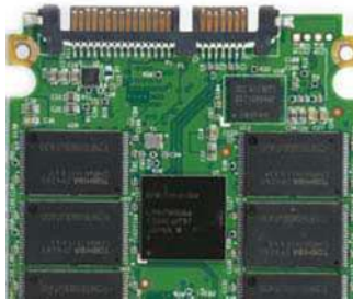
⊕ LAMD LM87800主控芯片和三星缓存DDR2缓存。
