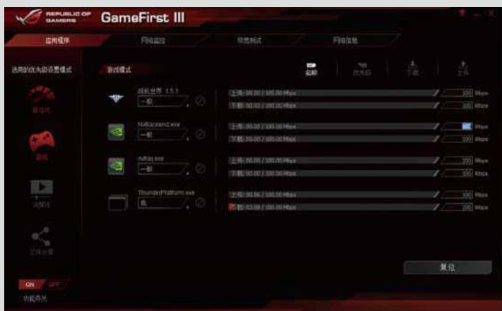
④ GameFirst III网络延迟优化工具可以根据应用环境对各个程序的网络使用优先级进行自动调整,如在进行游戏时,迅雷下载程序的优先级就被调节为“低”。
