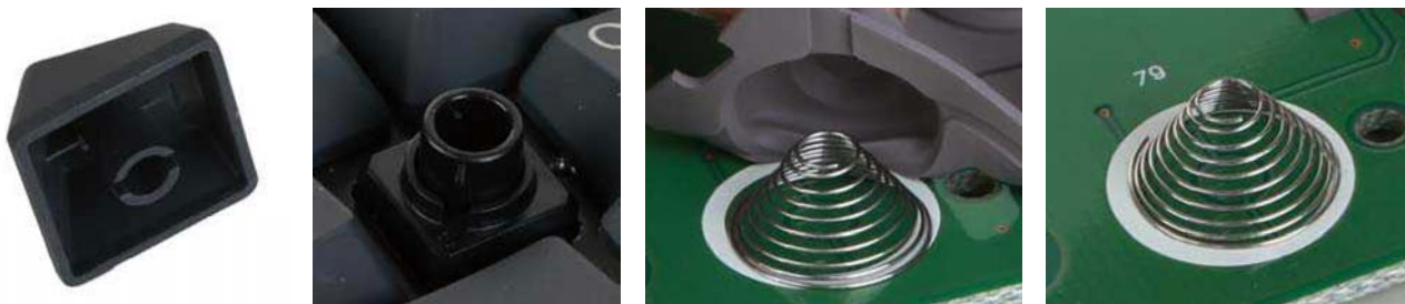
■ 完全拆开之后，我们可以将TypeHeaven 104U最为核心的元件罗列出来，这也是静电电容按键开关的核心所在。分别是：键帽、行程柱、橡胶碗、锥形弹簧以及检测用PCB电路板。
