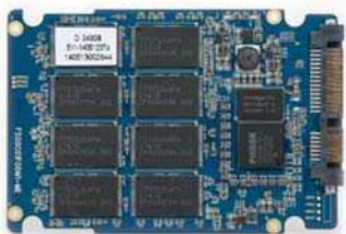
② 采用群联PS3108主控方案，板载256MB南亚DDR3缓存芯片。
