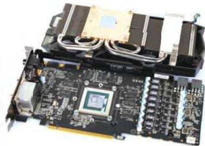
■ 七彩虹iGame GTX 970烈焰战神U的PCB参考了公版GTX 980的设计，散热改为双风扇搭配4热管底座组合。
