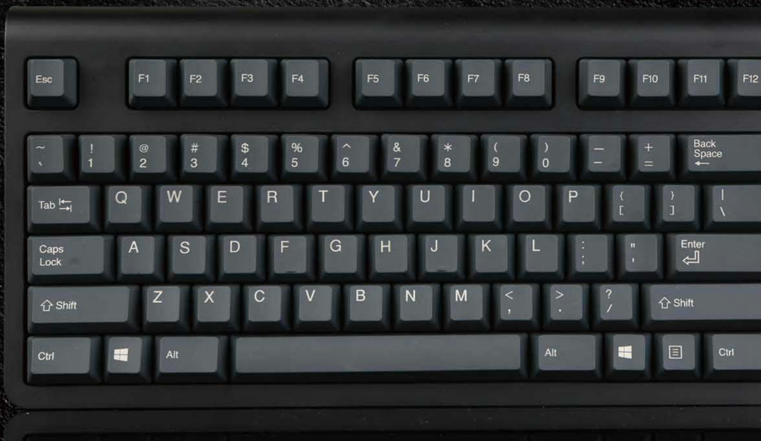
图1: TypeHeaven 104U的上盖采用了哑光的表面处理工艺。从实际材质来看,应该从模具端控制塑胶射出成型的工艺。这种工艺相比二次喷涂带来的哑光效果在耐用性和耐磨性上更为优秀。
