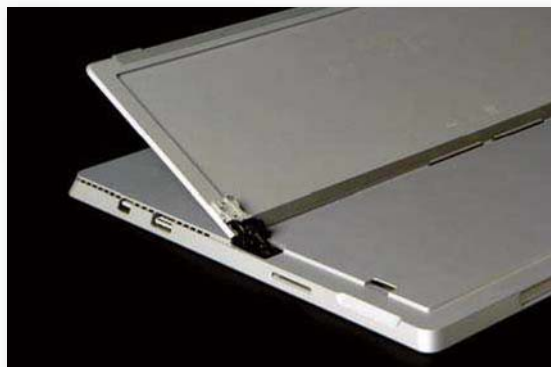
■ USB 3.0、Mini DisplayPort、充电接口以及 Micro SD 卡槽都在机身的右侧, 不过 Micro SD 卡槽需要将支架翻过去才能看到。
