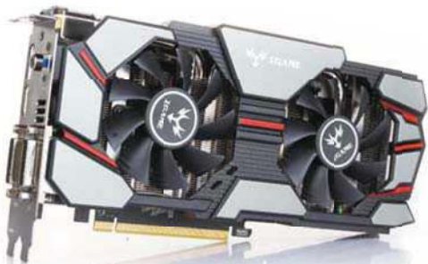
■ 七彩虹iGame GTX 970烈焰战神U的PCB参考了公版GTX 980的设计，散热改为双风扇搭配4热管底座组合。
