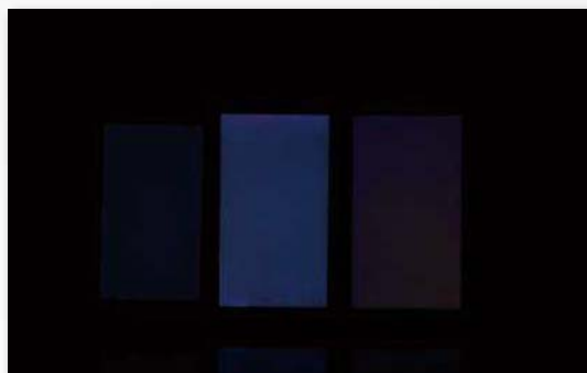
■ 从左至右依次为Find 7、K920、3S,全黑状态下最高亮度依次是0.22cd/m 2 、0.57cd/m 2 、0.36cd/m 2 。
