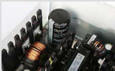
⑥ 主电容是一枚450V/220µF的元件,PFC电感比较扎实。在功率变换电路部分采用了双管正激和单路磁放大的结构。
