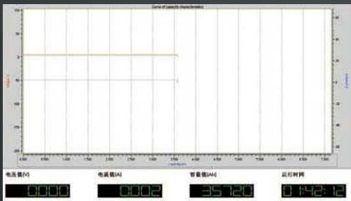
■ 2.1A实际输出电能为17Wh (3572mAh×4.76V)
