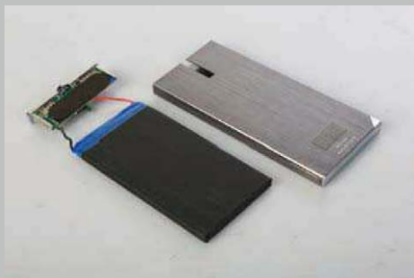
■ 使用了两块锂聚合物电芯并联的组合方式，PCB背面设计有绝缘垫，铝合金外壳厚度达到了1mm左右。
