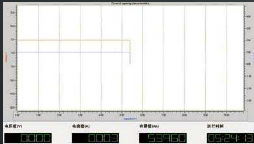
■ 1A实际输出电能为25.8Wh (5396mAh×4.78V)
