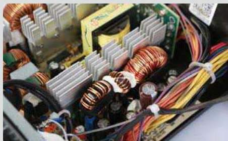
⑥ 密实的后级输出电容集群以及电感堆, 相比不少廉价的500W级电源, MVP500的用料与做工将其远远甩在了身后。
