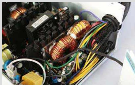
④ 后级输出电路部分的用料比较扎实,没有元件的空位。两个电感分别对应+12V和+5/+3.3V的储能转换。
