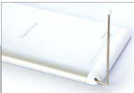
左下角藏着一根收缩式的模拟电视的信号天线，不过并不实用，在室内信号很差，画面基本一片“雪花”。
