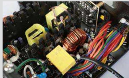
⑤ 在功率变换电路部分采用了时下流行的双管正激结构，低压输出电路上的设计和用料也比较中规中矩。
