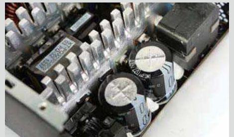
⑥ 主电容由两枚400V/220μF的高品质电容并联构成，有些类似于千瓦级电源上常用的交错式PFC的用料设计。
