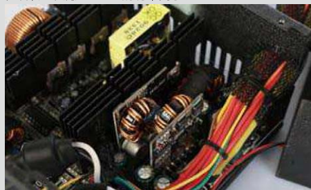
⑥ 后级输出电路部分, GP600G采用了+12V同步整流和+5V/+3.3V的DC-DC模块电路设计, 对于一款不到300元的电源而言, 是非常难得的。这也是GP600G取得80PLUS金牌认证的主要原因之一。
