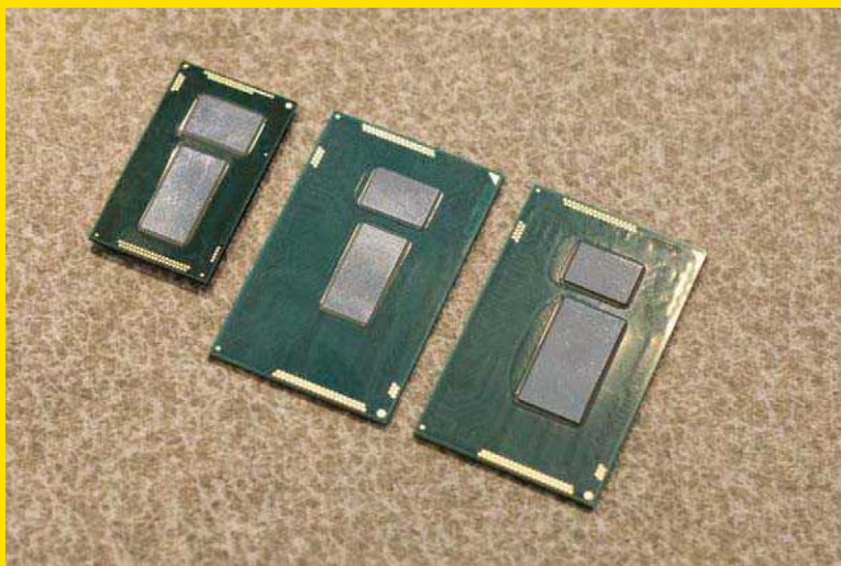
■ Broadwell核心图，可见长方形的芯片面积越来越小。图中从左到右分别是Broadwell的小型封装版本、Broadwell的超低电压版，Haswell的移动版本。
