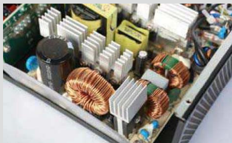
⑤ 330μF的大容量主电容, 还有非常扎实的PFC电感, 航嘉MVP500的用料让人非常放心。
