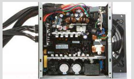
④ CS550M是本次参测产品中唯一一款在功率变换电路上采用LLC谐振半桥设计的产品。借助这种一般用在高端电源产品上才会使用的优秀设计，CS550M的转换效率表现非常出色。
