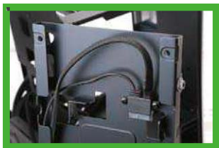
④ 拆下的光驱安装位底部，预留的一体式接口是经常在笔记本电脑上使用的薄型串口。
