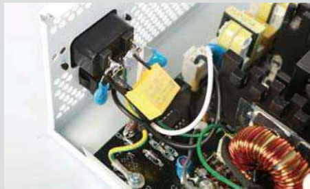
⑤ 一级EMI滤波电路的设计中规中矩
