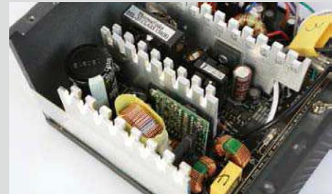
⑥ 主电容使用了一颗330 \mu F的产品，相当不错，但PFC线圈绕线直径有些偏小。
