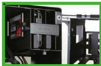
① 支持热插拔的硬盘仓，主要针对大体积的3.5英寸产品，当然也兼容2.5英寸小盘。围绕热插拔硬盘仓，901还为用户提供了两个便于拆卸的2.5英寸硬盘架，主要针对SSD产品。
