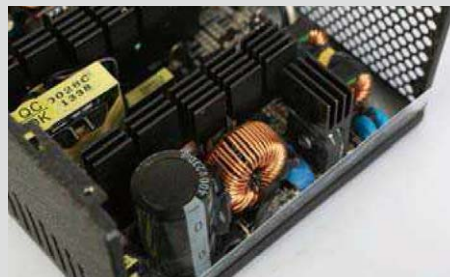
⑤ 主动式PFC+双管正激结构, 主电容采用了400V/270μF的元件, 足以满足500W的功率需求。
