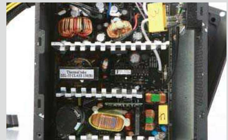
④ 内尽管没有特殊设计，但其内部电路还是比较整洁有序，双管正激+单路磁放大结构设计。
