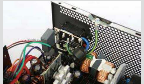
⑤ 一、二级EMI滤波电路的设计也非常用心，相比很多“裸奔”的电路，CS550M的设计让人看着都比较舒服。
