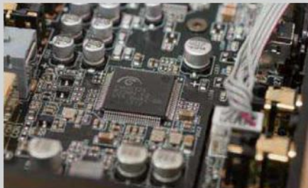
■ Cirrus Logic CS4398 DAC的性能不错,运用在华硕多款声卡产品中。
