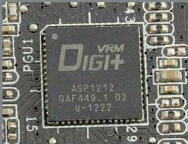
■ 华硕GTX 780 DC2 OC显卡上的PWM芯片被打磨为“VRM DIGI+ ASP1212”
