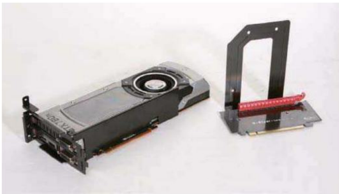
■ 通过显卡支架与显卡插槽转接支架的结合,即便是GeForce GTX 780 Ti这样的大型显卡也可轻松装入M8准系统内。
