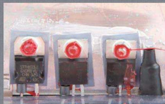
■ 引脚上加小磁环的MOSFET
