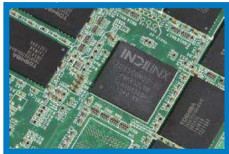
① 主控芯片加入了M00的后缀，或许这就是耐用度大幅度提升的关键。旁边的东芝19nm Toggle DDR2 2.0 MLC颗粒已经成为高端SSD的首选。
