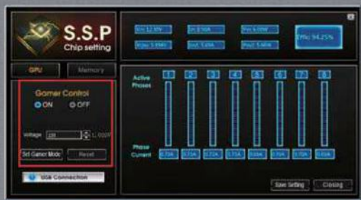
■ 使用FireStorm软件能够实时调节并监测GPU核心、显存电压
