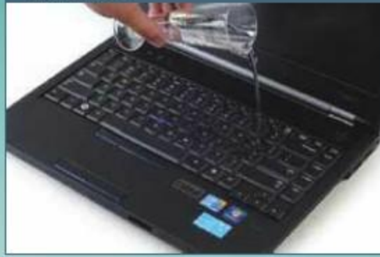
① 键盘空格键下方的排水孔
