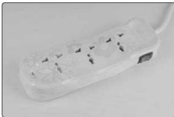
① 外壳经过高温烘烤,出现严重变形。
