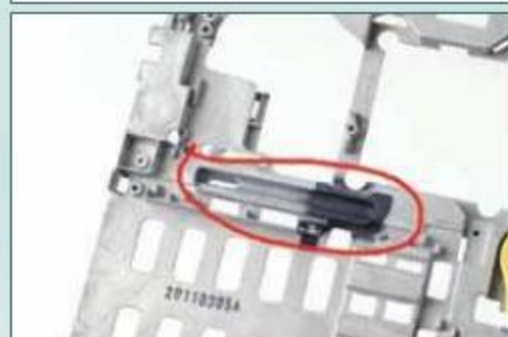
④ 防滚架左侧排水孔。孔径很大，还有专门的水槽设计。
