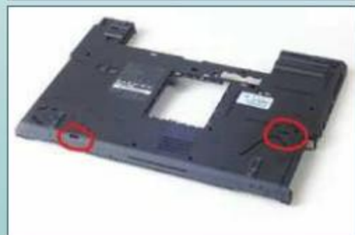
④ 机身底部的两个排水孔
