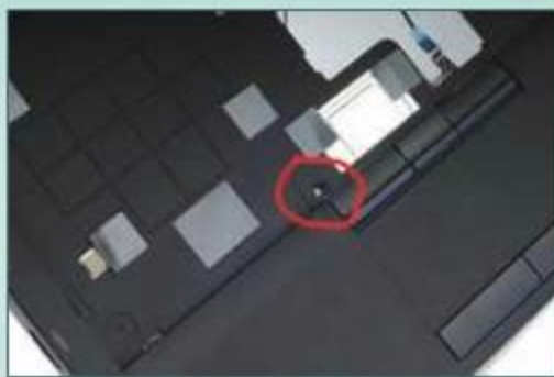
② C面外壳上的排水孔
