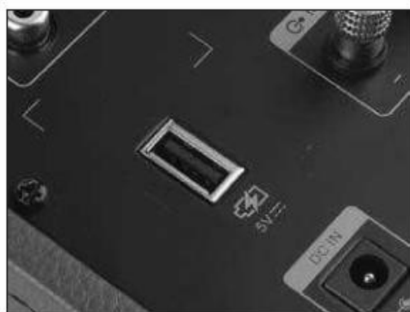
① 主箱背板上提供了USB充电接口,使之可满足各种手持播放设备的充电所需。用户使用不同设备时,也不会为了接口标准而纠结。
