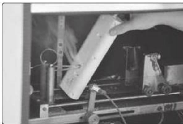
① 灼烧时, 没有出现明火燃烧现象。
