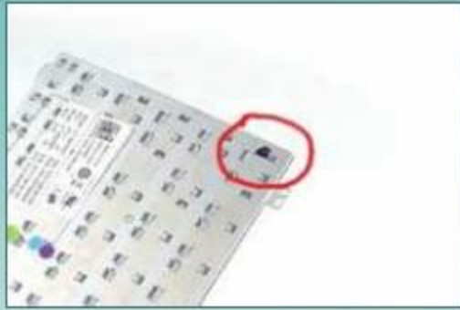
⊖ 位于Ctrl键下方的排水孔
