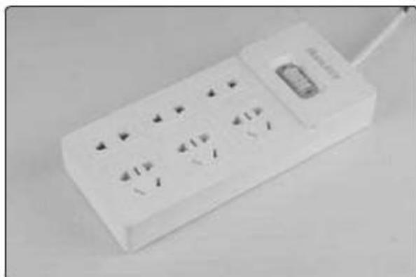
① 主体没有任何形变,电源灯翘起。
