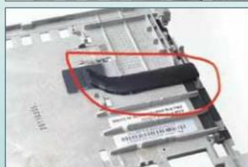
④ 防滚架右侧排水孔，通过导流槽将水引到机身之外。
