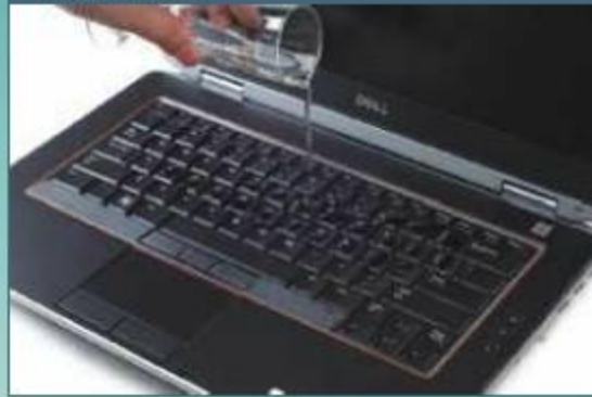
⊖ 位于Ctrl键下方的排水孔
