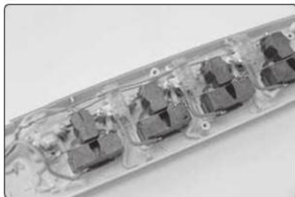
① 内部采用铜丝连接传导,做工并不令人满意。
