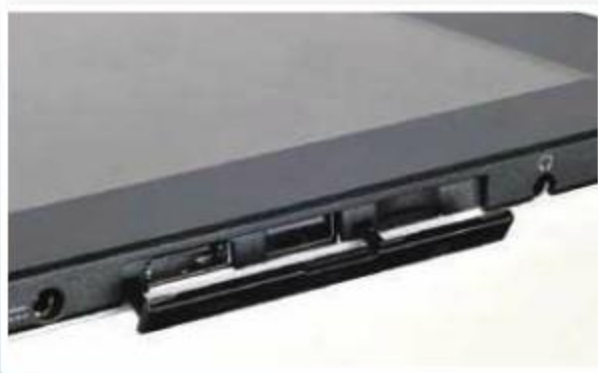
磁性保护罩覆盖下的扩展接口。对于家庭，标准HDMI接口更便于共用预埋的HDMI线输出视频；USB接口测试显示可支持鼠标、U盘等的接入，未来随着固件升级，支持的外设应该更多。
