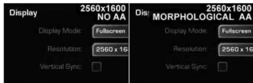
① 未开启MLAA时, 单词“Resolution”的字母“R”轮廓锐利。 ② 开启MLAA后, 单词“Resolution”的字母“R”轮廓模糊。
