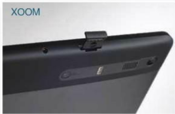
存储卡接口，A500是防丢设计的防尘罩，XOOM的防尘罩可以完全取出，比较容易丢。
