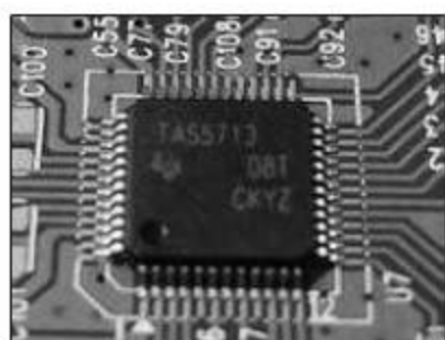
① TI的高品质D类功放模块,是雅皮士音质的保障。
