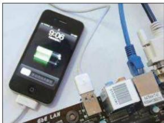
① 安装“CHARGER BOOSTER”后, 映泰TA75A+主板可对苹果移动设备进行快速充电。
