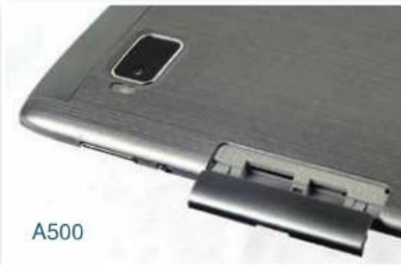
存储卡接口，A500是防丢设计的防尘罩，XOOM的防尘罩可以完全取出，比较容易丢。
