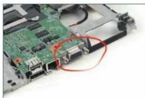
④ 主板VGA接口的螺丝位其实是很隐蔽的螺丝。
