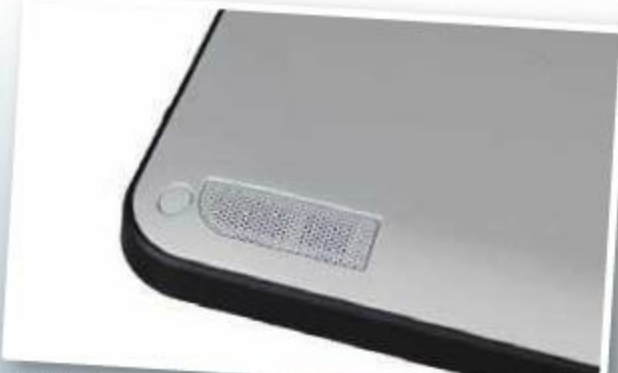
T10的扬声器布局试图获得最佳立体声展现，两枚扬声器分居机身背部左、右下角，并覆盖有金属网罩，实际效果也比较出色，可能出于音质保真度的要求，音量并不大。
