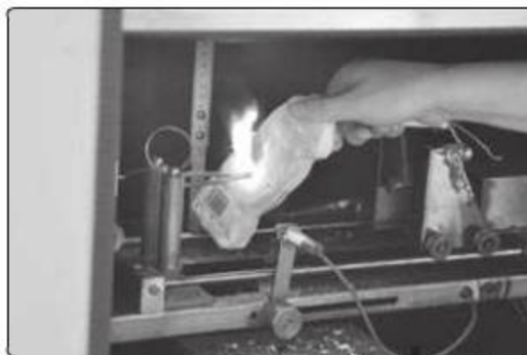
① 外壳燃烧, 阻燃能力较差。
