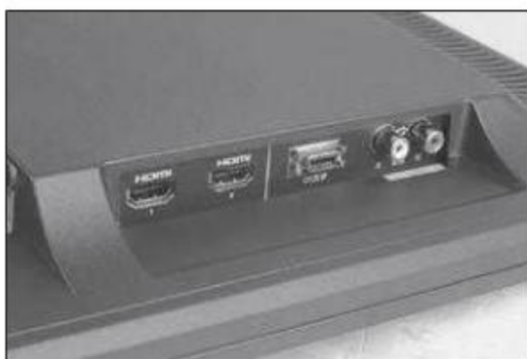
① 三菱MDL231CV的接口比较丰富，用户可能经常使用的HDMI接口放置在机身左侧方便插拔。
