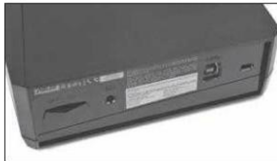
① 开关和接口被设计在了刻录机的背部
