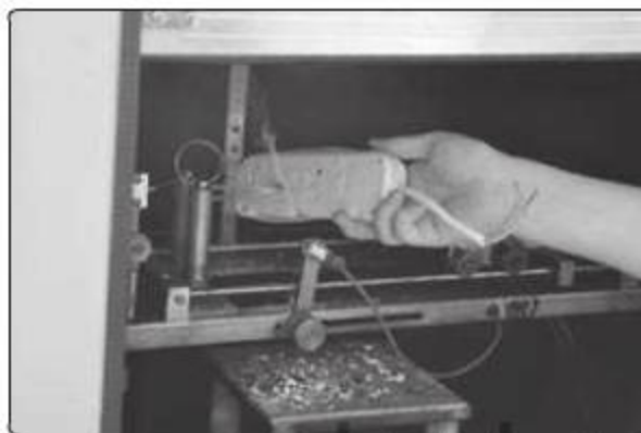
① 阻燃能力较强,没有产生明火。
