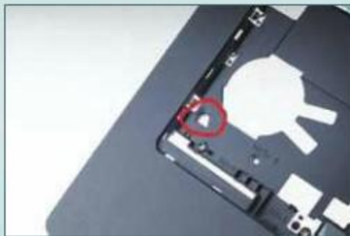
⊖ 位于C面键盘下方的排水孔
