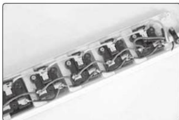
① 内部采用电线连接, 用料一般。
