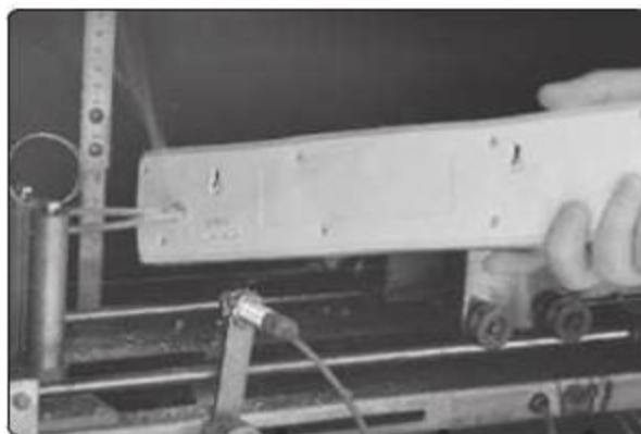
③ 这款排插的阻燃能力良好, 材质没有燃烧。
