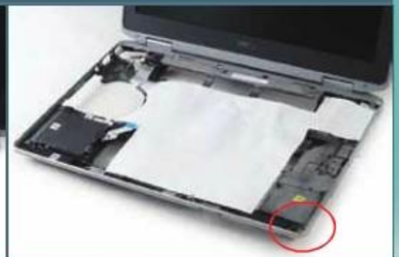
⊕ 右侧略微垫高之后,倒入100ml水时也仅有少量水在左面洒出。
