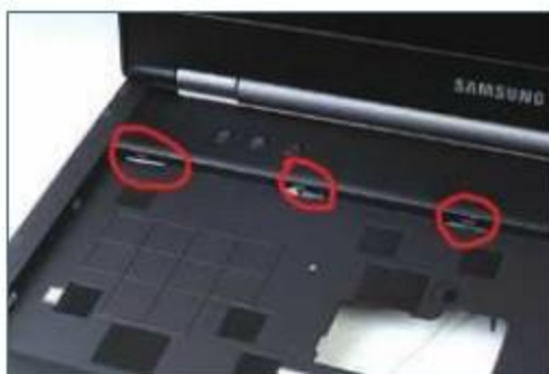
① 打开键盘边框上的卡扣才能取下键盘,此时需要借助称手的工具才行。
