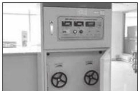
① 用DMS-D03单相电源负载柜进行满载测试
