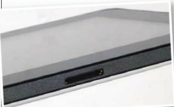
T10机身底部仅提供类似连接扩展坞的专用数据接口，而12V的充电数据表明，该机只能通过标配适配器连接电源口充电。
