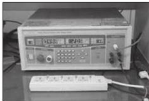
① 用Zentech 9032A综合测试仪测试排插的绝缘阻抗
