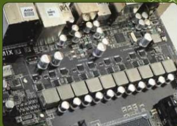
③ 10颗合金电感组成的供电模块，所能承载的额定电流更大，动力更为强劲。
