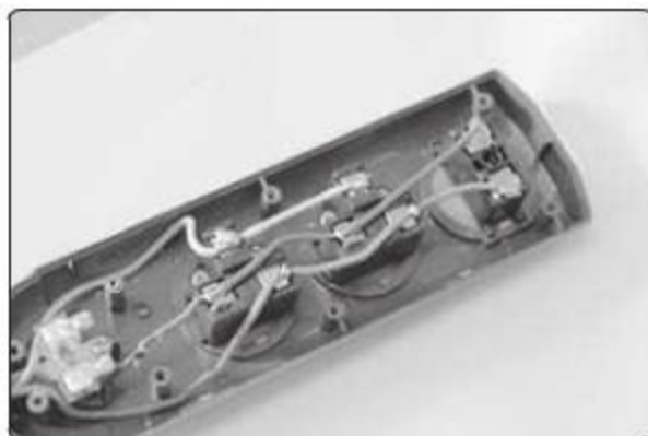
❶ CP-G3220内部采用电线连接
