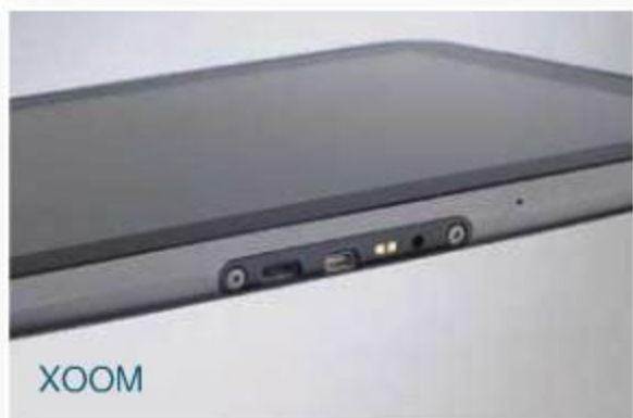
A500的接口分布相对比较分散，机身右侧就是标准的USB接口，我们期望这个接口能够发挥更大的效用。XOOM的接口就比较集中了，microUSB、HDMI都位于机身下部。
