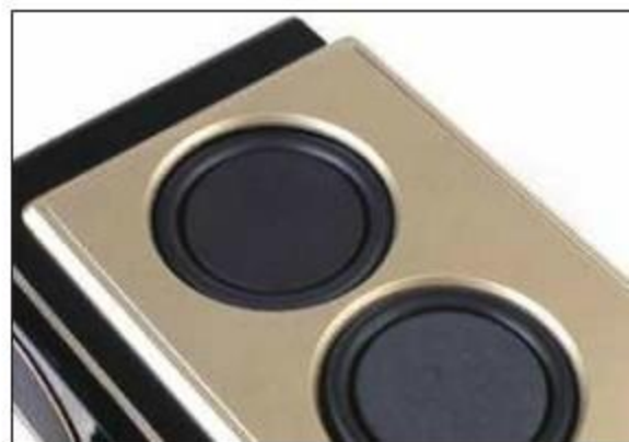
① 被动辐射器中间部分采用了纤维材质，边缘则是软质塑料。
