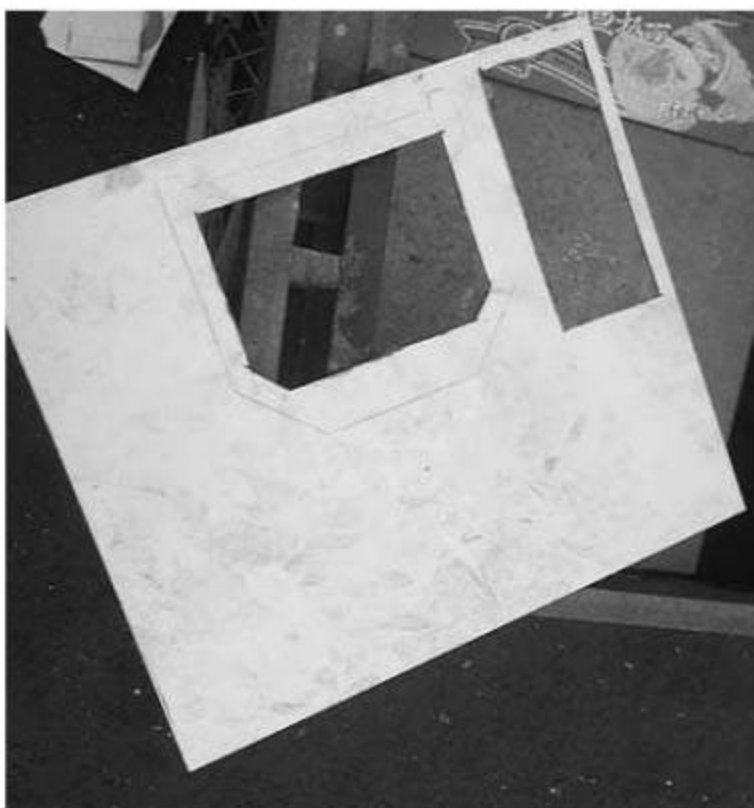
② 用电动磨打磨出来的通风口
