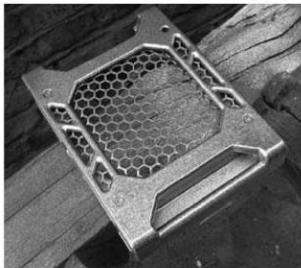
④ 对散热罩喷漆打底
