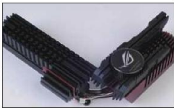
① 两款主板的散热设计都比较抢眼，但X58 Classified 4-Way SLI（左）的散热器更给力：散热鳍片更多，且在北桥使用了一个风扇辅助散热。
