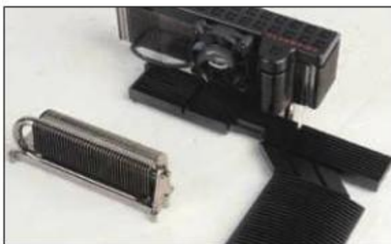
① 两款主板的散热设计都比较抢眼，但X58 Classified 4-Way SLI（左）的散热器更给力：散热鳍片更多，且在北桥使用了一个风扇辅助散热。
