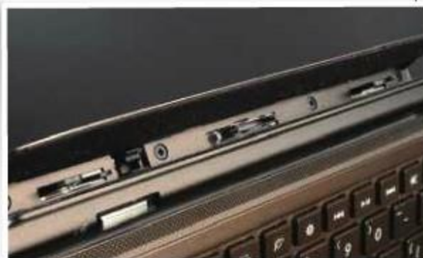
键盘底座的连接部位，两个卡扣可以牢固地固定机身，两侧的绒布也能够保护机身不被擦挂，人性化的设计很贴心。
