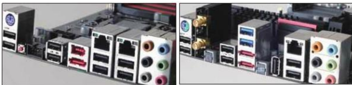
① 从I/O背板来看，Rampage III Black Edition（右）的接口明显比X58 Classified 4-Way SLI（左）更丰富和全面，甚至前者还具备了两个无线网络天线接口（主板集成了一个无线通信模块，通信模块由一块802.11b/g/n无线网卡和一个符合蓝牙V3.0规格的板载蓝牙模块组成）。不过，X58 Classified 4-Way SLI主板提供了一个红外设备接口，可方便用户为PC搭配红外遥控器，让电脑变成高清播放器。
