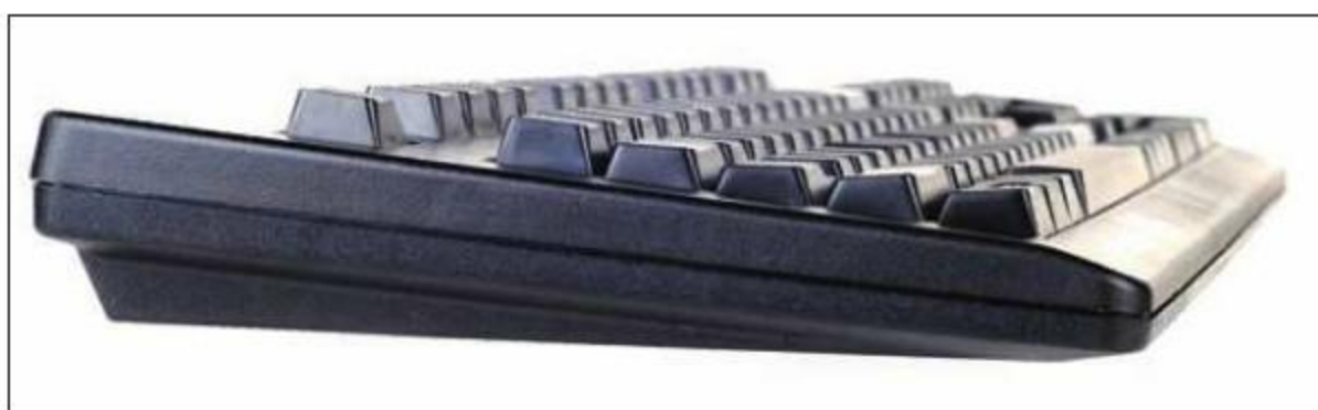
① 键盘的按键呈梯级排列, 符合人体工学原理, 键入感舒适。
