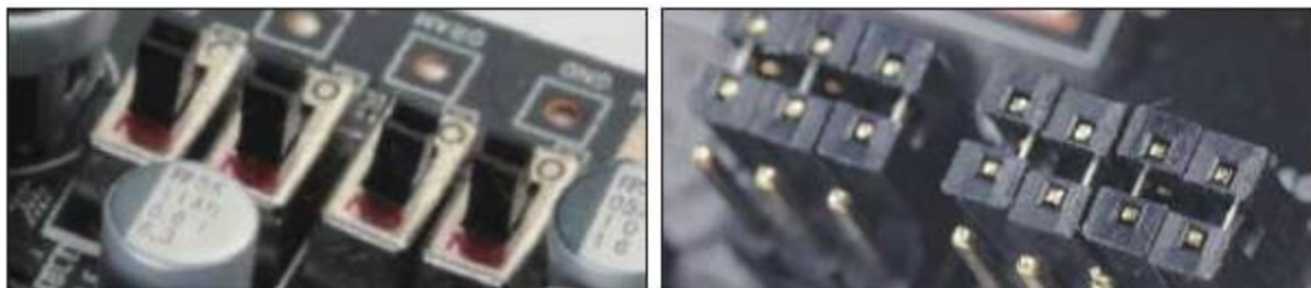
① 两款主板都提供了用于开启和关闭PCI-E插槽的控制开关，当你组建显卡互连系统，并发现故障时，可以通过控制开关来判断是哪块显卡出现了问题。不过相比Rampage III Black Edition（左）使用的拨动开关，X58 Classified 4-Way SLI（右）却使用的是跳线设计，略显不便。
