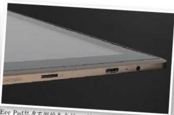
Eee Pad机身右侧的各个接口，HDMI是最有趣的，连接大屏幕显示设备玩游戏？
