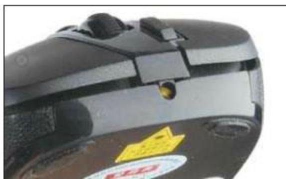
① 请勿将眼睛正视鼠标前端的激光光束口
