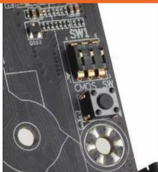
② PWM频率调节开关和清空CMOS按钮
