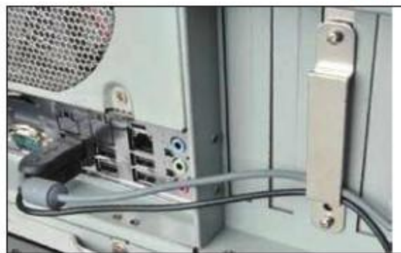
① 安装配线锁后，可有效降低耳机、键盘、鼠标等配件被盗的可能性。
