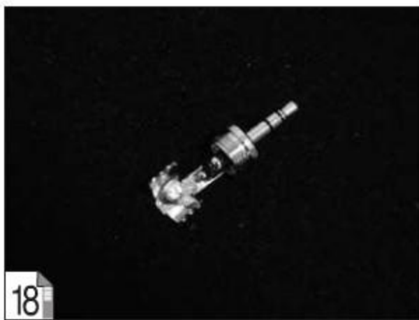
① 在3.5mm音频插头上点适量的焊锡
