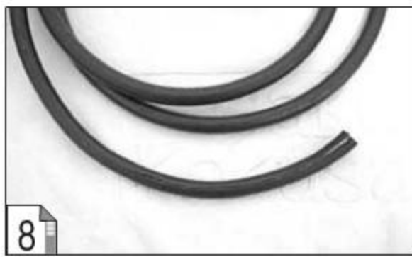
⑧ 美工刀顺着线材由记号处直线切割到线材的顶端
