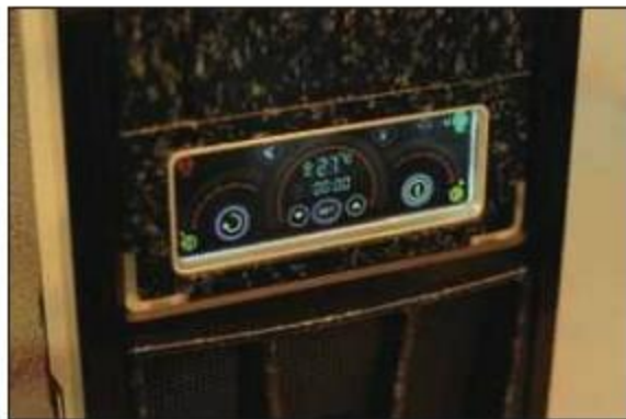
① 触摸屏可以实现温度监控、关机、重启、锁屏(防止误操作)等多种功能。
