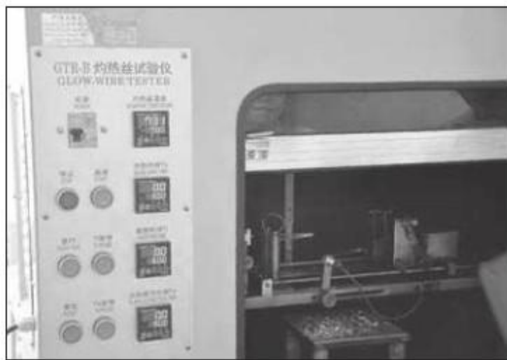
①我们将灼烧测试仪的探头温度升至700℃和750℃，考验键盘的防火能力。
