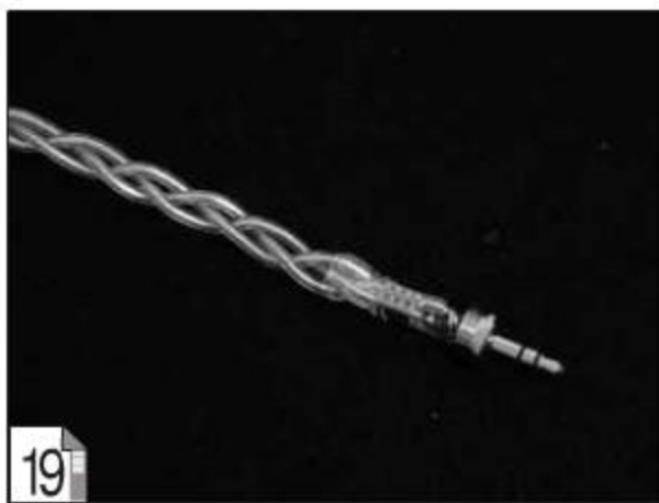
① 将插头与线材焊接完成后的状态
