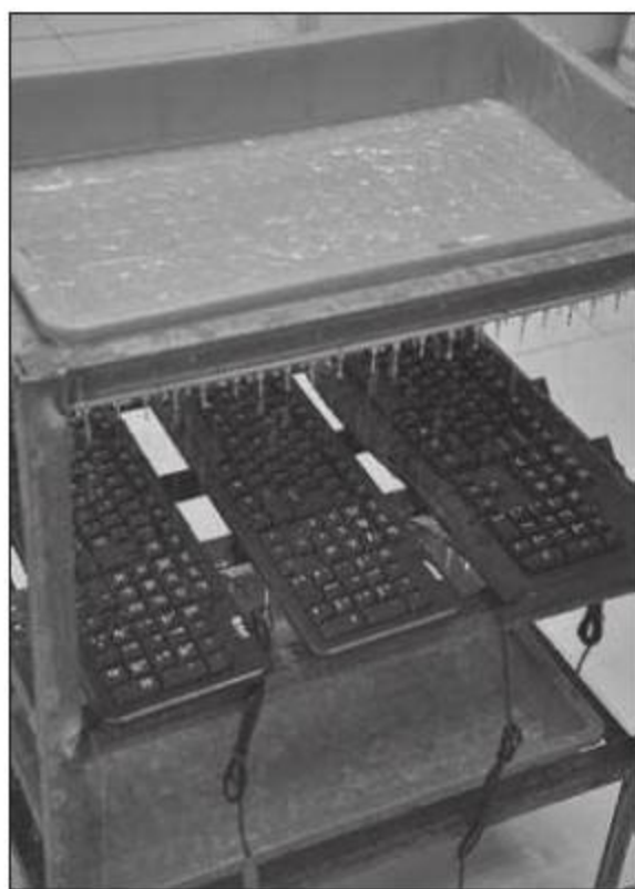
①为防水测试定制的三层钢架，可对键盘形成水流冲击。
