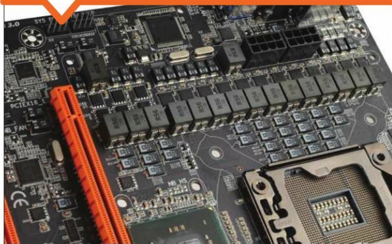
① 亚铁盐芯电感+大面积钽电容配置
