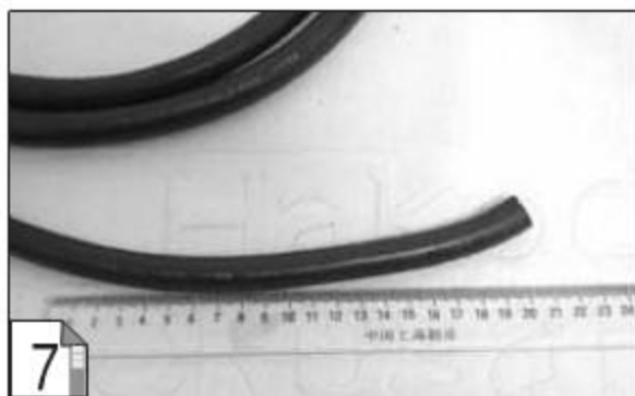
⑦ 用直尺量取适当长度的线材
