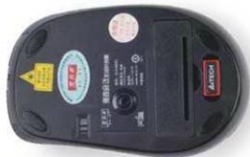
① 采用针光引擎的产品，底部光孔都改为了针孔。
