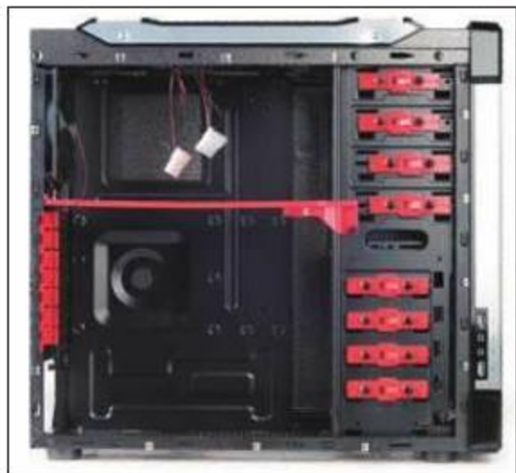
① 阿尔萨斯太阳圣塔机箱配备了全免螺丝设计，并采用了多处防尘处理。
