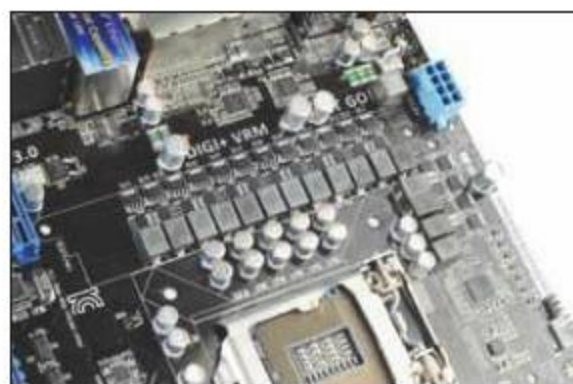
② 处理器供电部分采用16相数字供电
