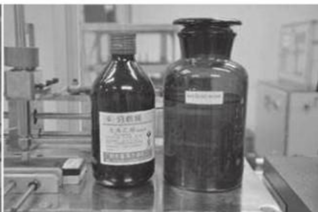
① 耐磨测试用到的纯酒精和汗液, 都具有相当强的腐蚀性。
