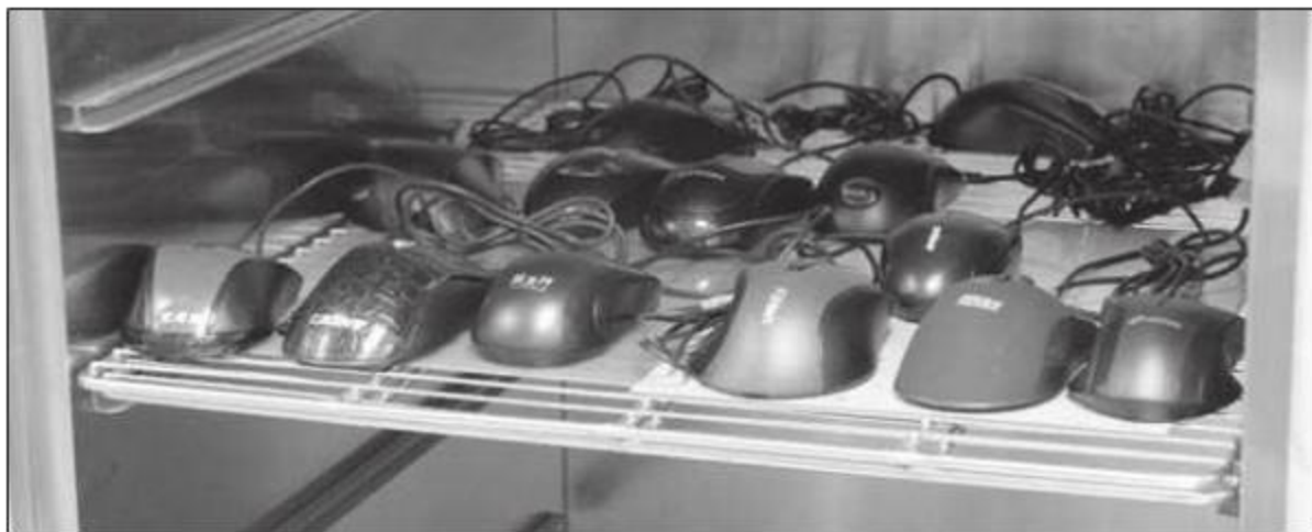
①我们将鼠标放置到100℃的高温烤箱中进行耐高温测试
