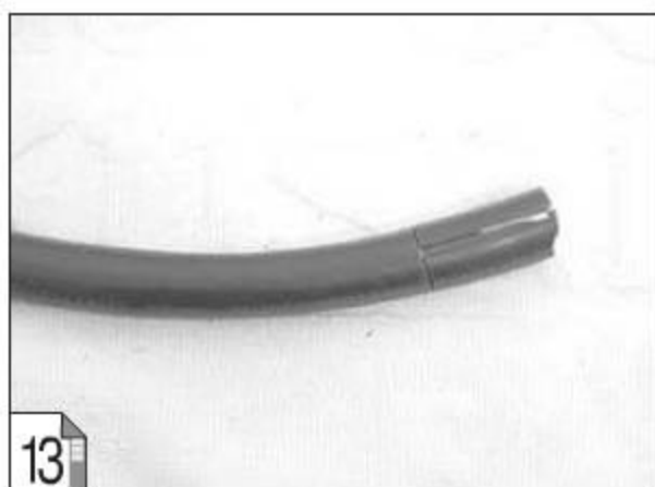
⑬ 用美工刀顺着线材由记号处直线切割到线材的顶端
