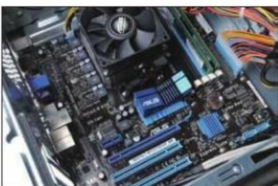
① 采用的M4A78LT主板提供了4根内存插槽和1根PCI-E x16插槽
