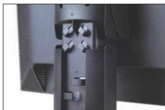
① 底座后部可以收纳电源线和信号线
