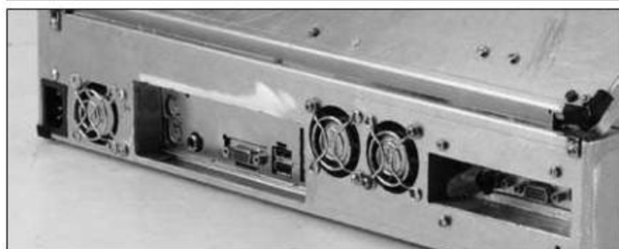
① PC两侧设计了散热孔用于进风,在PC背部设计了两个风扇用于排风。
