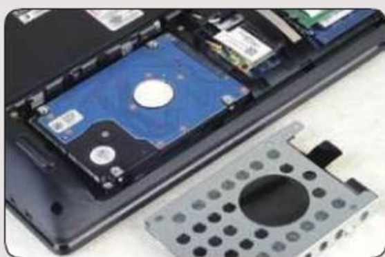
② 直接向后推拉硬盘，即可卸下。
