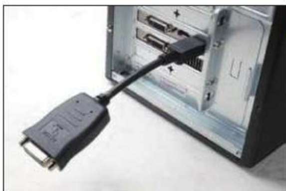
④ 华硕CG1330三联屏电脑的安装必须使用DP-DVI转接线
