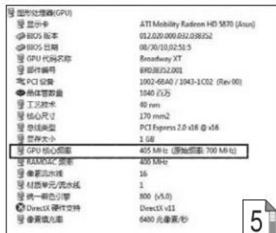
① 刷新VBIOS之后，待机时的显卡核心频率会自动降频至405MHz。
