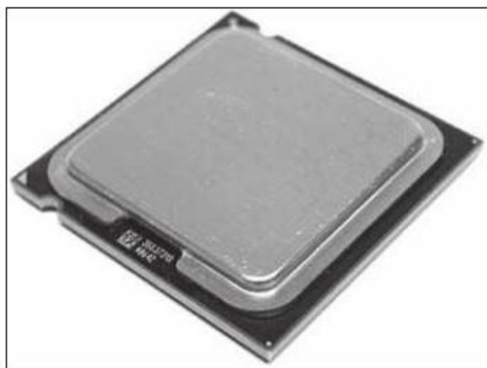
图3 65nm制程的第二代应变硅技术应用实例——Pentium EE 955
