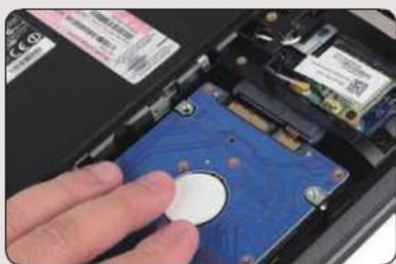
③ 将新硬盘对准插口，直接推进去即可。
