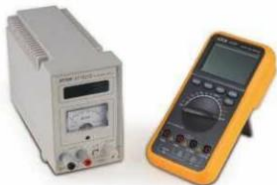
此次测试所采用的功耗测试仪器,直流电源+万用表。
