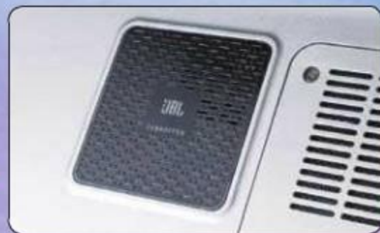
① 除了C面两侧的JBL扬声器,它的底部还有一个低音单元。
