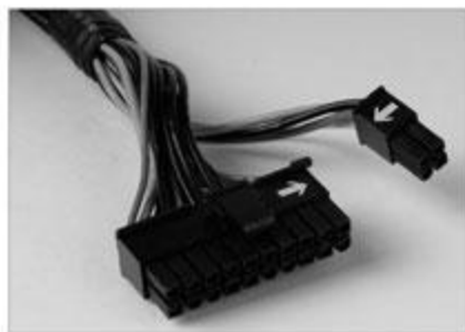
② 20Pin+4Pin的主板电源接口
