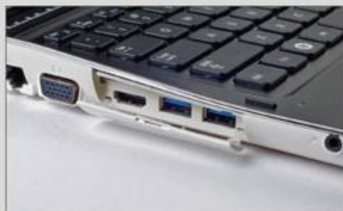
① 机身左侧挡板之下隐藏着两个USB 3.0接口，这是数据高速传输的保证。
