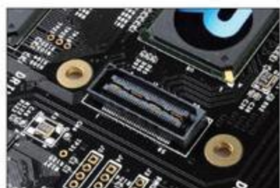
① 主PCB上有两块硬盘，另外两块固态硬盘则集成在子PCB上，并通过一个特殊的数据接口进行连接。
