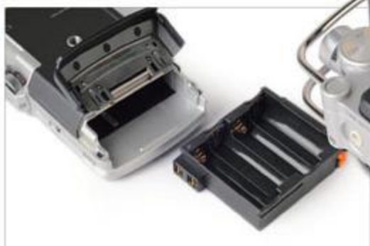
② PCM-D50通过4节AA电池供电,电池仓内还设计了专用的电池盒,结合更紧密。
