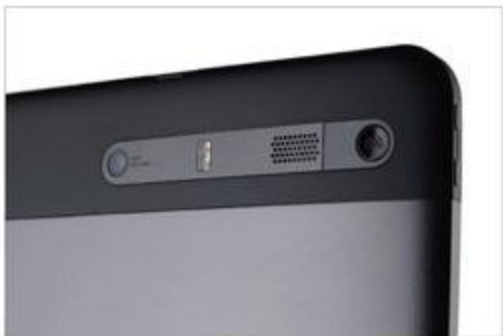
右边圆键是电源键与锁屏键,恰好是双手握持时左手食指所在的地方,非常顺手。左侧则是500万像素摄像头,旁边是双LED补光灯。
