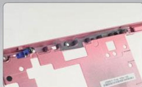
② 镁铝合金的机身骨架, 边缘的凹槽是走线的地方, 非常精细。
