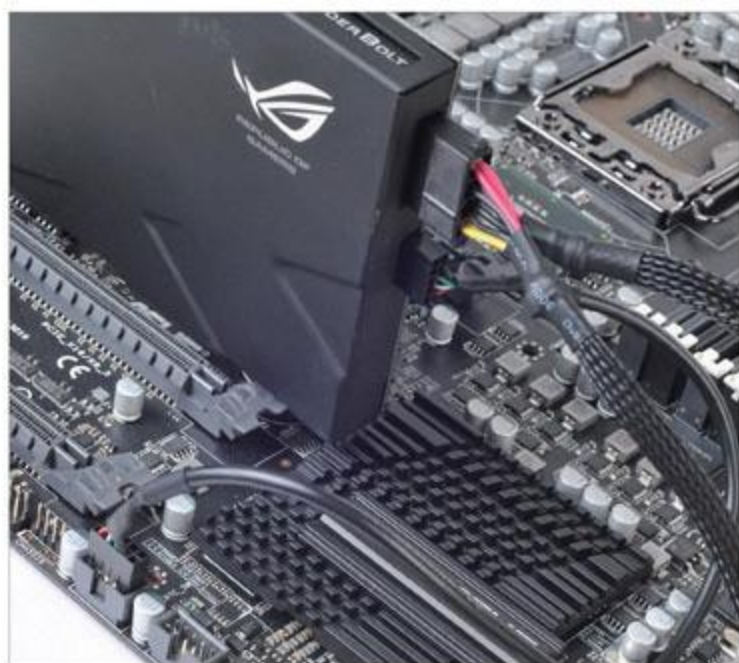
④ 使用Thunderbolt子卡时,必须连接额外的4-pin辅助供电,以及USB 2.0连接线后才能正常工作。
