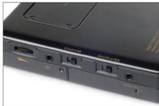
① 机身侧面拥有两组按键,可以切换机器的状态(解码器/播放器)和输入方式(USB/同轴)。
