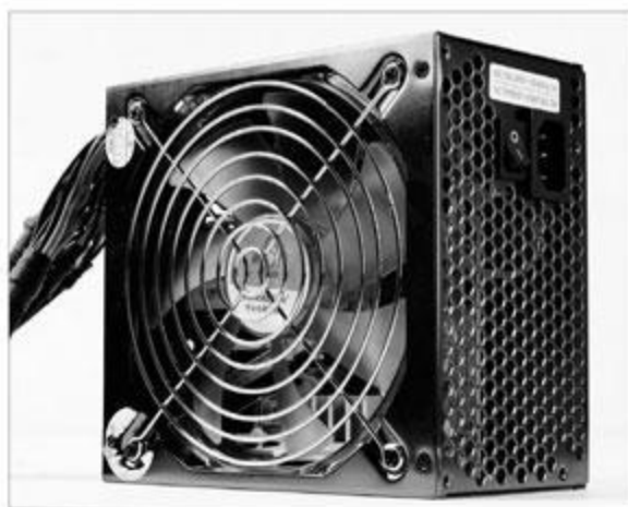
① 电源是整个系统的能源基石，负责将220V的高压交流电转换为可以给电脑各配件使用的低压直流电。
