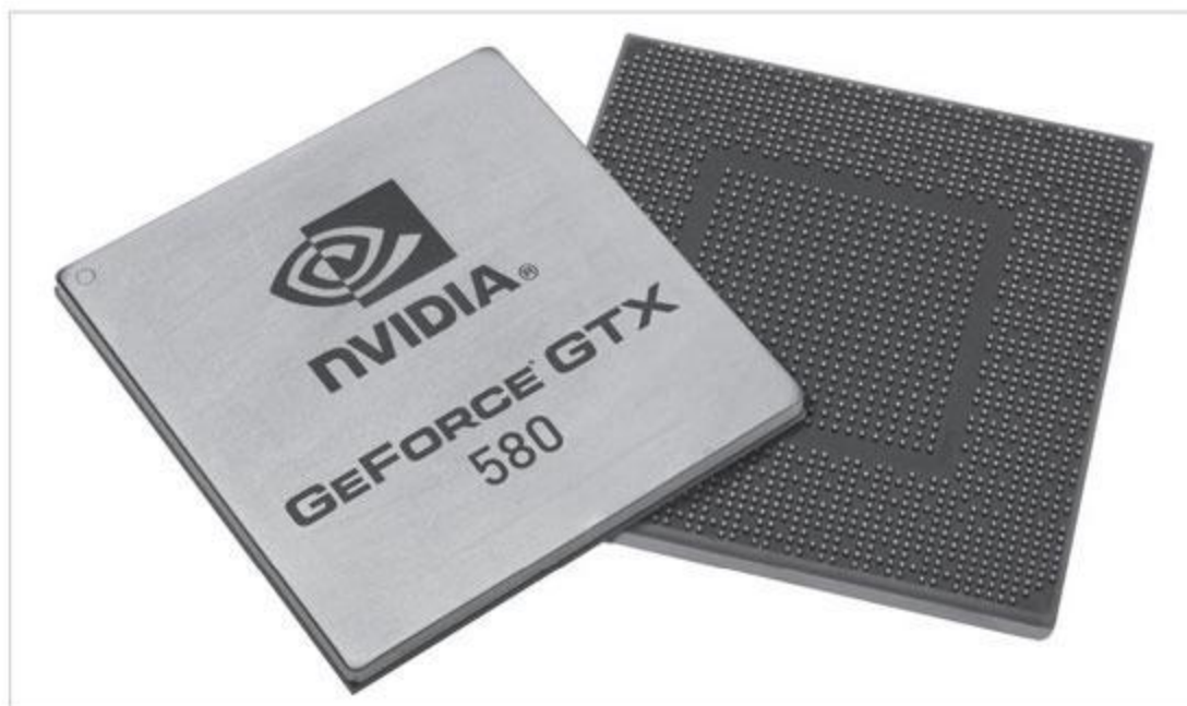
① 目前的GPU往往有上千个引脚,这给生产和制造带来了困难,同时这类高端GPU本身的封装费用也居高不下。
