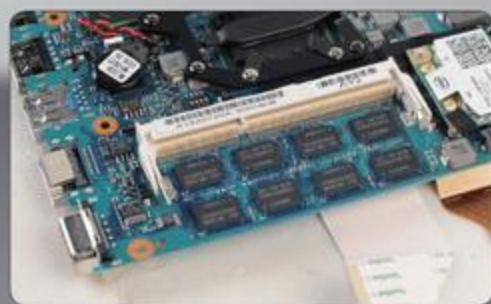
集成程度很高的主板,内存颗粒被板载在主板上,以节省空间,但依然提供了一个内存插槽以供自行扩展。
