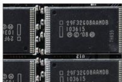
① 采用34nm工艺制造、单颗容量为4GB的Intel MLC NAND闪存芯片。
