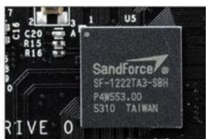
① 已在多款固态硬盘上使用的SandForce SF-1222主控芯片，不过其技术规格在当今只属主流水准。
