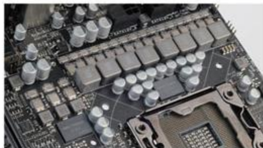
⑤ 除了丰富的功能,该主板依然延续了玩家国度主板做工优秀的特色,采用由NEC Proadlizer高速薄膜式去耦电容、DirectFET MOSFET等高品质元件组成的8相处理器数字供电设计。
