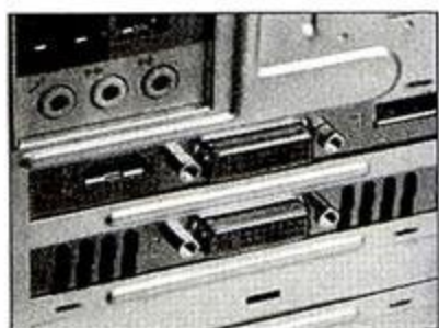
① 标配的GeForce GTX 460显卡提供了双DVI+HDMI+DP的接口配置,可实现多屏幕扩展。
