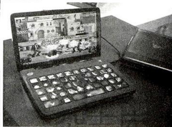
Razer推出的Switchblade是一款非常好玩的游戏机,它的键盘是由可以编程的LED屏幕组成。键盘可以根据游戏的需要显示相应的按键图标。当然,它也是一款凌动平台的产品。
