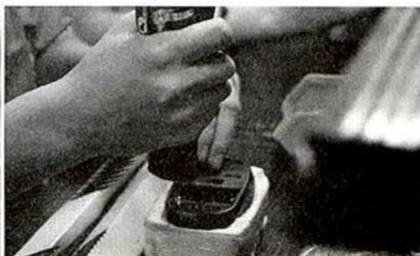
6 组装平台：与其他工厂不同，智迪科技的8人制安装小组显得比较特别，他们按照“单人制装配”进行工作，由第一个作业员负责整只鼠标的装配，接下来的作业员负责安装螺丝和脚垫，随后的负责功能检测装箱等工作，而且在安装线上采取了“人人都是品管员”的QC模式，每一道工序的作业员都要负责品质管控，直到最终产品成型，这种方式带来的好处是让产品的直通率达到98%。而传统的传送带装配则是将底壳放在流水线上，每个作业员负责一个部分的安装，安装完成之后才会有专门的品管员来把关，这种方式不利于先期发现问题并作及时处理，同时生产效率也会降低。
