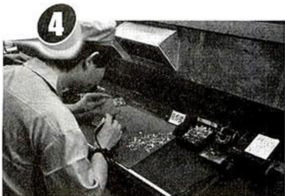
4 补焊：作业员会检查焊接后的电路板，如发现 有漏焊和虚焊的部位，会及时予以补焊。
