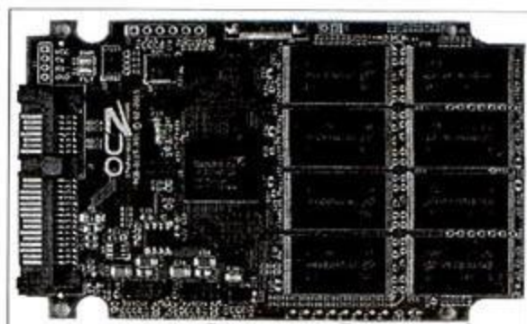
新一代主控芯片与25nm闪存芯片为固态硬盘带来了更好的性能
