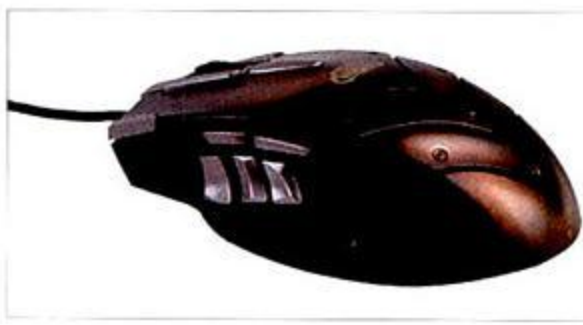
① 鼠标左侧的侧键已由上一代的棱形四角键改为一排三键设计，但依旧不算好用。
