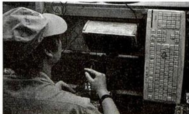
5 功能预测：经过补焊环节之后的电路板会进行功能预测(左图检测鼠标电路板、右图检测键盘电路板)，功能合格的才能进入下一个步骤，不良品会被直接退回。
