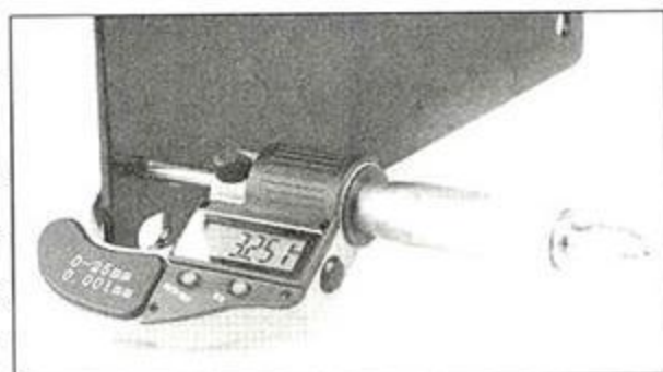
① 评测工程师用高精度电子游标卡尺测得该钢板的厚度为3.251mm
