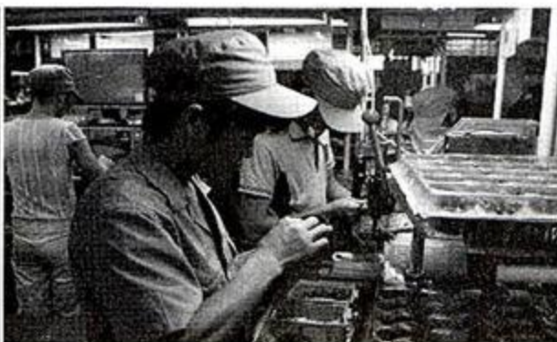
6 组装平台：与其他工厂不同，智迪科技的8人制安装小组显得比较特别，他们按照“单人制装配”进行工作，由第一个作业员负责整只鼠标的装配，接下来的作业员负责安装螺丝和脚垫，随后的负责功能检测装箱等工作，而且在安装线上采取了“人人都是品管员”的QC模式，每一道工序的作业员都要负责品质管控，直到最终产品成型，这种方式带来的好处是让产品的直通率达到98%。而传统的传送带装配则是将底壳放在流水线上，每个作业员负责一个部分的安装，安装完成之后才会有专门的品管员来把关，这种方式不利于先期发现问题并作及时处理，同时生产效率也会降低。
