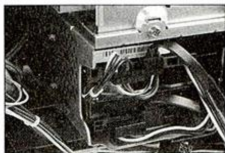
① 我们拿到的测试样机采用了双硬盘的配置,可以根据需要切换阵列模式,而市售机型标配的是一块硬盘。
