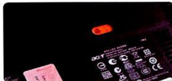
① Aspire 4750G的电池开关很独特，需要动用圆珠笔之类的工具才能取下电池，有点麻烦，但至少可以起到一些电池防盗的作用。
