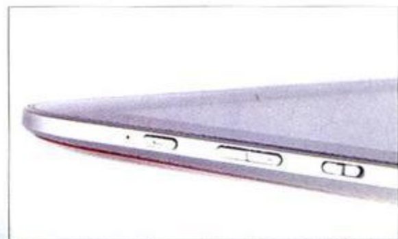
顶部除了音量调节与电源键之外,还有两个非常实用的设计:独立的屏幕旋转锁定键,这在阅读电子书和观看视频时是非常有用的;麦克风,有了麦克风,很多应用才有实现的可能(比如会说话的汤姆猫、语音识别等等)。
