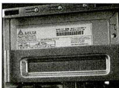
① 标配了500W额定功率的台达电源,留下了充分的超频、升级功率空间。
