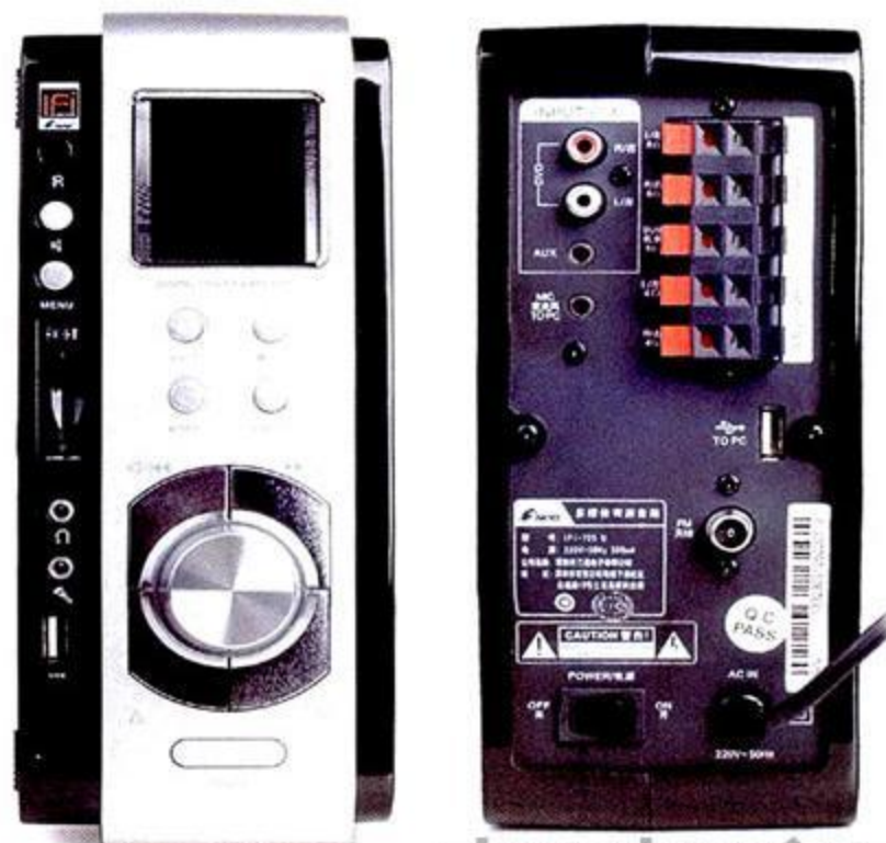
② 电源开关设计在功放背部, 音频输出孔全都采用了蝴蝶夹。
