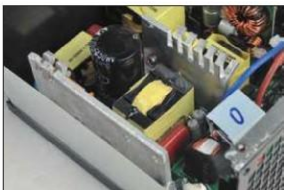
① 一次侧采用的是LLC谐振半桥，这种结构适合于中低功率电源提升效率。
