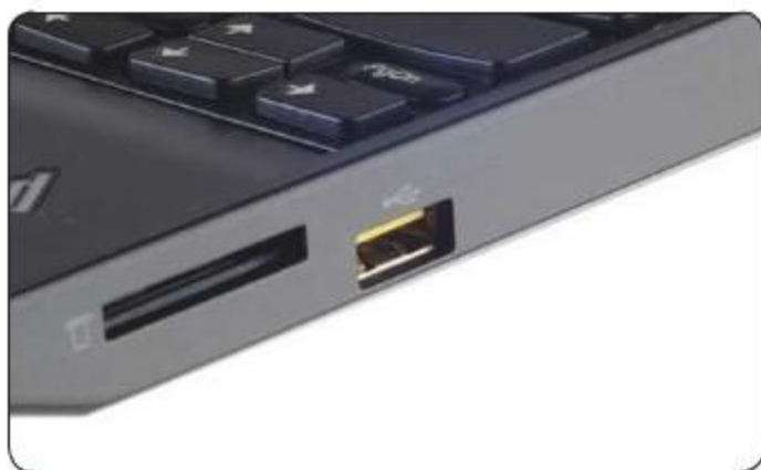
① 机身右侧的黄色USB接口具有关机充电功能
