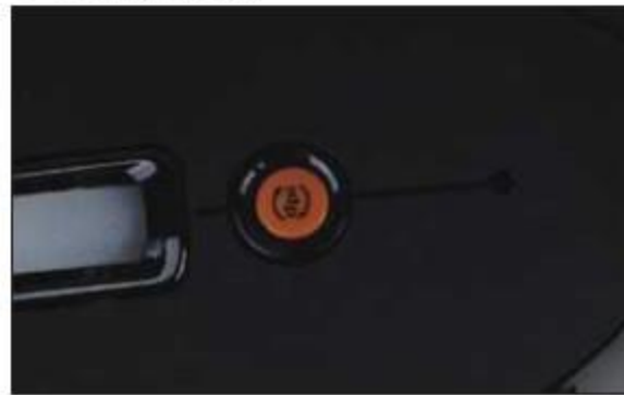
迅雷101顶部设置了DPI切换键,支持三个挡位的分辨率切换。
