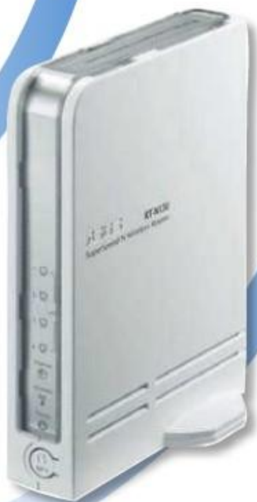
① 在下一代802.11标准诞生之前,802.11n无线路由器仍然是无线局域网的最佳选择。华硕RT-N13U最高理论传输速度为300Mb/s,支持3G上网、关机下载、无线打印等功能,家庭用户和办公用户都适用。
