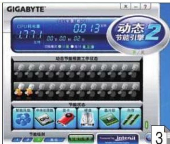
③ 打开“智能供电”功能后, 在轻载状态下, 主板将关闭其中22相供电电路。
