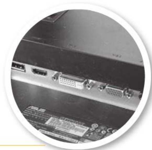
① PA 246 Q 提供了包括 DisplayPort 接口和 HDMI 接口在内的丰富视频输入接口
