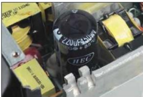
① 测试样品的主电容是一颗HEC 220µF(450V/85°C)，航嘉表示这是日本供应商缺货所致，正式产品应该会使用红宝石电容5。
