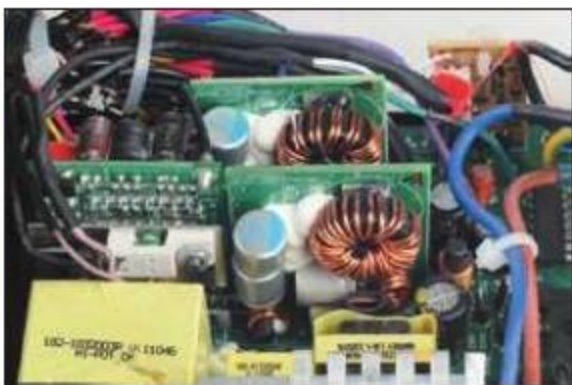
① +12V同步整流电路(左侧电路板)和+5V、+3.3V DC-DC电路(右侧两块电路板)也是目前高效率电源采用的主流技术。
