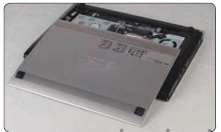
① ICONIA底部挡板可以移开,方便维护硬件,电池也可以单独取下来。
