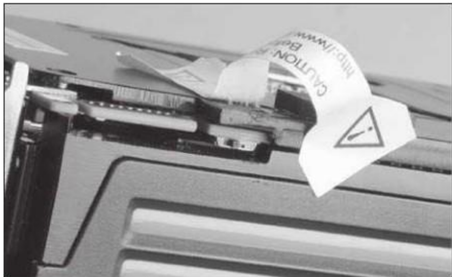
① 位于Radeon HD 6990显卡交火金手指附近的BIOS开关和贴纸
