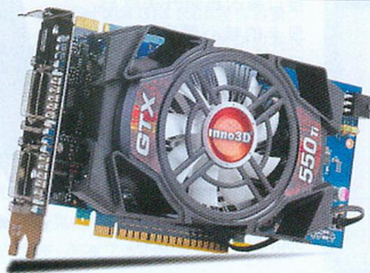
这样的设计也基本能满足日常的使用。它的核心频率和显存频率分别为920MHz和2050MHz，与公版频率接近，因此，它的各项测试成绩也与公版 GeForce GTX 550Ti显卡相当，其中，3DMark 11的得分为P2430。不过，映众GTX 550Ti游戏至尊版显卡显卡的性价比还算不错，而且，在近期购买这块显卡的玩家还可获得《星际争霸II》的点卡，感兴趣的朋友可一定不能错过。
