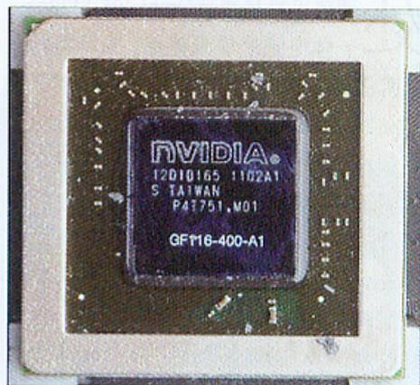
① GeForce GTX 550Ti显卡的显示核心
