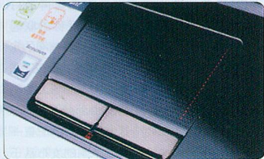
② 触摸板表面的凸点设计有助于提高舒适度
