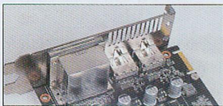
① 接口经过了屏蔽处理，安装了EMI金属防磁屏蔽罩，抗干扰能力更强。
