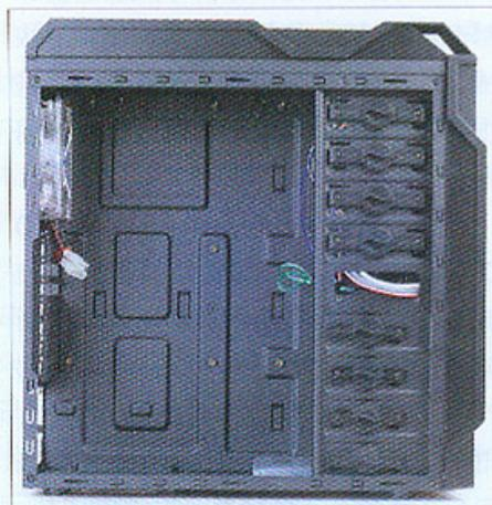
① 超频三雷暴3000豪华版机箱的内部结构,其扩展槽空间刚好可以放入GeForce GTX 580显卡,不支持背板走线。
