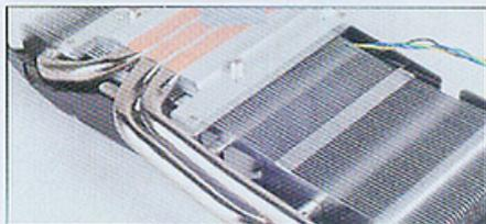
② 使用经过镀膜处理的3热管+大面积散热鳍片的散热器，颇具卖相。
