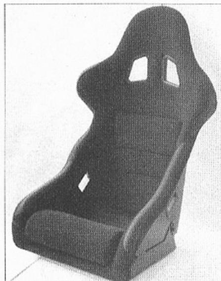
①图4 这款竞技椅的坐垫相当厚, 表面采用了皮质材料, 内部为高密度的海绵, 坐感舒适, 对臀部骨骼的压迫非常轻微。
