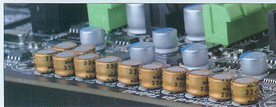
① 尼吉康MW系列音频电容具备在高温下，长时间连续工作的特性。
