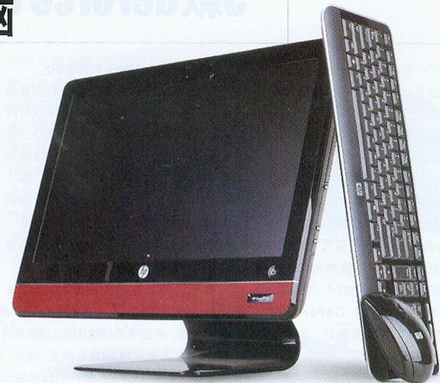
游戏来说，Omni 105-5138cx是没问题的。在散热方面，由于采用了垂直立体散热体系，在室温20摄氏度时，它的顶部出风口温度为40摄氏度，手感只是温热而已，噪音也非常微弱，不贴近机器几乎不可察觉。
