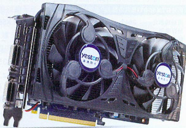
散热性能是评价一块显卡的重要指标,盈通GTX560Ti-1024GD5游戏高手显卡采用的是超频三的散热方案,整个散热部分看上去异常强劲。硕大的散热片中穿插着5根6mm热管,两个风扇的直径均达到了10cm,这样的设计在一般显卡中非常少见。在待机情况下,盈通GTX560Ti-1024GD5游戏高手显卡的温度仅为25°C,不过,由于默认频率较高,显卡在满载条件下,温度达到了80°C。
