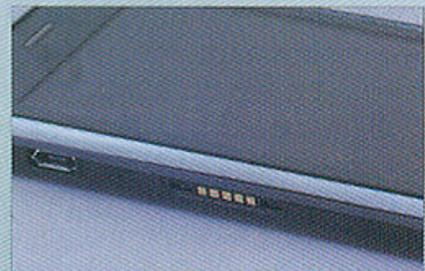
车载接口，很贴心的设计，也再次申明了A10的着力点——导航。把这个车载槽连接之后，A10会自动切换到导航模式，很贴心吧！
