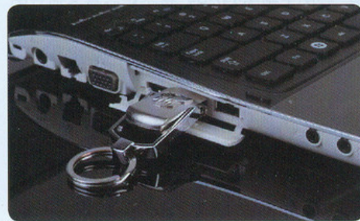
④ 挡板下方的接口位置过于紧密, 不适合体积偏大的USB设备。
