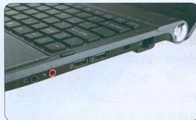
④ 机身右侧音频接口靠近机身前端, 两个USB接口之间的间隔不算太充分。转轴处则是VAIO经典的圆形电源键。
