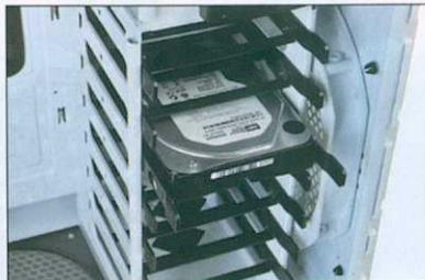
① 硬盘位的抽屉式托架材质偏软, 可安装3.5英寸和2.5英寸硬盘, 装好之后的稳固性尚可。
