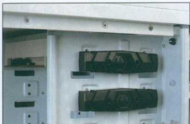
① 光驱位免螺丝扣具采用按压方式设计, 装上光驱后锁扣变得很紧, 导致拆卸时有些费力。
