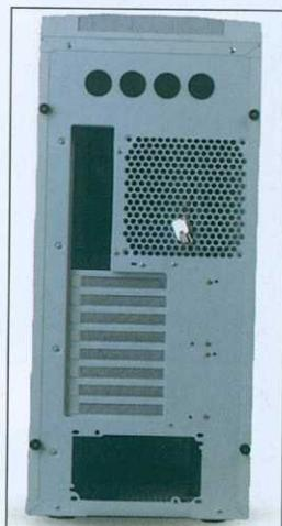
① 提供四个水冷孔, 最多可安装两套水冷设备。
