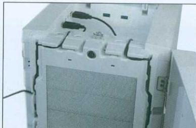
① USB鼠标、USB键盘绕线在机箱上, 锁上置物盒的盖子就能防盗。需要注意的是USB线缆的直径不要超过1mm, 否则装不进去。
