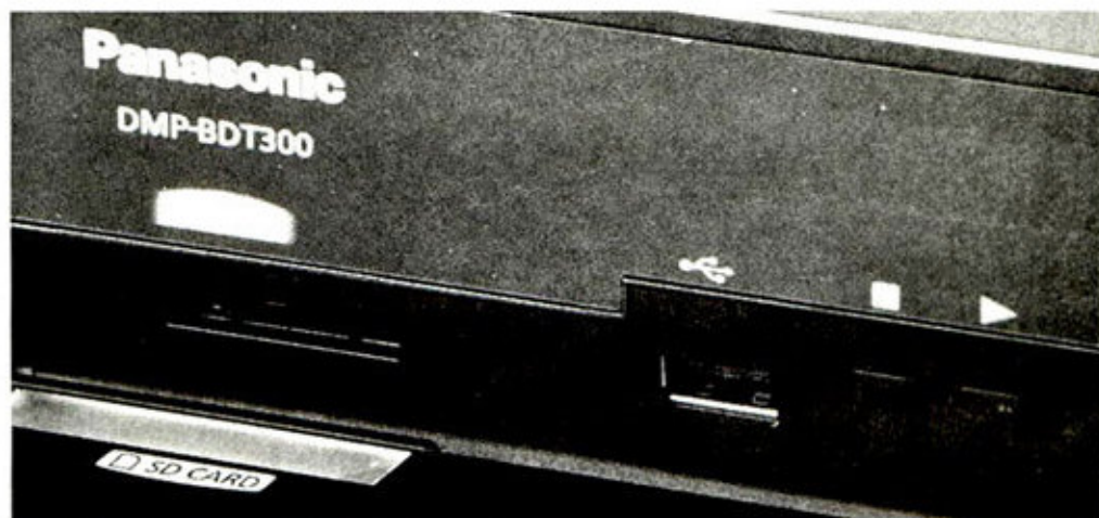
① 内置的SD卡插槽和USB接口便于读取其它存储介质上的媒体文件
