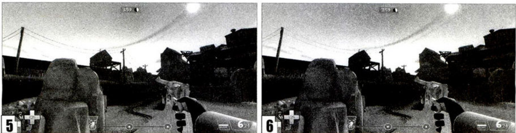
③ 接下来仍然是利用MLAA软件进行的画面测试对比。图5是没有启用任何抗锯齿效果的场景图,因此在电线杆、电线上以及各种物体边缘处的锯齿都比较明显。图6是启用了MLAA抗锯齿技术的图片,可以看到整幅图中锯齿大大减少,效果相当明显。但问题是,文字也被一定程度“抗锯齿”了,导致文字锐利度下降。
