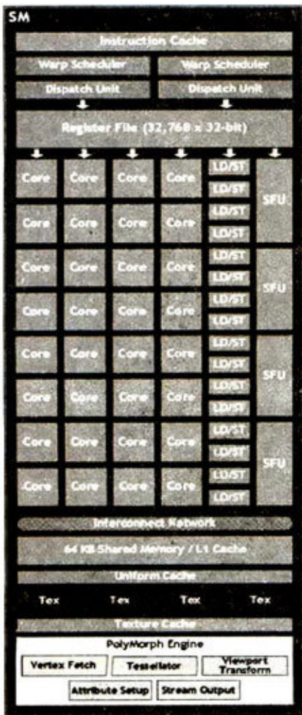
⑤ 和GF100一样, GF110的一组SM阵列由32个流处理器组成。
