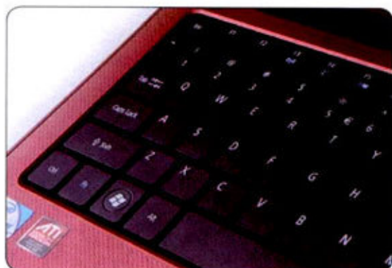
① 采用了宏碁一贯的浮萍式键盘,按键之间的缝隙较大,比较容易藏污纳垢。
