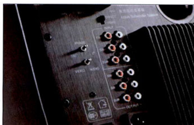
① H6拥有6进6出的声道配置, 能实现5.1声道的输出。
