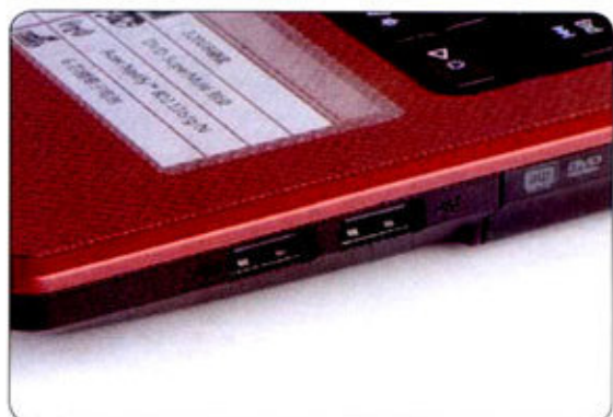
① 机身右侧的USB接口很接近,同时使用时容易冲突。
