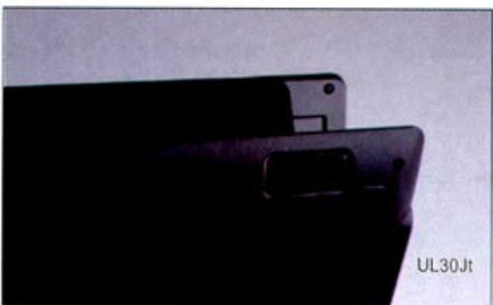
UL30Jt将扬声器放置在了机身前端下部,位于腕托下方,这将有目的地节省空间,实际效果也并不差。
