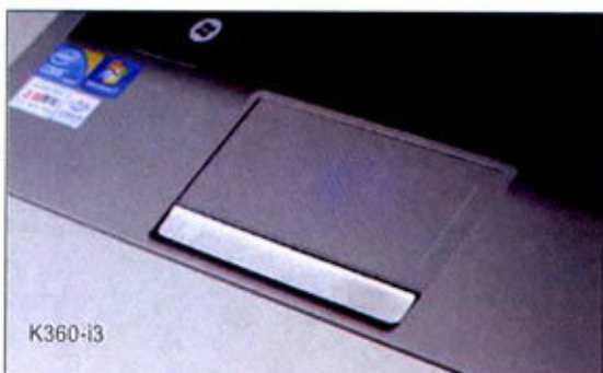
K360-i3触摸板面积宽大,表面虽然没有特别设计凹纹以致手感略差,但磨砂处理也不会有手指移动定位困难之处。
