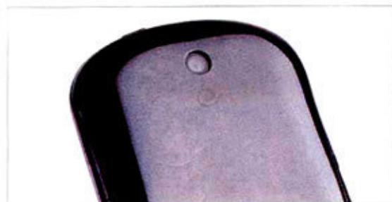
① 后盖表面覆盖了一层镜面漆,有效绝缘,防止信号问题再现。
