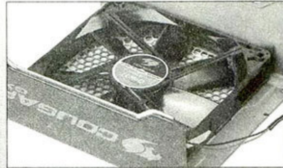
⑥ G600使用HDB(Hydro-Dynamic Bearing)液动压轴承风扇, 比普通双滚珠风扇更静音、更长寿, 风扇制造商很可能是Power Logic(东莞动力)。
