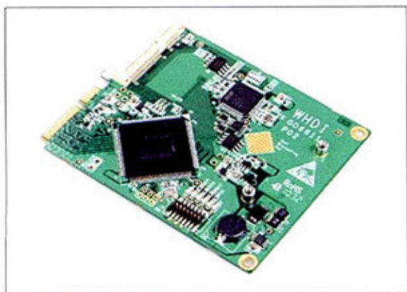
① 在控制部分采用了CAT6023解码芯片以及ARM Cortex-M3 32位内核处理器，其中CAT6023解码芯片可以提供HDMI 1.3标准的双流解码。
