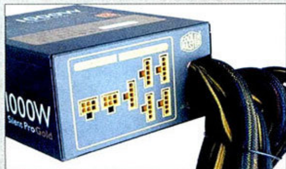
① HDD区域的模组接口较为密集,但由于模组线缆使用的是扁平线,不挡手,因此插拔时仍然较为顺畅。
