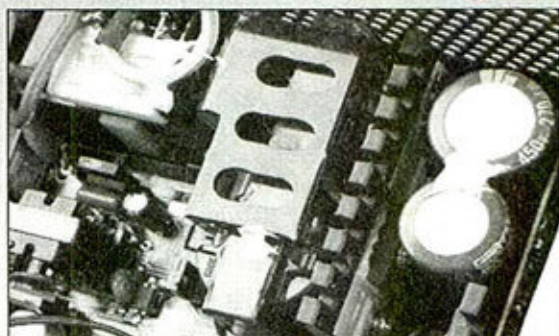
① 双线圈是交错式PFC技术最明显的外在特征, 该技术有助于提高电源转换效率。
