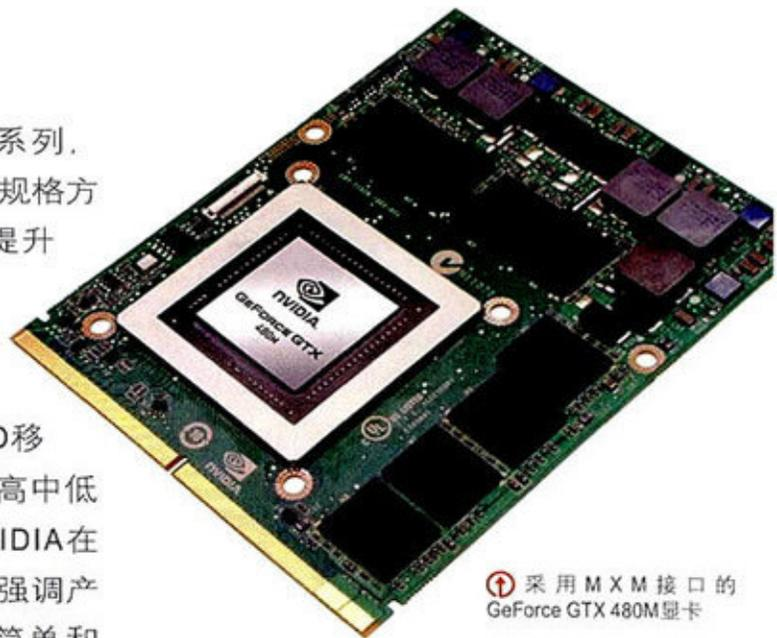
采用M X M接口的GeForce GTX 480M显卡
