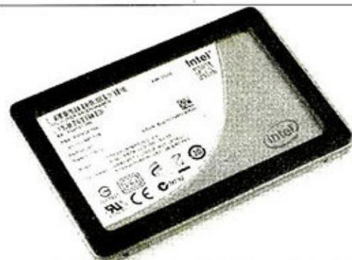
作为Intel消费级SSD的旗舰产品, X25-M采用自家的PC29AS21BA0主控芯片, 使用美光32MB 133MHz SDRAM作为缓存, 这些都与入门级的X25-V相同, 不同的是总共使用10颗34nm NAND闪存颗粒, 具有多达10个通道, 从而获得最高250MB/s的读取速度, 不足是最高写入速度仅有100MB/s, 与7200r/min机械硬盘相比没有优势, 更适合追求稳定性的Intel忠实用户。
