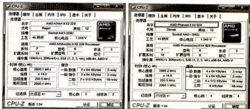
Athlon II X2 220处理器开核前后CPU-Z检测图，可以看到成功开核后CPU-Z不仅自动将它识别为Phenom II X4 920处理器，而且识别出的规格参数也完整无缺。
