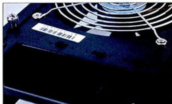
① 顶部的三个风扇控制器可调节底部三个风扇的风速，只有高低两档，相比显卡风扇，机箱的底部风扇即使以高速模式运行噪音也不大。
