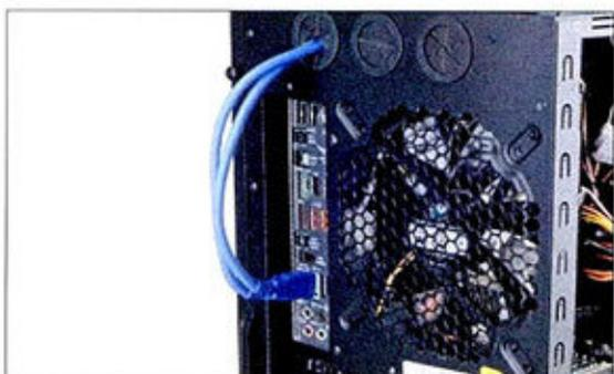
① 机箱顶部特意留有三个水冷孔,水冷设备使用其中两个,另一个用于穿过USB 3.0延长线,并连接至主板的USB 3.0接口。
