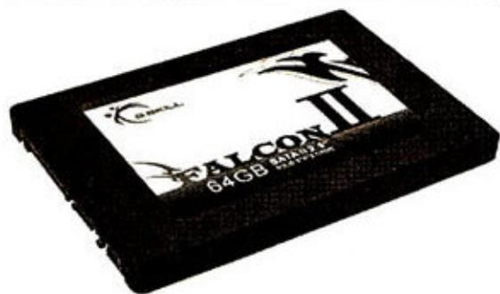
芝奇FALCON II 64GB(型号: FM-25S21-64GBF2)采用了Indilinx主控芯片+ELPIDA 64MB缓存的方案,NAND颗粒使用的是三星MLC闪存,其读写速度丝毫不逊于7200r/min机械硬盘,不足的是质保时间偏短,我们建议游戏玩家将把它分成两个分区,一个作为系统分区,另一个作为游戏分区,安装常玩的大型游戏。
