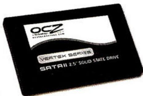
OCZ Vertex系列的30GB SSD(型号: OCZSSD2-1VTX30G)使用Indilinx Barefoot主控芯片,支持Trim优化指令,其最高读取速度可以达到210MB/s,最高写入速度为75MB/s,在入门级产品中的性能算是较为与人的,建议预算在千元以内,希望通过SSD为系统提速的用户考虑该产品。
