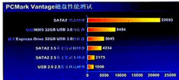
而在模拟实际使用的PCMark Vantage硬盘性能测试中,两款USB 3.0闪存盘也有不错的表现,其中威刚N005 USB 3.0闪存盘8494分的高分成绩令人瞠目结舌。而USB 2.0闪存盘则由于传输速度过慢,经我们多次测试,不能正常完成所有测试,因此无法获得总分成绩。不过从其中的子项成绩,我们也可以看出USB 3.0闪存盘拥有的巨大优势。如在“HDD importing pictures to Windows Photo Gallery”照片导入测试里威刚N005的测试速度则达到了71.037MB/s,而USB 2.0闪存盘的成绩只有26.035MB/s,USB 3.0闪存盘的领先幅度达到了近3倍。
