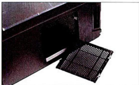
① 机箱背板的通风窗面向机箱进风口，通风窗采用可拆卸的防尘网，清洗很方便。
