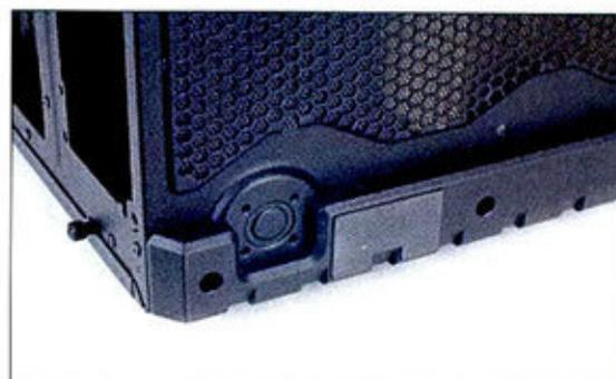
① 较高的脚垫给底部散热留出更多空间,而且脚垫的防滑效果很好。
