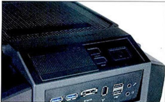
① 两个蓝色接口就是前置USB 3.0接口,顶部开关采用隐藏式设计以防用户误触。
