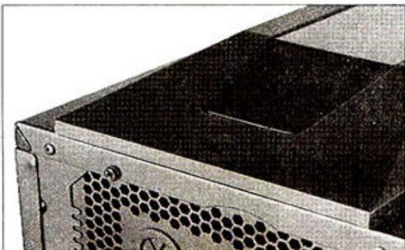
① 机箱顶盖有通风防尘的作用, 尾部的按键是机箱的另一个开关键, 多了一种开机方式。
