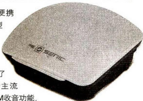
H5体现了微型音响时尚乖巧的特点,其圆润的底壳上覆盖了经过高亮注塑处理的UV面板,既保证了光泽度,还不会掉色。与同形态的产品相比,H5的尺寸是最小的,但小体积并没有造成其单元的缩水,内置的2英寸全频单元与同类产品一致。由于H5支持MP3解码,只需要插入装满音乐的SD卡,将功能键拨至SD卡一档,它就会自动播放音乐,此时我们还可通过音箱上的播放暂停、快进、快退键进行操控。而在FM功能下,这些操控键将自动变为与收音相关的功能。从其音质来说,H5采用了辐射传导技术,增强了低频表现,这让2英寸的单元在回放人声时显得较为饱满,同时其声音干净,在中等音量下能获得不错的听感。另外,H5的收音能力也不错,我们在评测室内就能稳定接收信号,如果插入耳机,耳机导线将变为H5的外置天线,可进一步增强信号的稳定性。H5内置的锂电池容量为500mA,我们也对其进行了测试,在中等音量下,该音箱可播放三小时的音乐。
