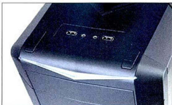
① 乌鸦2进化版机箱改良了上一代的开关键和重启键，缩小了按键尺寸，有效避免了用户误触。
