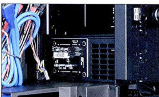
① 机箱内部线材中蓝色线就是USB 3.0延长线,还能看到前置热插拔硬盘位的电路板,不过电路板的安全有些让人担心。
