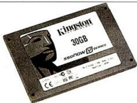
金士顿SSDNow V系列的30GB SSD(型号: SNV125-S2/30GB)是一款性价比较高的产品,它使用东芝T6UG1XBG主控芯片,集成了四颗东芝TH58NVG6D7FBAK0闪存颗粒。它的性能极不平衡,读取速度和响应时间远远优于主流7200r/min机械硬盘,但写入速度偏慢,更适合预算有限的初级用户拿来作系统盘使用。
