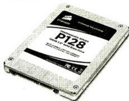
目前海盗船旗下SSD产品线分为Legacy(S/L)、Extreme(X)、Performance(P)、Reactor(R)、Nova(V)和Force(F)六个系列, 海盗船P128 128GB(型号: CMFSSD-128GBG2D)的特色是采用128MB缓存, 读取和写入速度较为均衡, 达到200MB/s上下的高水准, 目前该SSD的价格已经跌破3000元, 在海盗旗SSD中属于性价比较高的一款, 值得发烧玩家关注。
