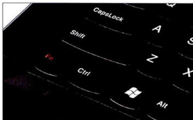
键距越大则使键面越小。甚至有些键盘的键面尺寸仅有12mm，键面尺寸仅相当于标准键盘的60%不到，这样的键盘只有纤纤玉指才能使用。键程过短将导致敲击键盘是手指疲劳酸痛是公认的问题。一些笔记本电脑并没有采用超薄设计，机身应该有足够的空间。此时，键盘键程其实可以设计得更长一些，以获得更好的操作感；但有的产品却为了所谓时尚采用短键程的孤岛式键盘。这样的设计理念，只能说是邯郸学步了。
