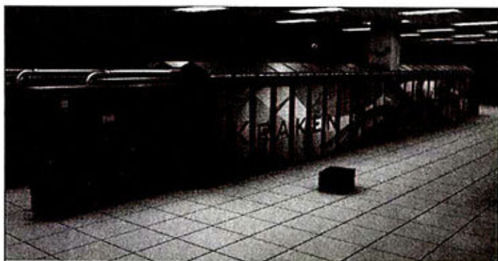
① 上图的后方是192颗4核心CPU组成的大型机, 前方的小型机器则由8个GPU组成, 其并行计算性能更强。
