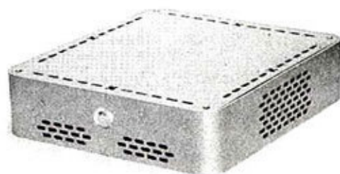
③ 这种厚度仅有60mm~90mm的迷你机箱极致轻薄, 仅能安装ITX主板, 无法安装独立显卡。
