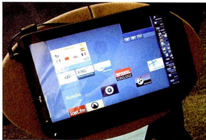
④ MeeGo系统允许设备商自定义用户界面，图中右侧为应用导航栏。
