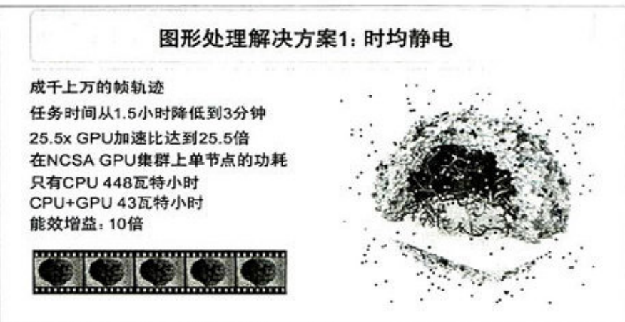
① 图3: 采用GPU加速的模拟过程可以提高25.5倍的速度, 可以节省10倍的能源。
