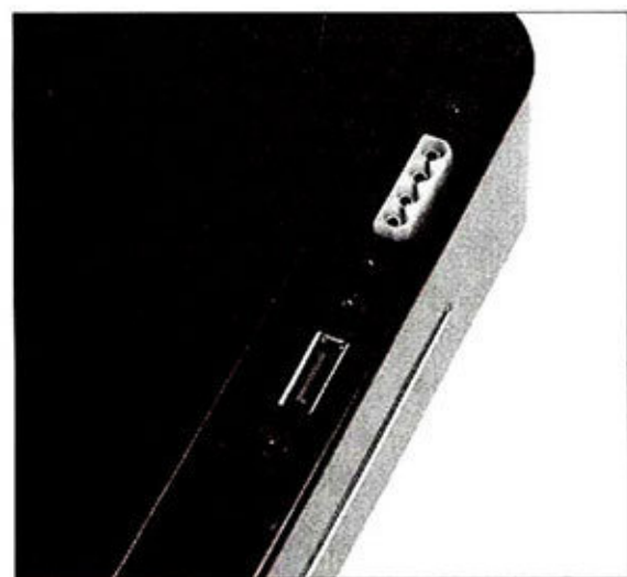
② 通过巧妙的设计,这种迷你机箱在外部提供了硬盘供电接口和SATA接口,可以在不打开机箱的情况下,很方便地直接接上硬盘拷贝下载数据。
