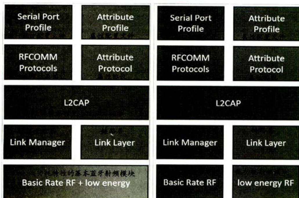
① 共享射频层和独立射频层的双模式低功耗蓝牙设计
