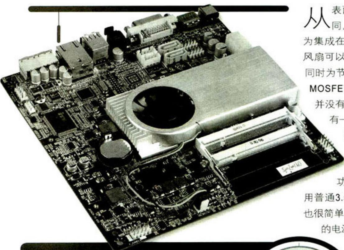
从表面上看, 该主板与普通PineTrail-D主板并没有太大不同。主板没有CPU插槽, 使用一个大型一体式散热器为集成在主板上的处理器与芯片组进行集体散热, 其内置的风扇可以根据处理器工作温度高低, 对转速进行自动调整。同时为节约空间, 这款主板大量使用贴片电感、钽电容、SO-8 MOSFET等小型元器件。此外, 相信大家已经注意到, 该主板并没有20pin或24pin的电源插座。原来在主板I/O背面, 它拥有一个外置电源接口。连接主板附送的(12V, 5A)外置电源适配器, 即可为主板供电。而SATA硬盘所需的电源接口则可以通过主板上的4pin插座, 插入附送的4pin转SATA电源线引出。不过该4pin插座输出的功率较低, 只能使用2.5英寸笔记本硬盘。因此如想使用普通3.5英寸台式机硬盘, 则仍需连接ATX电源。连接方法也很简单, 通过主板上的8pin接口插入一根附送的8pin转20pin的电源连线, 即可连接普通ATX电源。
