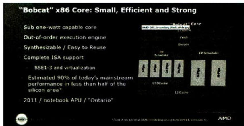
图8 Bobcat架构示意图，它其实是在K10基础上精简而来
