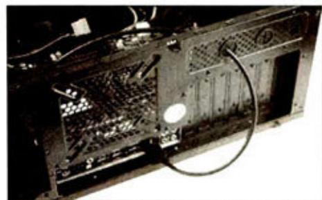
① 使用USB 3.0前置接口之前，要把机箱内自带的USB 3.0数据线连接到主板的USB 3.0接口上。
