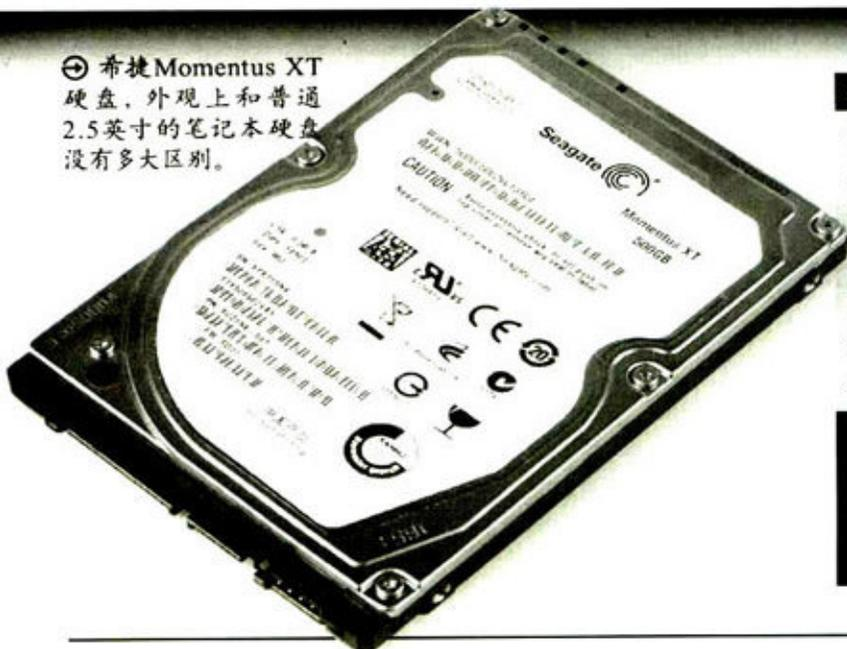
的设计理论上将提升它的实际读取性能，特别是在反复加载某应用后，其针对性的加速能力应该非常明显。不过稍显遗憾的是，目前的设计并没有考虑到写入加速，也许是因为写入的情况比较复杂，目前搭配的4GB SLC闪存还不足以应付；也可能是因为当前用户对磁盘的读取性能要求更高的缘故。另外值得一提的是，它不仅是款7200r/min的产品，同时其配备的32MB缓存容量也在希捷2.5英寸硬盘配置中创下了新高。这样的配置已经让我们对希捷Momentus XT硬盘的性能充满了期待。
