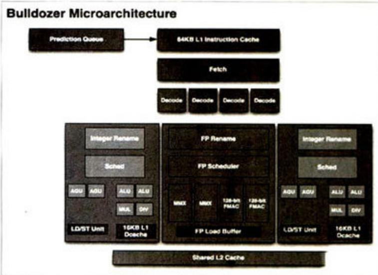
图3 Bulldozer可并行解码四条指令,这将显著提升其指令效能
