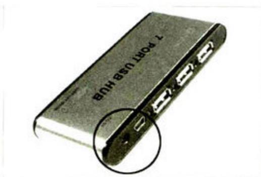
② 使用带外接电源接口的USB Hub, 可以解决USB接口供电不足的问题。
