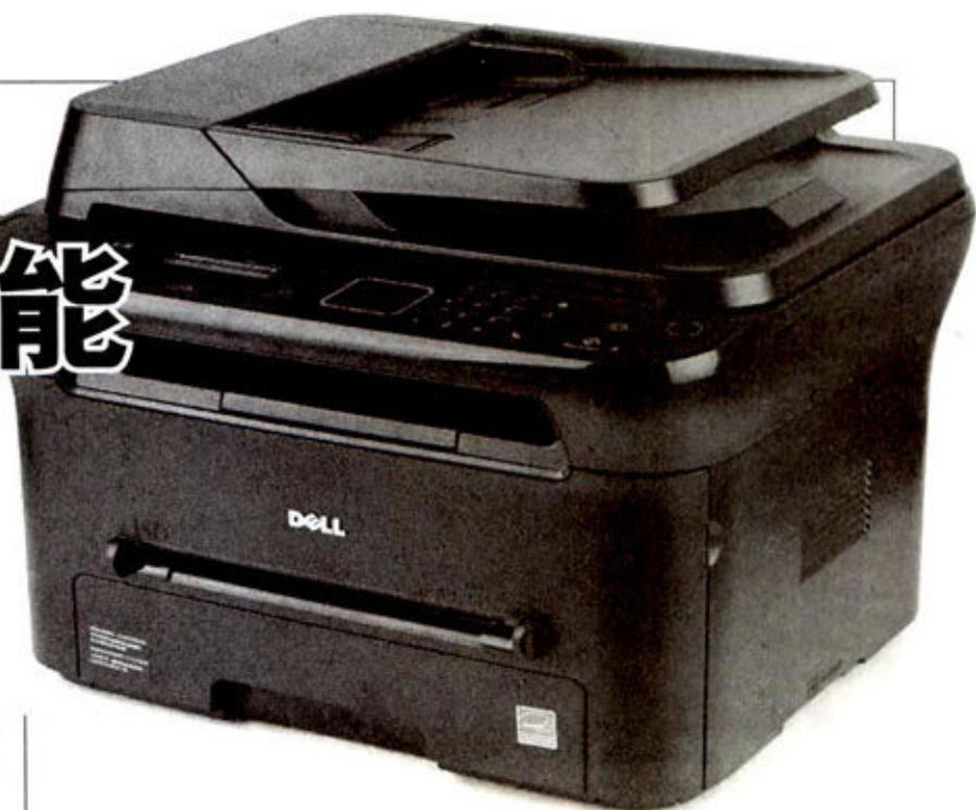
企业用户比较关心的打印速度、复印效果、传真设置等方面, 我们进行了针对性的测试。实际测试中, 戴尔1135n的打印速度令人满意, 首页输出时间约为8.5秒, 单页打印时间约为2.68秒, 与标称的22ppm的速度基本一致。同时其打印效果也算不错, 4磅的阴文和阳文字符均可以清晰辨认, 黑色块填充饱满, 边缘也比较平滑。戴尔1135n的灰度表现不够好, 部分灰阶色块边缘无法辨认, 因此在打印图片是会出现部分位置层次感不佳的情况, 不过在采用最佳打印效果设置(1200dpi×1200dpi)时情况略有改善。
