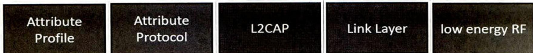
① 低功耗蓝牙单模式架构, L2CAP为新开发的替代模块
