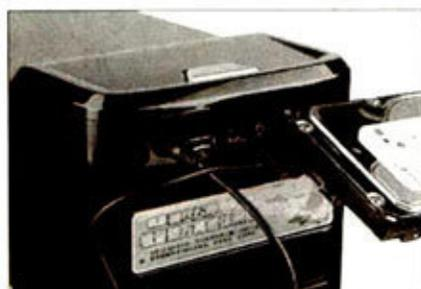
① 机箱附送的eSATA转接供电线，使用SATA设备更方便。
