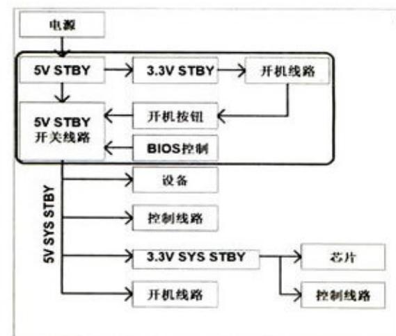
① 图4 优化后5V STBY结构分布图(方框内为关机状态下功耗区域)。
