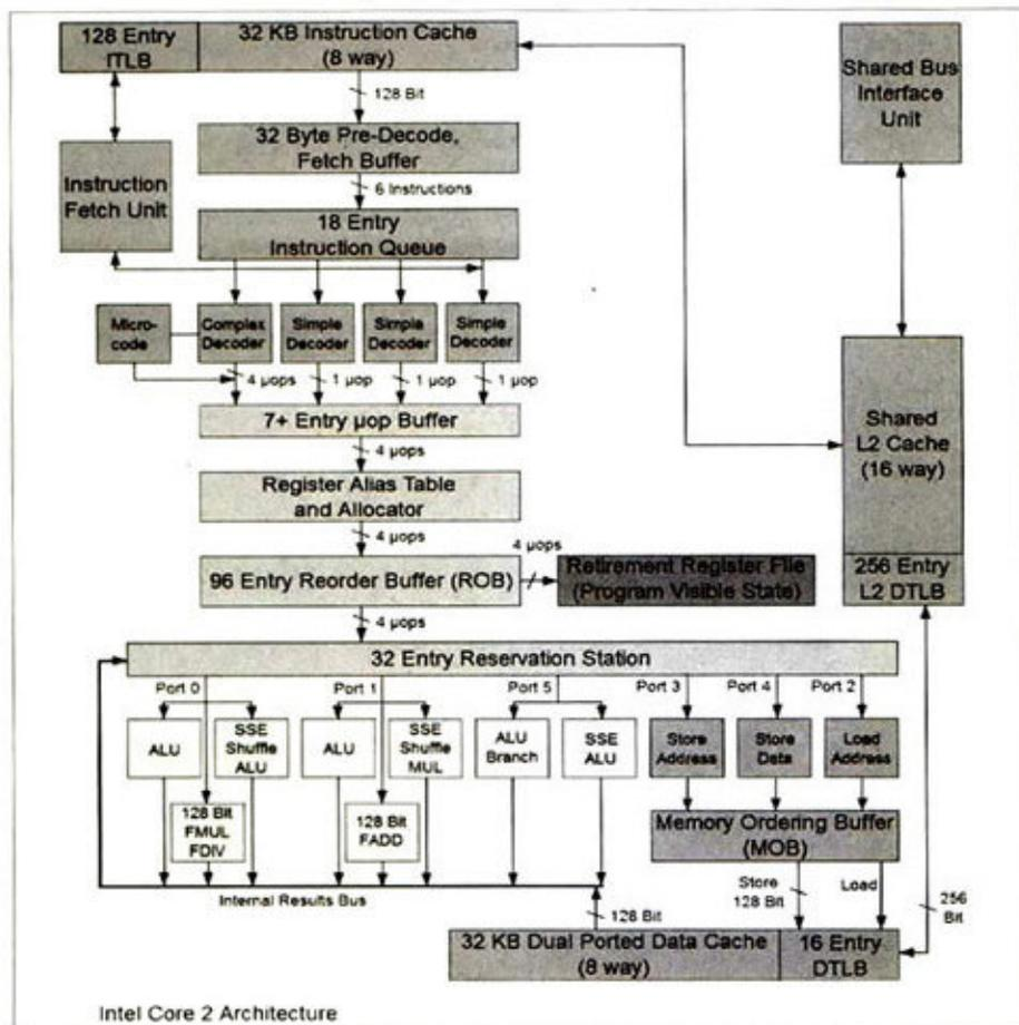
图1 Intel Core微架构,它的高性能奥秘主要就在于可并行解码四条指令
