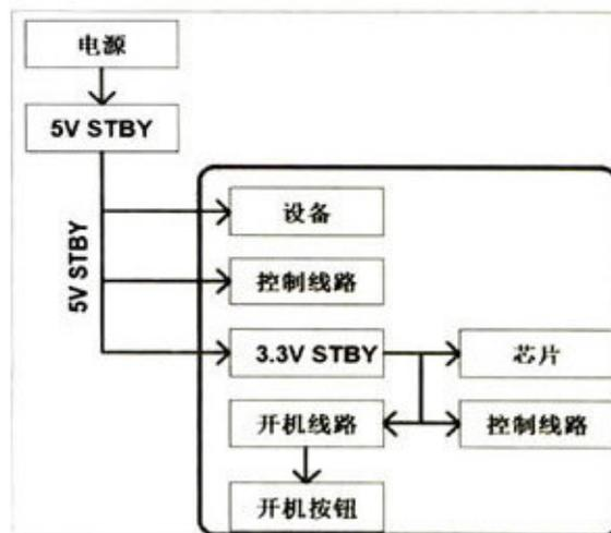
① 图3 原5V STBY结构分布图(方框内为关机状态下功耗区域)。
