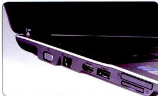
① 机身左侧, 多合一读卡器和ExpressCard叠在一起位于机身前端, 取用都是十分方便的。HDMI和eSATA/USB两个接口之间的间隔不够, 因为有些HDMI线缆的插头比较大, VGA与RJ45之间的间距非常充足, 同时使用毫无问题, 当然拥有较大水晶头的网线也很少见。
