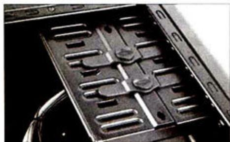
① 光驱和硬盘使用免螺丝设计，并且正式产品将配齐全部扣具。
