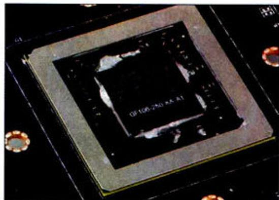
① GeForce GTS 450采用了小核心的设计策略，其核心没有添加金属盖，代号为GF106-250。
