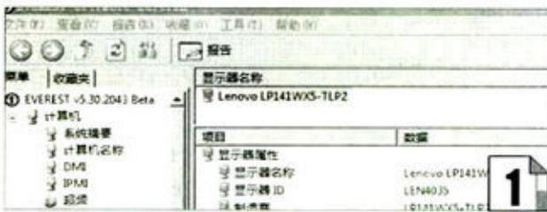
① 通过系统检测软件可以查看笔记本电脑所用的液晶屏幕的型号
