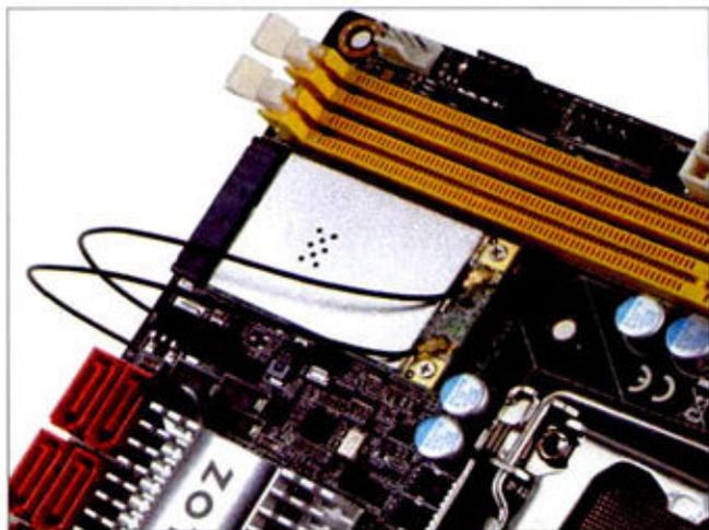
⊖ 右图:华硕M4A88T-I Deluxe主板的无线网卡通过主板上的特殊插槽,直接安装在主板背板接口,可直接安装天线。
