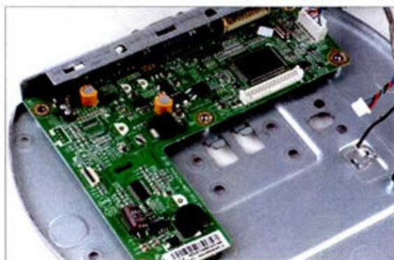
① 底座中的主控电路模块、供电模块。
