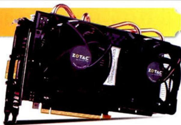
该显卡的核心频率、显存频率和流处理器频率分别为700MHz、3600MHz和1400MHz，频率略高于公版。它采用3相核心供电、1相显存供电设计，搭配铁素体电感，每相供电配备3个“八爪鱼”（SO-8封装形式）MOSFET，稳定性比普通的DPAK封装形式的MOSFET更好。该显卡采用了瑞士AC TwinTurbo PRO双风扇、4热管散热器，散热器几乎将整个PCB覆盖，不仅可以很好地对GPU核心进行散热，还可以辅助供电部分等周边元器件的散热。这使得该显卡的待机温度和满载温度分别只有27°C和49°C左右，噪音亦很低。
