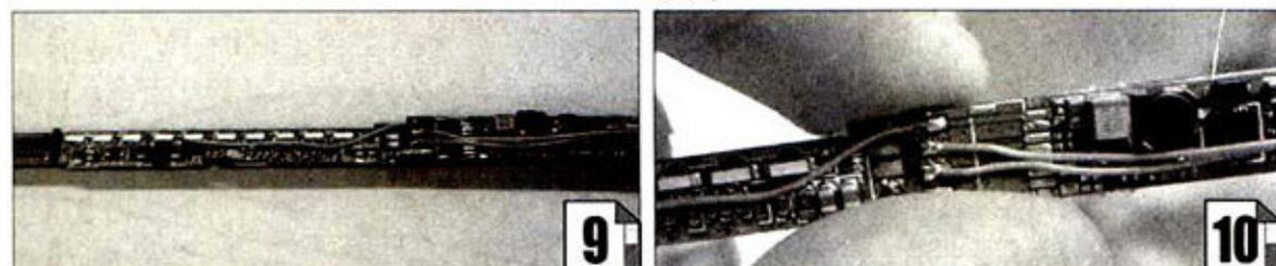
① 将新的控制板焊接在原驱动板上
