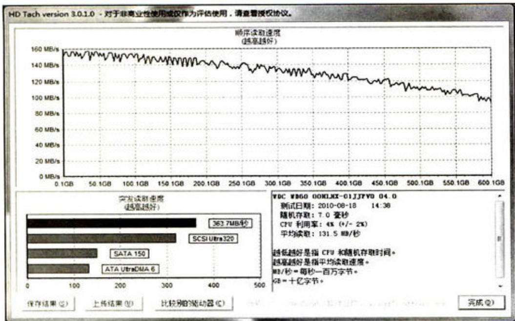
① HD Tach 32MB模式测试中西部数据WD6000HLHX硬盘的突发传输速度达到363.7MB/s甚是惊人,并且随机存取延迟仅7ms,平均读取速度也高达131.5MB/s。
