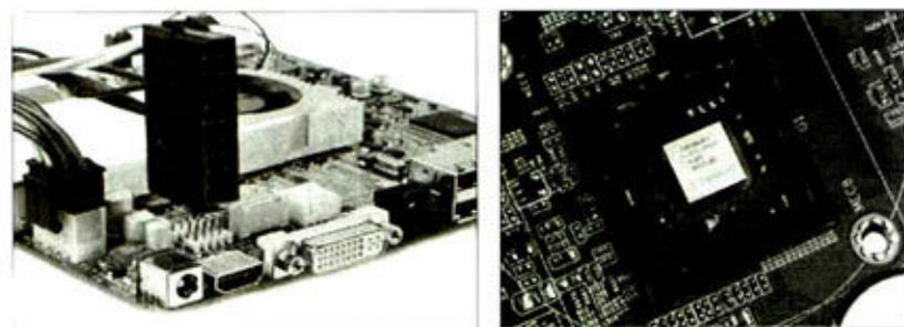
① 该主板既可以通过背板电源接口连接电源适配器供电, 也可以通过主板附送的8pin转20pin电源连线, 连接ATX电源。
