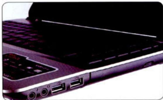
① 机身右侧, 我们首先要看的就是音频接口, 它设计在最靠近使用者的位置, 这能够很好地避免耳机线缆不够长的尴尬。音频接口的旁边就是两个USB接口, 它们之间的间隔不算大, 应付小插头的USB设备同时使用还是没有问题的。
