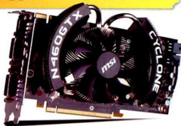
该显卡最大的特点便是采用军规组件，它具备贴片式SSC静音电感（位于GPU供电部分）+钽电容（位于显卡PCB背面）+固态电容（位于PCB正面的GPU供电和显存供电等多个部分）。它采用3相核心供电和1相显存供电设计，亦是一款高频版的产品，其核心频率、显存频率和流处理单元频率分别为727MHz、3600MHz和1450MHz。它使用了呈圆弧形的散热器，散热鳍片和两根热管经过了镀镍处理，其待机温度和满载温度分别为32°C和60°C左右，散热性能出色。
