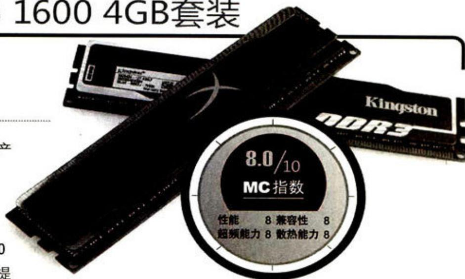
而更让我们欣喜的是, 该内存也具备较强的超频性能。在1.4V处理器电压、1.3V内存控制器电压、1.7V内存电压设置下, 它可与处理器同步进行大幅超频。在处理器频率达到170MHz×25=4250MHz的状态下, 内存频率达到170MHz×12=2040MHz, 并可稳定地工作。在这一状态下, 系统的各方面性能都有了大幅提升。EVEREST内存访问延迟不到40ns, wPrime 32M运算时间逼近6s。
