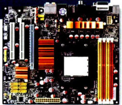
SATA 3.0技术，价格为599元的高性价比产品。但有所不同的是，由于其北桥采用的AMD 890GX，因此默认显示核心频率达到700MHz，与显示核心频率仅560MHz的880G产品相比性能更强，更加超值。同时这款主板拥有较好的做工设计，主板所用电容全部为万裕系列固态产品。处理器供电部分采用普通的3+1相供电设计，同时它还采用了两倍铜PCB技术，可降低PCB阻抗，提升PCB散热性能与电源转换效率。
