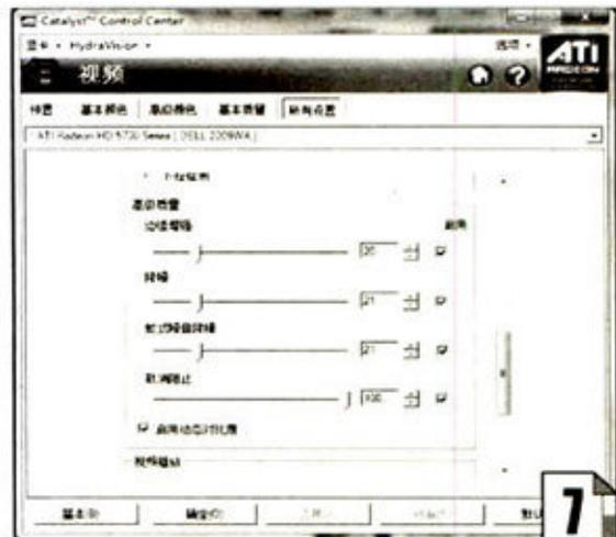
用于解决一些压缩严重的视频图案边缘不够平滑理想的问题，对系统的要求和蚊式噪音相同
