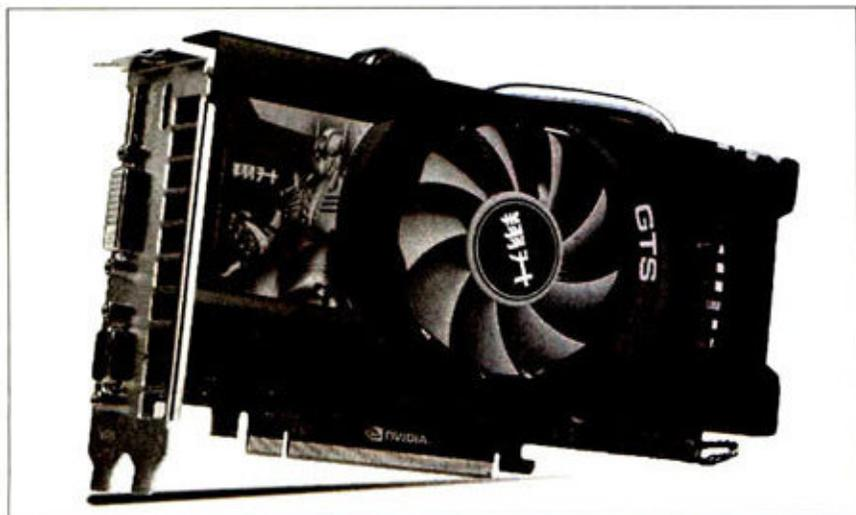
④ NVIDIA发布的GeForce GTS 450显卡
