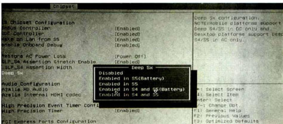
图6 在未来的Sandy Bridge平台中,要想开启EuP功能,则将“Deep Sx”项目设定为“Enabled in S4 and S5”。
