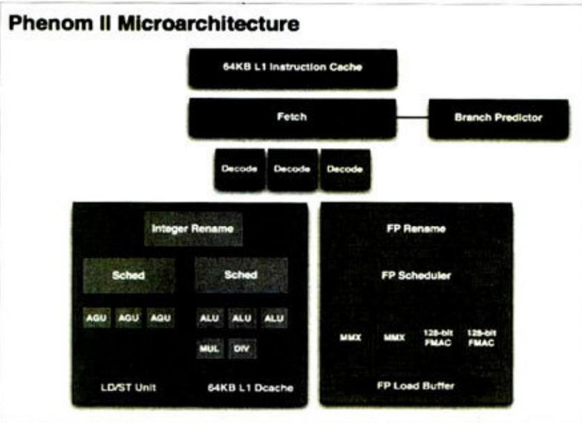
图4 Phenom II所采用的K10架构
