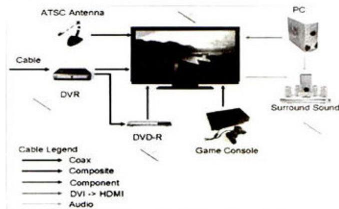
① 点对点结构带来线缆连接问题
