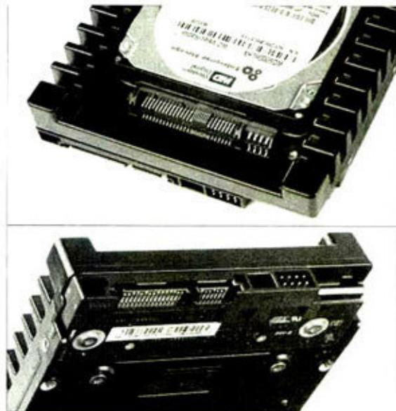
① 可以看到西部数据WD6000HLHX硬盘其实是一块2.5英寸硬盘,封装在了兼容桌面平台的3.5英寸安装架内。通过集成电路转接,提供了SATA 6Gbps接口。
