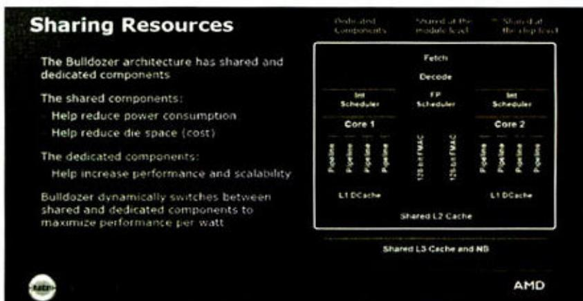
图5 Bulldozer内的浮点单元由两个核心共享，从而获得更出色的能耗和成本优势
