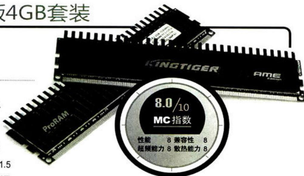
为了能让游戏玩家获得更好的性能，该内存的默认SPD里就设置有DDR3 1600工作频率。只要搭配Core i7系列处理器，内存就会自动将工作频率提升到DDR3 1600。同时该内存还支持Intel XMP技术，并预存一套同样工作在DDR3 1600的XMP参数，不过其工作电压由默认的1.5V提升到1.65V，CMD首命令延迟被增加到2T，因此可以保证内存能够更加稳定地运行在DDR3 1600下。
