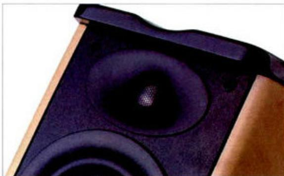
① 20mm金属硬球顶高音单元通过声学模拟技术
