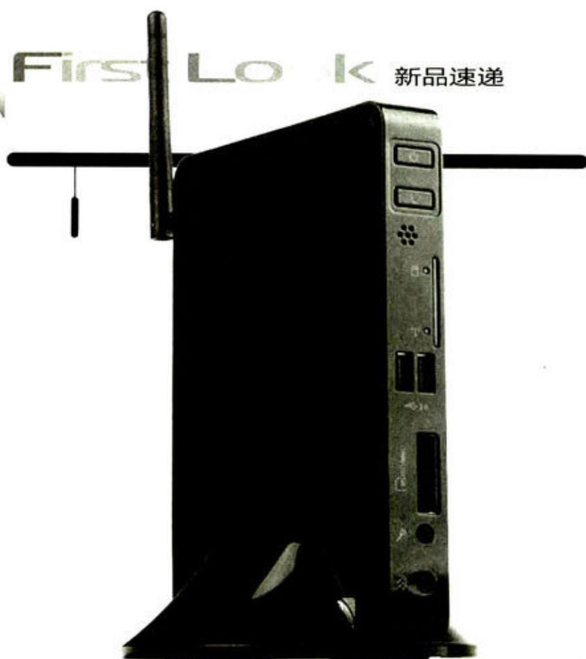
**搭**配Atom D525处理器的翼扬迷你电脑我们已经介绍过几款了,对于这类适合作为客厅高清媒体娱乐中心的产品,很多读者表示了浓厚的兴趣。不过翼扬+Atom并不是迷你电脑的全部,还有采用纯粹英特尔平台的产品可以考虑。Atom D525本身是针对入门级低功耗桌面平台的双核四线程处理器,内置了GMA 3150图形核心,已经可以在一定程度上承担起普通应用的需要。毕竟现在Atom处理器已经内置了显示核心,搭配英特尔自家的芯片组可以让平台功耗更低。富士康推出的NetBox nT525迷你电脑就采用了Atom D525处理器与英特尔NM10芯片的组合。
