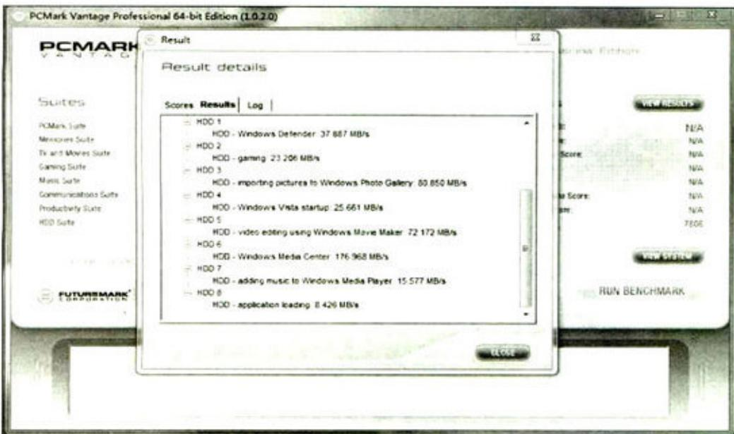
① 出色的综合能力, 使西部数据WD6000HLHX硬盘获得了7805分的PCMark Vantage HDD子项得分。
