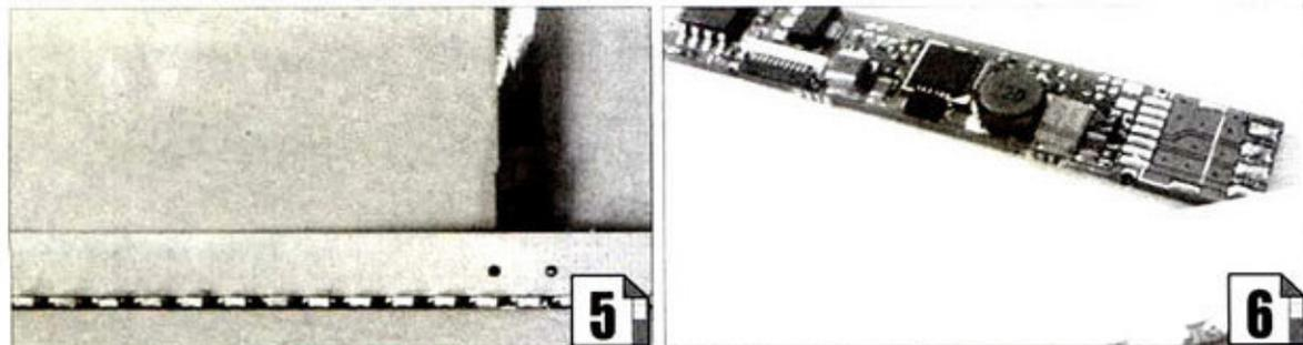
改造前我们需要购买的LED背光组件包括了LED灯条(图5)和LED驱动板(图6)两部分。在北京、广州等IT市场较为发达的城市,到电子市场就能买到,而其他地方的读者可以考虑网购,这两部分的花费大约在200元左右。而在购买时,需要注意两项指标:一是现有液晶屏幕的尺寸,了解后才能购买到与屏幕灯管长度相等LED灯条;二是现有液晶屏幕的亮度调节级数(即用键盘上的快捷键调节屏幕时共有多少不同的亮度),它可以确定笔记本电脑采用的是PWM还是Analog方式的控制IC,这样我们在选择驱动时才能购买到正确的产品。
