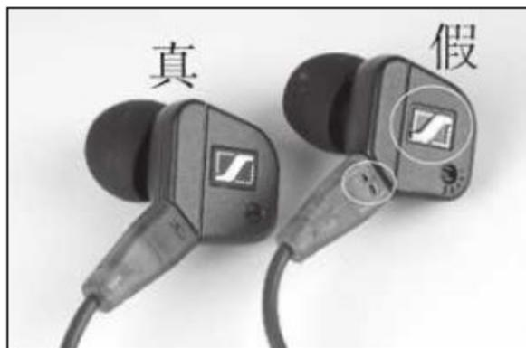
① 在图片中我们可以清楚地看到，正品的Sennheiser Logo设计精良，边缘处理细致，而仿品的做工却显得粗糙，典型的“小作坊”出品。在耳柄部位，正品上开的孔也要比仿品的更细小。
