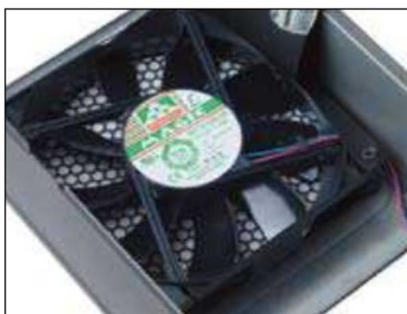
① 台系大厂Protechnic的12cm智能温控风扇，成本较高，低转速下静音效果很不错。
