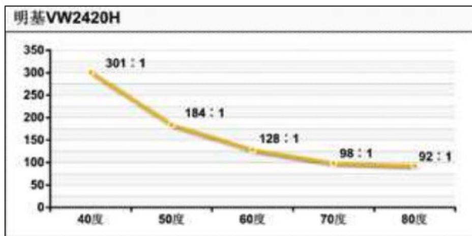
③ VW2420H不同水平偏转角度下的对比度
