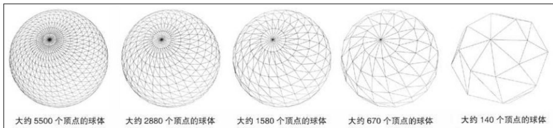
图7 八分树的细节度越高,图形也就相应地更精细。
