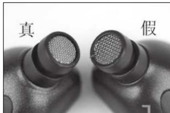
① 正品IE8发声部位的铁网孔状均匀平整，而仿品的发声口边缘有明显毛刺，同时内置铁网弯曲不整，显然是在安装时工艺不佳所致。
