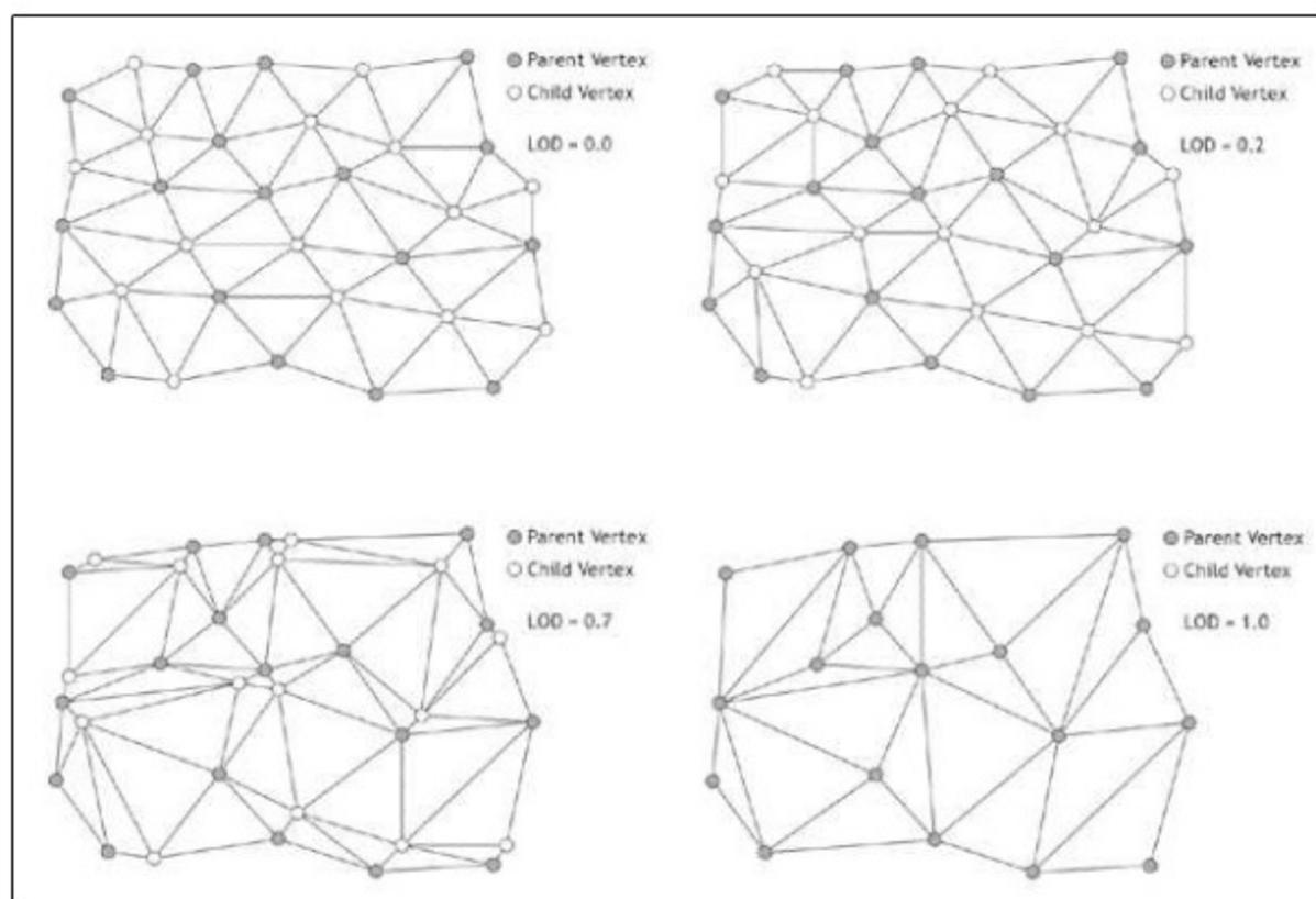
图8 渐进网面技术示意图
