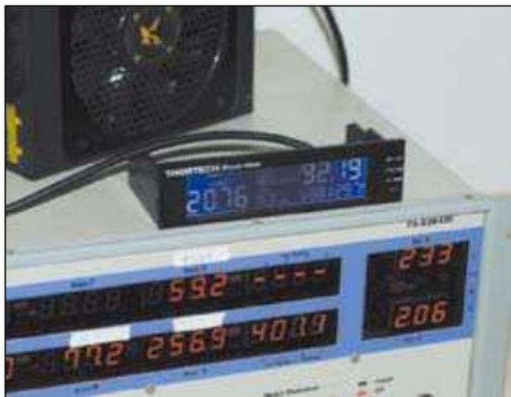
④ 我们使用电子负载仪测试电源,其前置面板显示典型负载下(400W)的转换效率达到92.19%。
