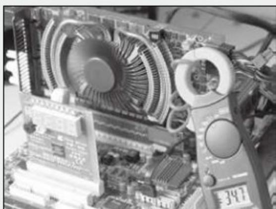
① 核心超频到800MHz,公版GeForce GTX 460的每相电流达到了34.7A,测试中甚至短暂出现过36A的高电流!
