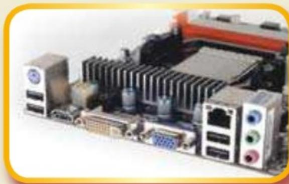
② DVI、HDMI、VGA一应俱全,主板可轻松地连接各型显示器。
