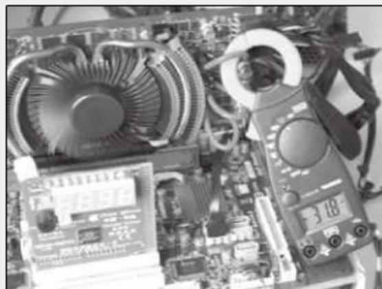
① 在FurMark满载压力测试下,默认频率的公版GeForce GTX 460每相供电达到了31.8A的电流输出。
