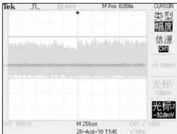
① 无Proadlizer电容时,纹波电压为380mV,使用该电容的盈通显卡则将纹波电压降低到200mV内。
