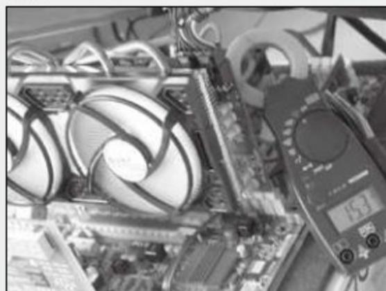
① 采用六相供电设计的盈通游戏高手GTX 460,在FurMark满载状态下,每相电流值只有15.3A。
