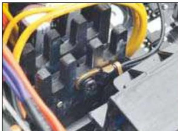
① 固定在功率二次侧(输出端)散热片上的温度探头，前置面板上显示的就是此处的温度值。
