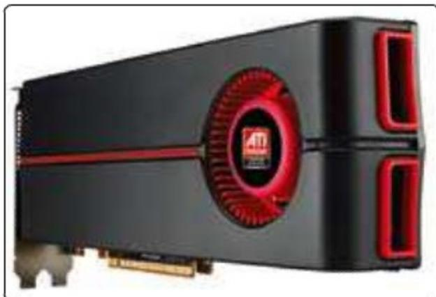
① 外排式散热方案是绝大多数高端显卡的共同选择。一般说来, TDP功耗在150W以上的产品通常会选择外排式散热方案。
