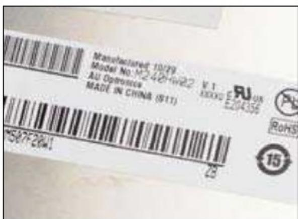
② VW2420H所采用的型号为M240HW02的面板找到这块面板的具体规格参数，不过通过网站上的介绍，我们还是了解到一些有关AMVA面板的知识。第一代AMVA面板其实早在五年前就已经出现，其技术目前发展到第三代，静态对比度能达到5000:1，不过从成本以及生产线经济切割的角度出发，友达更多将其应用在液晶电视领域，如明基的VK3211、SK3231液晶电视机都是基于AMVA面板。当然，如果你记忆力够好，在2006年明基曾推出过应用第一代AMVA面板的机皇FP241WZ，当时它的报价达到万元，此后的FP241VW仍然保持在这一价格区间，这也使得零星出现在显示器领域的AMVA产品成为高端的代名词。
