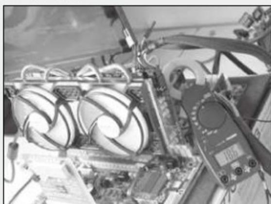
① 在超频到核心850MHz后,六相供电的盈通游戏高手GTX 460每相供电只有18.6A。
