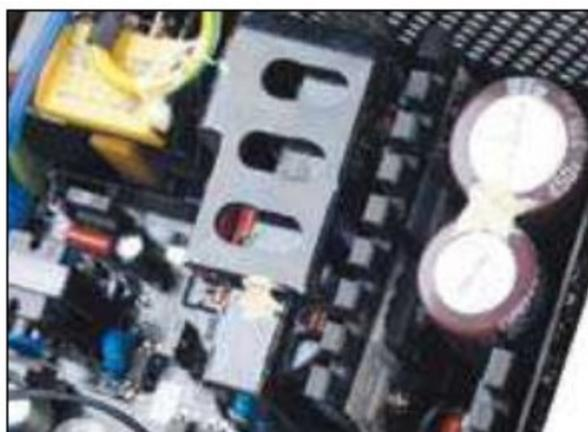
① 双线圈是交错式PFC技术最明显的外在特征，该技术有助于提高电源转换效率。
