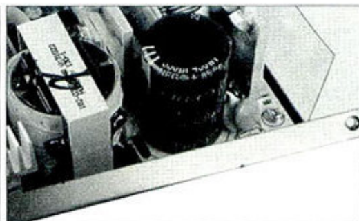
① 主动式PFC+双管正激的内部结构 ② 主电容为HEC LS 330µF(85°C/450WV)
