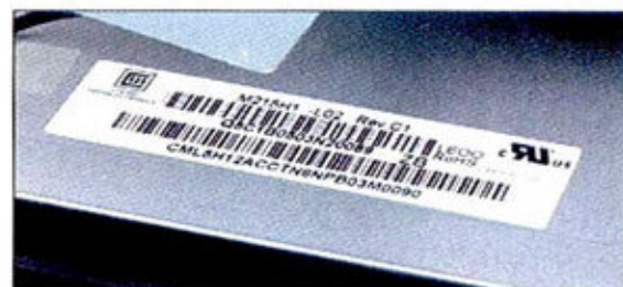
④ VX2258wm的面板信息，左上角“CHI MEI”字样表明其出自奇美，中央“M215H1-L02”则是面板型号，其中的“215”表示21.5英寸的尺寸。
