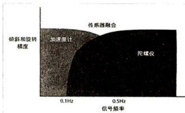
⑤ 图5: 当信号频率高于0.5Hz时,陀螺仪对倾斜和旋转运动的测量精度高于加速度计,反之亦然。而通过传感器融合算法可把加速度计和陀螺仪的数据相结合,便可实现更宽的运动信号频率覆盖范围。
