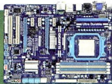
② 技嘉GA-890GPA-UD3H主板,配备了独家的“轻松省”节能引擎,不仅能随时精确掌控CPU消耗功率,还可依据CPU负载状况自动调整供电。
