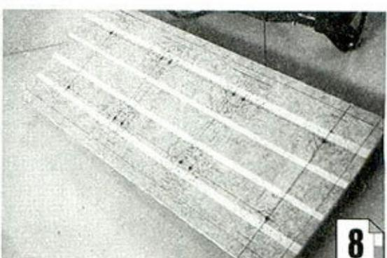
**Step09:** 机箱的上盖是铝材质, 所以切割很容易。切割时要注意拿电磨的手要稳, 为了防止切偏, 可以先用电磨沿着线开一道浅浅的导向槽。(图9)
