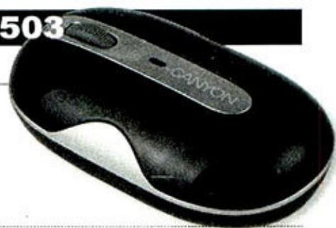
CANYON肯扬极电503是一款支持旋盖的产品, 其上盖可向左向右各旋转180°, 这种设计非常独特, 而它也曾多次出现在本刊的评测中, 这款鼠标采用了1600dpi分辨率的激光引擎设计, 经测试其工作电流不到5mA(3V电压), 与雷柏3700-Fit一样, 它也可堪称目前最省电的无线鼠标之一, 单从这一点上看, 就很值得推荐。
