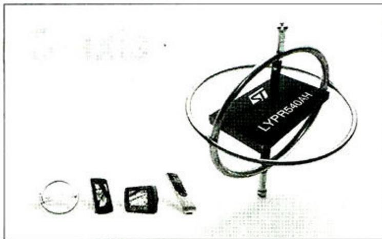
图7: 陀螺仪是用来测量物体的角速度的，而加速度计则是测量物体的线性加速度的，两者的应用领域不同，所以本质上应该是互补关系，而不是相互竞争的关系。如果能将三轴陀螺仪与三轴加速度计整合在一起，则能更完整地传感出物体的运动状态，为终端产品提供更好的性能。
