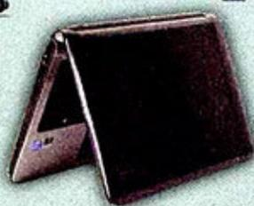
闲置时出现了不同的变化。即使地表的温度要远高于大气温度,但与C面的升温幅度相比,D面的升温幅度要小一些。热空气上行的影响是一方面,另外一方面,在极端条件下的测试显示,除了正常的散热渠道,C面不经意间成为了散热主力,而不是D面。这与产品的设计策略有关,笔记本电脑在考虑散热设计时需要综合多方面的因素。由于大腿的皮肤敏感度远远高于手指皮肤的敏感度,因此在设计时必须注意D面不能过热,以避免一旦用户将笔记本电脑置于腿上时产生强烈的不适。此外,还需要考虑外观设计和成本的需要,所有这些都导致了C面升温高于D面的结果。当然,在正常使用环境下大家并不担心这个问题。索尼VAIO CW28依然保持了较为出色的散热性能,戴尔Inspiron 14R和三星R480则紧随其后。
