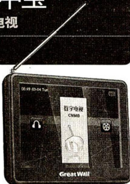
别看它的屏幕对角线长度和iPhone的差不多，通过采用窄边设计以及将按键移至侧面，竟使得整个机身比一张标准名片大不了多少，可以轻松放入牛仔裤口袋中。这款产品采用了瑞芯微解码方案，支持RMVB、AVI、FLV等主流视频格式，经测试最高可以流畅播放分辨率为800×480的视频。需要说明的是，C31虽然可以播放存储在本机中的视频文件，但终究是一款移动数字电视，因此屏幕分辨率只有320×240且比例为4:3，刚好满足播放CMMB视频信号的最基本要求。
