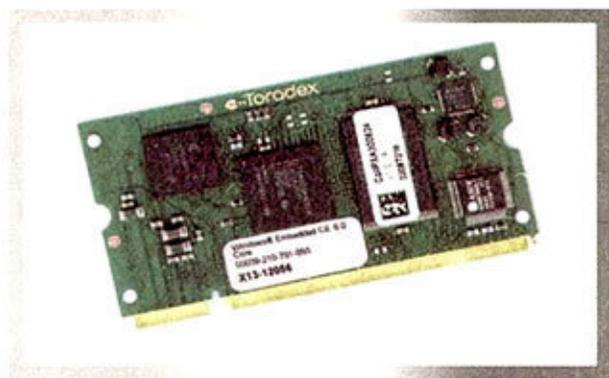
T20的嵌入式系统,而且是基于双核Tegra T20 Cortex A9 MPCore处理器。除了集成高达1G主频的双核处理器,这个最新的计算机模块还支持1080p高清视频的播放,1920×1080分辨率,内置了256MB DDR2内存和1GB闪存。而且最关键的是该模块尺寸仅仅为67.62mm x 36.72mm x 5.2mm。预计大家在今年第四季度即可在市场上见到Colibri Tegra T20的样品。
