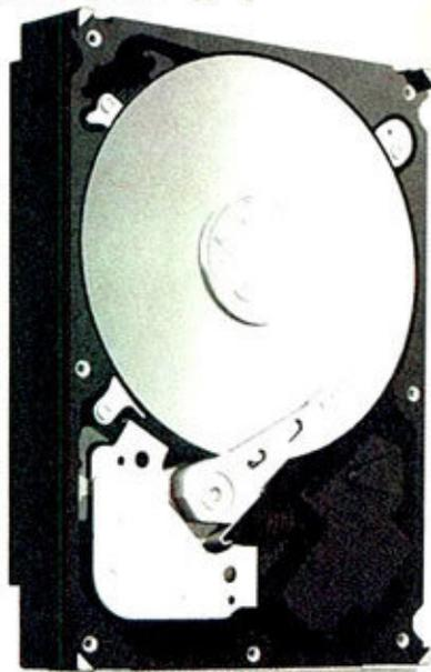
暴露在高温环境中时, 含有溴等卤族元素的物质便可能气化、电离, 接着在电路板上形成沉淀物, 对电路板造成腐蚀性危害, 直至产生故障。因此很多厂商都开始禁用含有卤族元素的生产材料, 转而开发其它代替品。例如希捷的Pipeline HD硬盘, 在生产过程中就禁用了含卤素的材料, 包括溴化阻燃剂。另外, 硬盘中普遍使用的吸音绵也是溴污染源头, 为此, 从2008年开始希捷就停用了吸音绵, 转而使用一种隔音专利技术。采用该技术生产的硬盘不仅避免了卤素污染, 还能在更加静音的基础上, 辅助硬盘散热, 进一步提高可靠性。
