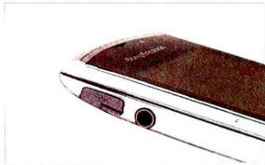
② 机身右侧除了microUSB接口用于充电和数据传输之外,还有一个通用性较高的3.5mm音频接口。
