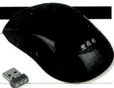
双飞燕的鼠标给我们的感觉是一向很务实, 这款G9-400也不例外, 在外形上并没有太炫的设计, 不过其省电功能同样不弱, 虽然它仅采用光学定位, 但将节能胜激光技术引入后, 该鼠标在1.5V电压下的工作电流也只有22mA左右, 远低于同类产品, 可以说, 双飞燕天遥系列拥有节能胜激光技术的无线鼠标是目前最省电的光学无线鼠标。
