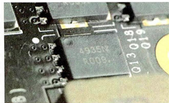
GeForce GTX 460采用发热量更低的SO-8封装形式的MOSFET
