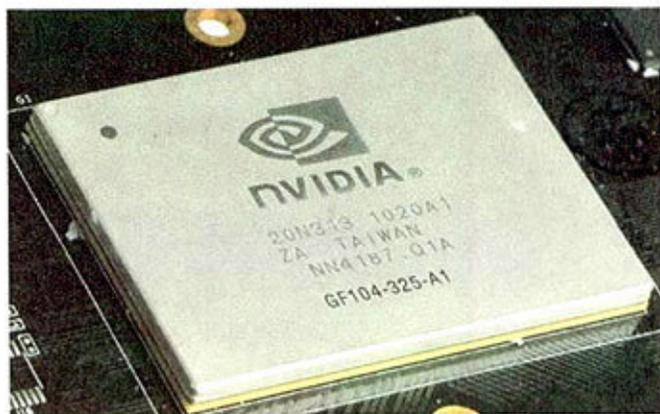
GeForce GTX 460的核心面积更小,发热量和功耗都得到了有效控制。
