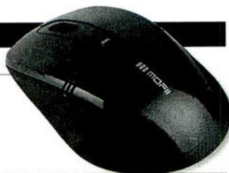
G13是一款高性价比的2.4GHz无线鼠标, 58元的售价很容易让消费者接受, 这款鼠标同样采用了节能的蓝光引擎设计, 支持1600dpi分辨率, 性能可以满足用户日常办公应用的需求, 在功耗方面, 该鼠标在3V电压下的工作电流保持在10mA左右, 省电能力不错, 同时, 它还支持自动断电功能, 并采用单、双节电池均可供电的设计, 方便用户使用。
