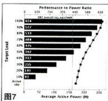
很明显, DL385 G6在功耗性能比上大大领先于DL380 G5, 考虑到现在多数数据中心服务器的负荷不大, 用一台DL385 G6取代两台DL 380 G5是不成问题的。另外采用英特尔最新基于32纳米制程至强5600系列处理器的服务器产品也是目前很不错的选择。一方面其更先进的制程可以使处理器功耗得到更好的控制, 另一方面, 该处理器可以智能适应工作负荷, 进行频率和内核调整, 在非高负荷状态更好地节约电能。而其最高6核12线程的硬件规格, 也使其性能与几年前的单核服务器相比可提高15倍。
