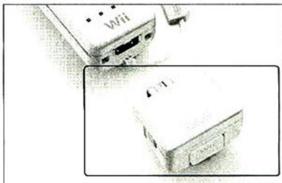
图8: Wii MotionPlus由一个单轴(图下方)和双轴(图上方)陀螺仪组成三轴陀螺仪
