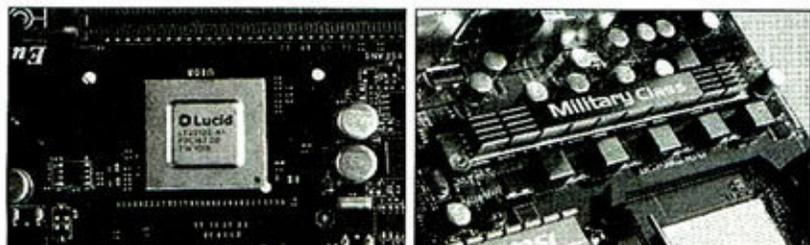
① 微星870A FUZION主板上的 Lucid Hydra混交芯片。 ② 供电电路的用料相当豪华,采用军规级别固态聚合物钽电容和冰魄电感。
