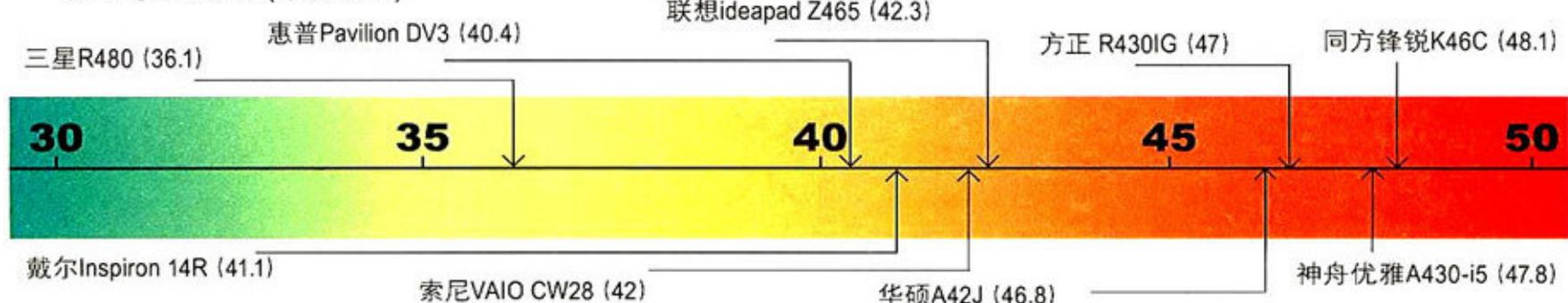
33dB~36dB之间波动,表现最好的当属三星R480、索尼VAIO CW28以及同方锋锐K46C,它们的闲置状态噪音分别只有32dB、32.3dB和32.4dB,这已经非常接近环境噪声了。即使是闲置状态噪音最高的惠普Pavilion DV3也只有
