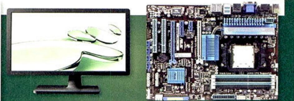
① 明基V2410显示器,采用了LED背光,较同尺寸的CCFL背光型号产品省电36%。
