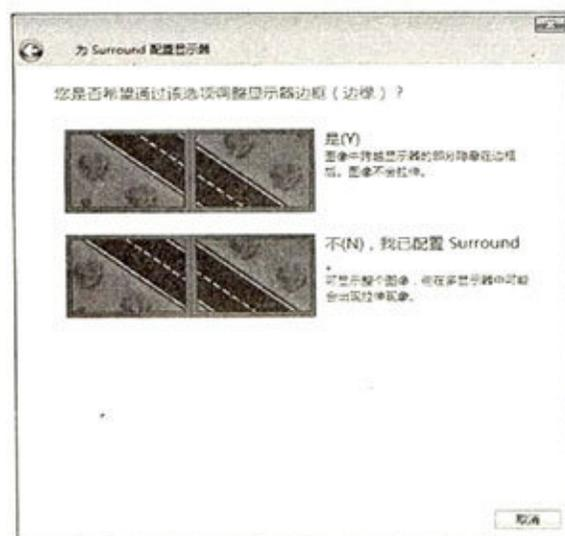
① 接下来是非常人性化的调整显示器边框的对话框。目前还没有无框显示器,那么在组建3D Vision Surround以后,边框会导致画面连接不协调。NVIDIA为此提供了边框校正技术,它可以将画面中跨越显示器的部分隐藏在边框后,画面不会被拉伸,颇有几分无缝拼接的味道。此时,你点选“是”进入下一对话框。
