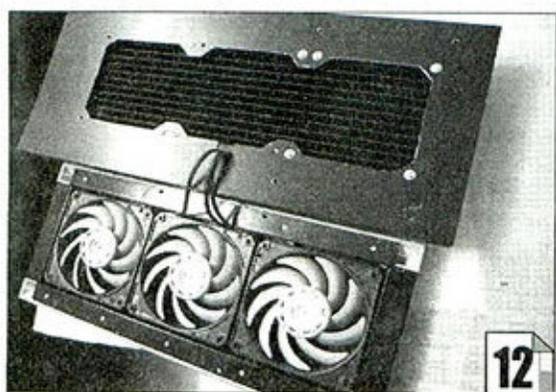
**Step13:** 顶盖改造完成, 将风扇罩和冷排一起装在A05N机箱的顶盖上, 整体效果相当协调。(图13)
