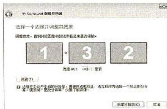
① 此时,你可以调整显示宽度,直至预览图像中的线条看起来是连续的。三台显示器进行拼接将会有两个连接处,我们将这两个拼接部分的宽度设置为140像素(根据不同的显示器进行设置),如此就可以获得更协调的拼接画面。边框校正会产生新的分辨率,你需要点击“创建分辨率”,而后在桌面点击右键,选择“屏幕分辨率”去设置新的分辨率。此时经过校正后的最大分辨率为5320×1050(默认是5040×1050)。
