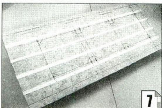
**Step08:** 在切割冷排风口之前钻好固定冷排的螺丝孔, 因为此时机箱上盖还有一定强度, 不容易钻偏。(图8)
