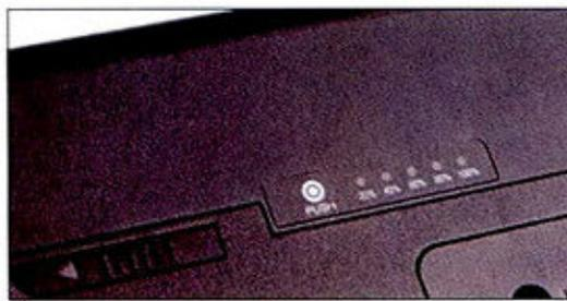
① 通过电池上的指示灯,用户可以随时了解电池电量。
