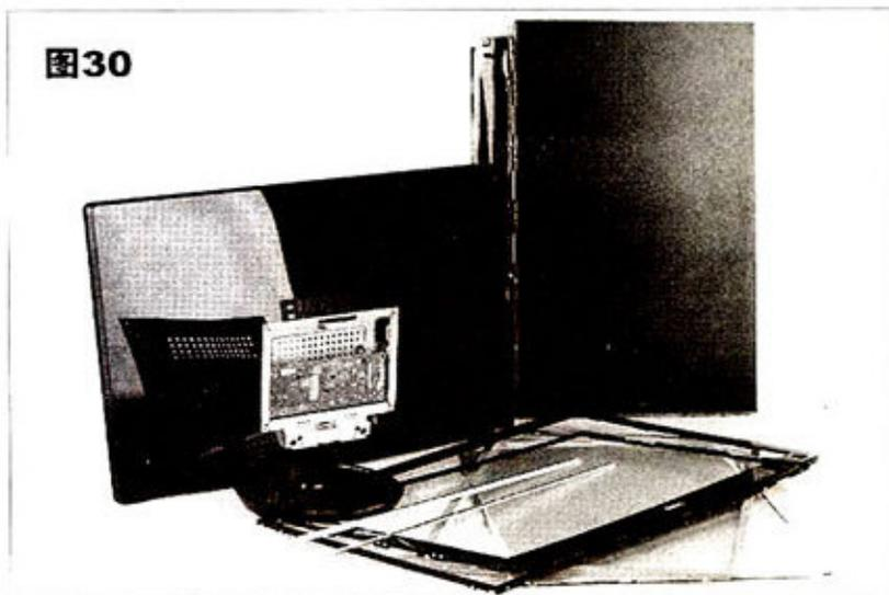
① 拆解完成后的LED背光显示器组件
