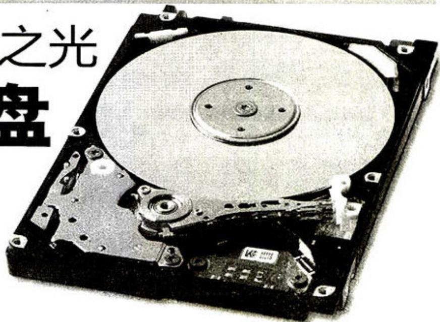
硬盘（以下特指机械硬盘）作为电脑中最主要的数据存储设备，容量和速度一直备受瞩目。在采用了垂直记录技术以后，硬盘的单碟容量从100GB左右飞速发展到600GB。不过随着硬盘磁记录单元体积的进一步缩小和超顺磁效应的出现，硬盘的容量发展遇到了瓶颈。硬盘的最重要参数之一，每平方英寸数据密度的上升空间越来越有限了。
