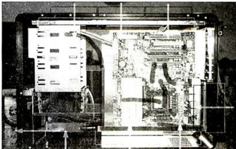
草图毕竟是纸上谈兵,实际安装过程中你很可能遇到之前完全没想到的意外情况。比如说尺寸差一点点装不下,或者原定的安装位难以施工等状况。要尽可能少的做无用功,最好先确定影响整个水冷系统格局的核心大件(比如机箱、冷排、水箱等),再确定规划的细节。
