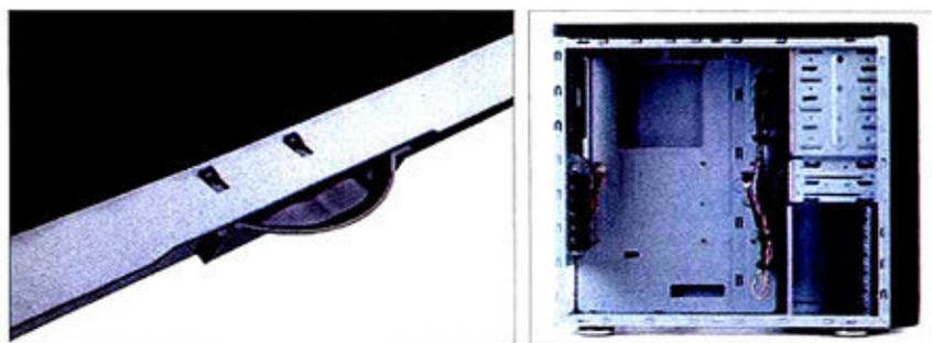
① 侧板覆有大面积隔音棉,尾端的把手设计让玩家开卸侧板更方便。
