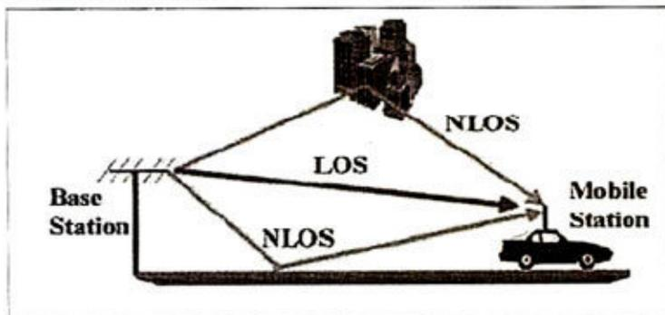
与3G普遍使用的CDMA空中接入技术不同, LTE的空中接入更改为OFDM和MIMO技术。由于无线信号在空中传输过程中会受到外界环境的反射和吸收, 接收机接收到的无线信号是通过不同的直射、反射、折射等路径达到的, 这会造成多路径衰减和干扰, 对于高速移动过程中的通讯, 还存在多普
