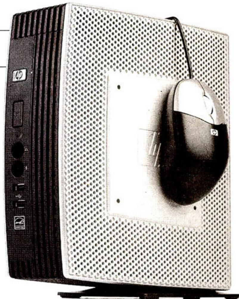
Standard 2009 SP3操作系统,熟悉的Windows界面和操作方式更容易被企业用户接受。而在进入系统之后, T5740提供了包括HP Remote Graphics Receiver, Citrix Program Neighborhood, VMware View Client和Remote Desktop Connection(远程桌面连接)在内的多种后端接入方式,以满足采用不同解决方案的企业用户的需求。不单单是软件方面,在硬件方面T5740也通过提供丰富的接口和扩展槽来提高对企业不同办公环境的适应性。无论是正面的音频和USB接口,还是背后的串口、并口、USB接口,都为T5740外接更多设备提供了可能。再加上T5740可以通过背部VGA和DisplayPort接口实现双屏输出,这样的设置足以满足大多数行业办公用户的需求。
