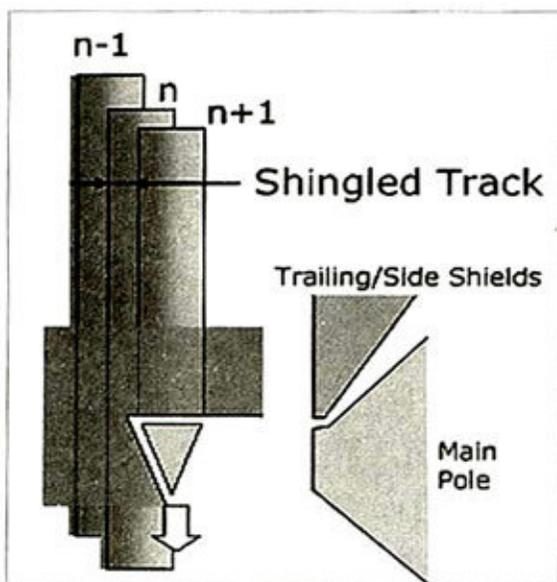
① 瓦记录工作示意图,后写入的磁道恰好覆盖在前一次写入的磁道上。
