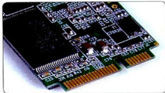
① 源科Mini PCIe SSD上的PCIe接口
