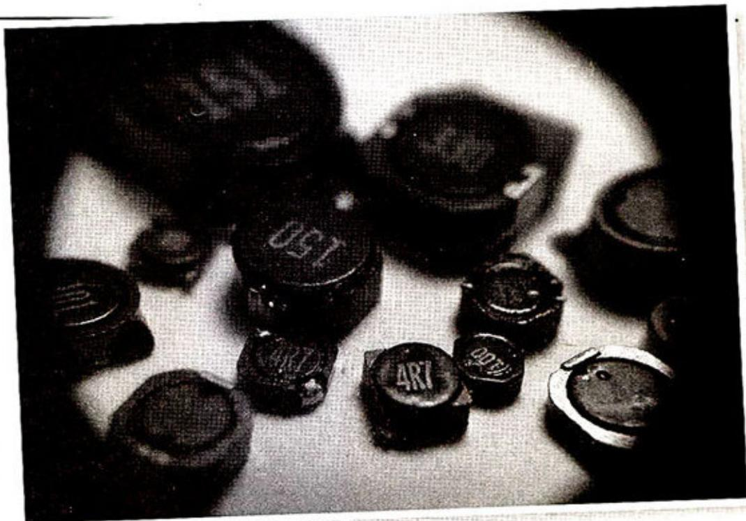
也会下降。在水流流速下降的时候，水车并不能迅速和水流建立新的平衡，它还会按照之前的速度继续旋转一段时间，并带动水流在一定时间内维持之前的速度，然后水车会随着水流速降低、水流减少而慢慢停止转动。正是这种缓和电路中电流的变化幅度的特性，使得电感就像是电路中的一个“梳理者”。
