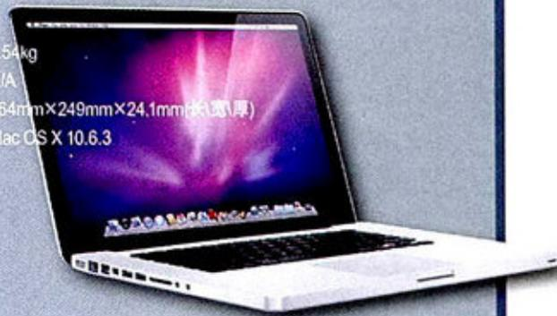
显卡与集成显卡工作模式的切换。不过苹果宣称自己的显卡切换技术是完全不允许用户对驱动程序进行干预，而只是基于侦测耗费图形性能的API运行情况来决定是否切换至独立显卡模式。而Optimus技术则可以让用户通过在驱动程序中设置不同软件的应用模式来决定使用哪个显卡。经测试，在开启Aperture或Photoshop等操作时，Mac OS X系统会自动启用GeForce GT 330M独立显卡；进行邮件阅读、Excel表格填写等操作，Mac OS X系统会启用Intel HD Graphics显卡。
