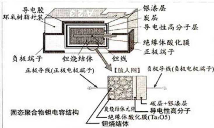
① 固态聚合物钽电容的结构与用料令它拥有更好的导电效率,更低的ESR。
