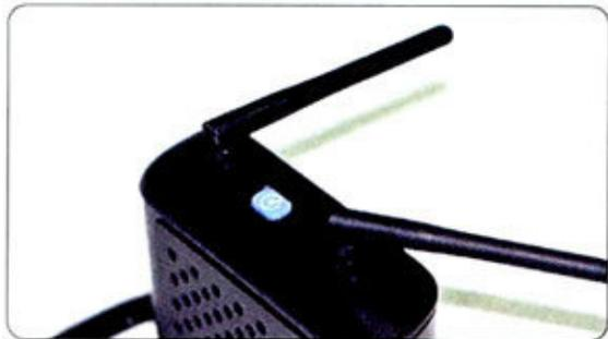
① 绝大多数无线路由器的天线都可以调整。信号覆盖得到了增强，我们还可以配合之前所介绍的调整发射功率的方法，适当降低路由器发射功率。
