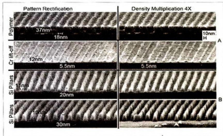
① 在电子显微镜下的晶格介质技术成品硬盘表面，会发现整齐的凸起和凹陷部分。每一个凹凸都代表了一个记录单元。
