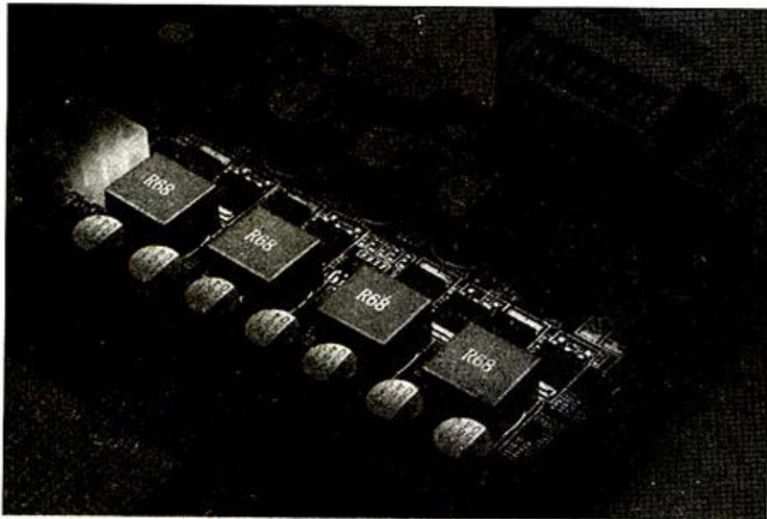
② 铁素体材料制作成的电感，高频下拥有不错的磁导率。
