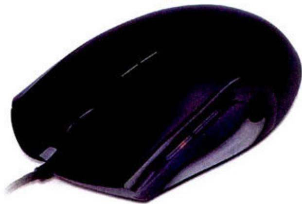
Imperator的中文译名为帝王蟒,它拥有Razer产品的典型特征:类肤材质的上盖、带灯滚轮以及支持呼吸效应的尾部Logo。外形上,Imperator采用非对称造型设计,鼠标左侧提供了拇指凹槽,握持时手型自然,加上其个头偏大,握感饱满。同时,其左右按键采用了欧姆龙微动,敲击手感和弹力均不错,只是左键手感要比右键更为硬朗。另外,Imperator的宽大滚轮具有清晰的刻度感,手感不错。在滚轮的后方还提供了两个DPI值增减键,由于采用独立增减设计,因此在使用时不易出现误操作,只可惜没有提供指示功能。而最与众不同的应该是Imperator的可自定义侧键,除了功能可自定义外,侧键的位置也可以调整。通过鼠标底部的设置键,可对其进行前后位置的调整,以MC评测工程师的使用习惯来说,将侧键调整到最后方显得比较合适,大拇指不用太靠前就可以进行操作。
