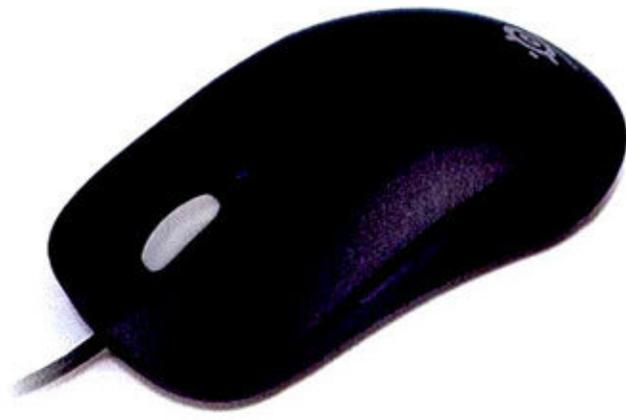
Xai并没有酷炫的外观,也正因为如此,才使得许多玩家对其进行了MOD。造型方面,Xai采用对称设计,并在两侧各设计了两个侧键,如此一来,既可以满足不同用手习惯的玩家,还能迎合他们对侧键功能的诉求。从手感来说,Xai表面的类肤材质经过防滑处理后,触感柔和,其宽大的尾部和修长的身躯可以为习惯“趴”着使用鼠标的玩家提供舒适的握持感。在按键方面,Xai采用了欧姆龙微动,手感硬朗紧凑,弹性和反馈速度都表现不错。同时,该鼠标的白色滚轮拥有较清晰的刻度感,顺畅度较好。滚轮后方的“倒三角”键可以切换分辨率,并通过指示灯进行挡位判断。值得一提的是鼠标底部的液晶屏,长按DPI切换键可以激活显示菜单,通过滚动滚轮可以选择选项,这样就能在没有软件的情况下直观高效地进行参数调整。
