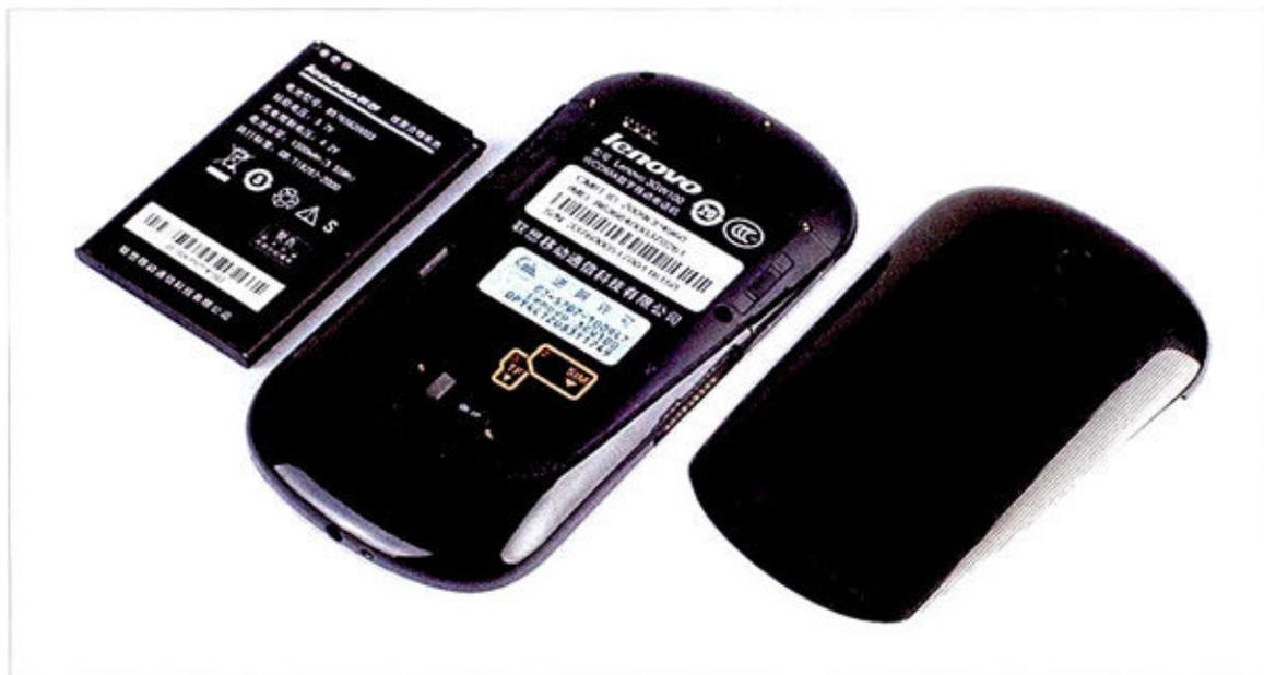
① 乐Phone标配的电池为1500mAh，官方资料显示能在2G状态下通话7.5个小时，在3G状态下通话5个小时，而机身上的多个触点就是用来连接天线和金属后盖的装置。
