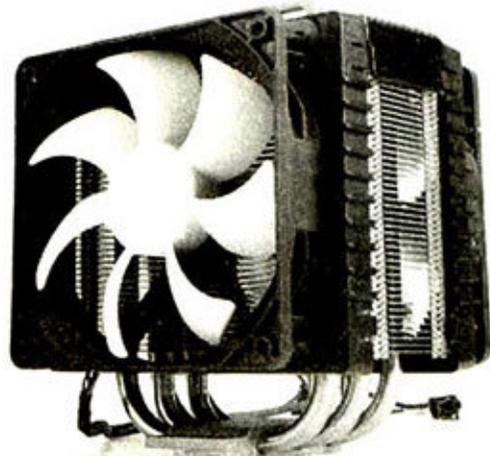
究其原因我们认为一是与各款散热器风扇风量大小有关;二是在于各散热器是否存在漏风现象,漏风即原本应经过散热鳍片,带走处理器热量,并最终从机箱背板排出的气流因各种原因未能达到目的,在半路上就从散热器侧面或下方流出。从理论上来看这显然将对处理器的温度控制造成影响。不过在风量足够大的情况下,损失部分风量则并不会对处理器散热造成太大影响,反而会对周边元件的散热带来有利作用。因此玩家在购买高端散热器前,不能只关注其对处理器的散热性能表现,有条件的话更应测试其周边元件的发热量大小。
