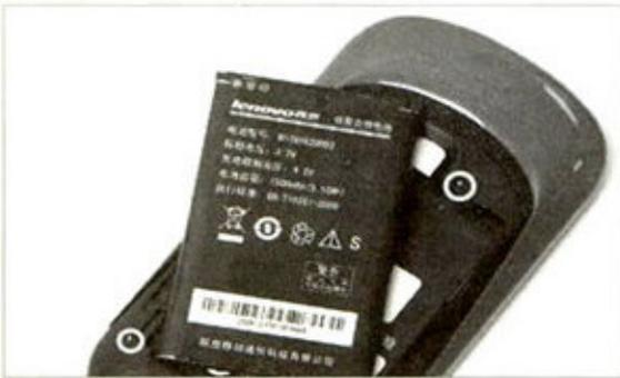
① 图中用圆圈标识的是其中两个与后盖的金属触点
