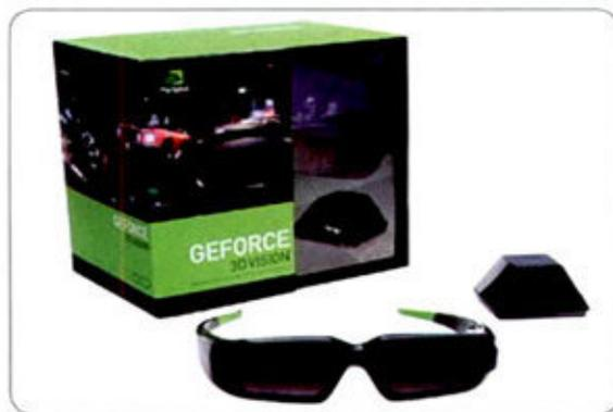
快门眼镜又叫主动快门 (Active shutter) 眼镜，面向个人用户的产品大多采用这一方案，涉足厂商有 NVIDIA、三星、松下以及优派等。其技术核心是左右眼镜的镜片为120Hz液晶屏，可以在不透光或透光两种状态间切换，与信号发射器和120Hz的显示器搭配，当显示器显示左图时，左眼液晶镜片透过，右眼不透过，右图则与之相反。从这点来看，我们的眼睛看到的应该是闪烁的图像，不过这里要感谢我们的眼睛并没有那么强大，一般来说它只能辨别出60Hz以内的闪烁，120Hz对我们的眼睛来说是不会闪烁的持续图像，眼睛把不透过的全黑和透过的图像时间累积成一幅亮度降低的图像。这种方案的成本相对较低，NVIDIA的产品大约为1500
