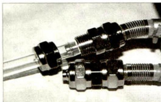
② 快拧接头依靠外圈来压紧宝塔上的水管。有时也会在一些老款产品或者成品套装上看见俗称一分牙的G1/8螺纹。还有些厂商使用更大的G3/8螺纹（三分牙）。不过，如今很多厂商的产品螺纹规格已基本统一为G1/4。
