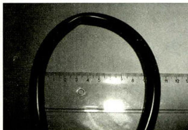
① 薄壁管在弯曲弧度大的时候容易折管,这将严重影响水流量。
