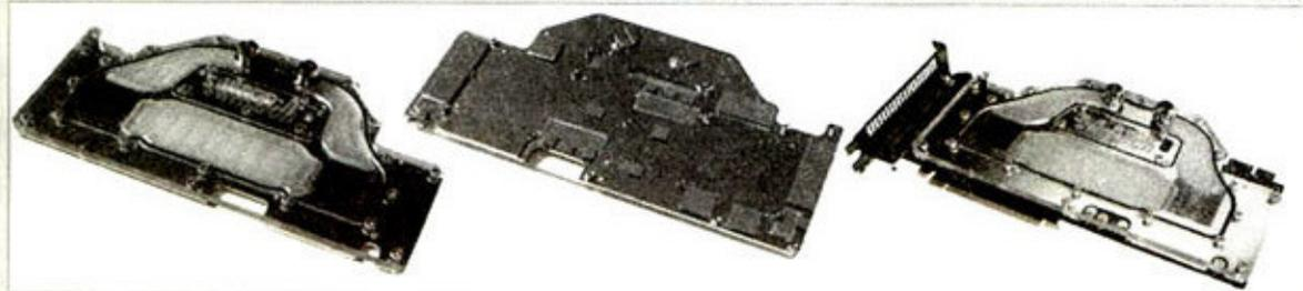
① Swifttech的Epsilon GTX295，为单PCB公版 GTX295设计的全覆盖冷头，照顾到了卡上所有发热较大的部件。
