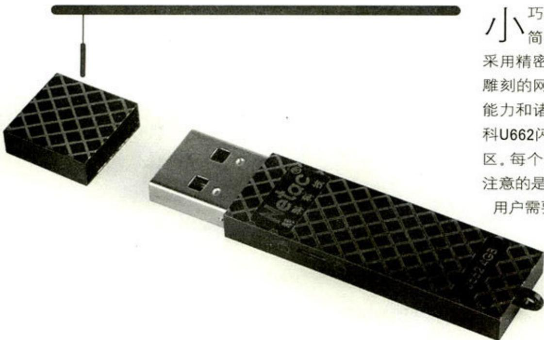
**小**巧精致，就是朗科U662 4GB硬件加密分区闪存盘（以下简称朗科U662闪存盘）给人的第一印象。它的金属外壳采用精密压铸制造，经电镀工艺打造后更加光鲜亮丽。激光雕刻的网格型纹络，显得颇为个性。同时其强大的数据保护能力和诸多的人性化设计则是它内在的精致之处。第一，朗科U662闪存盘分为了三个区，一个未加密分区和两个加密分区。每个分区的大小都可根据用户需要进行调整。不过需要注意的是，调整分区大小时会对整个闪存盘进行格式化操作。
