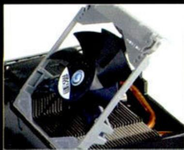
① 工程样品的风扇只有部分可拆卸，正式的产品则可全拆卸。
