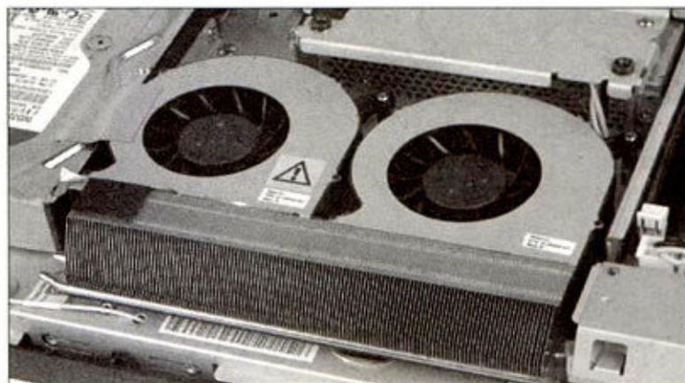
② 扬天E6000I采用热管+双风扇散热系统，很好地控制了机身温度。
