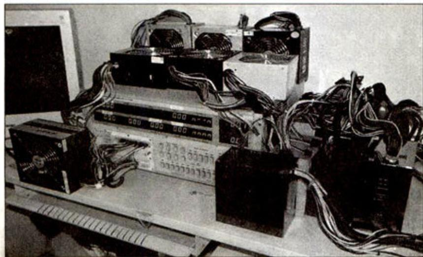
① 使用专门的负载测试仪检测电源
