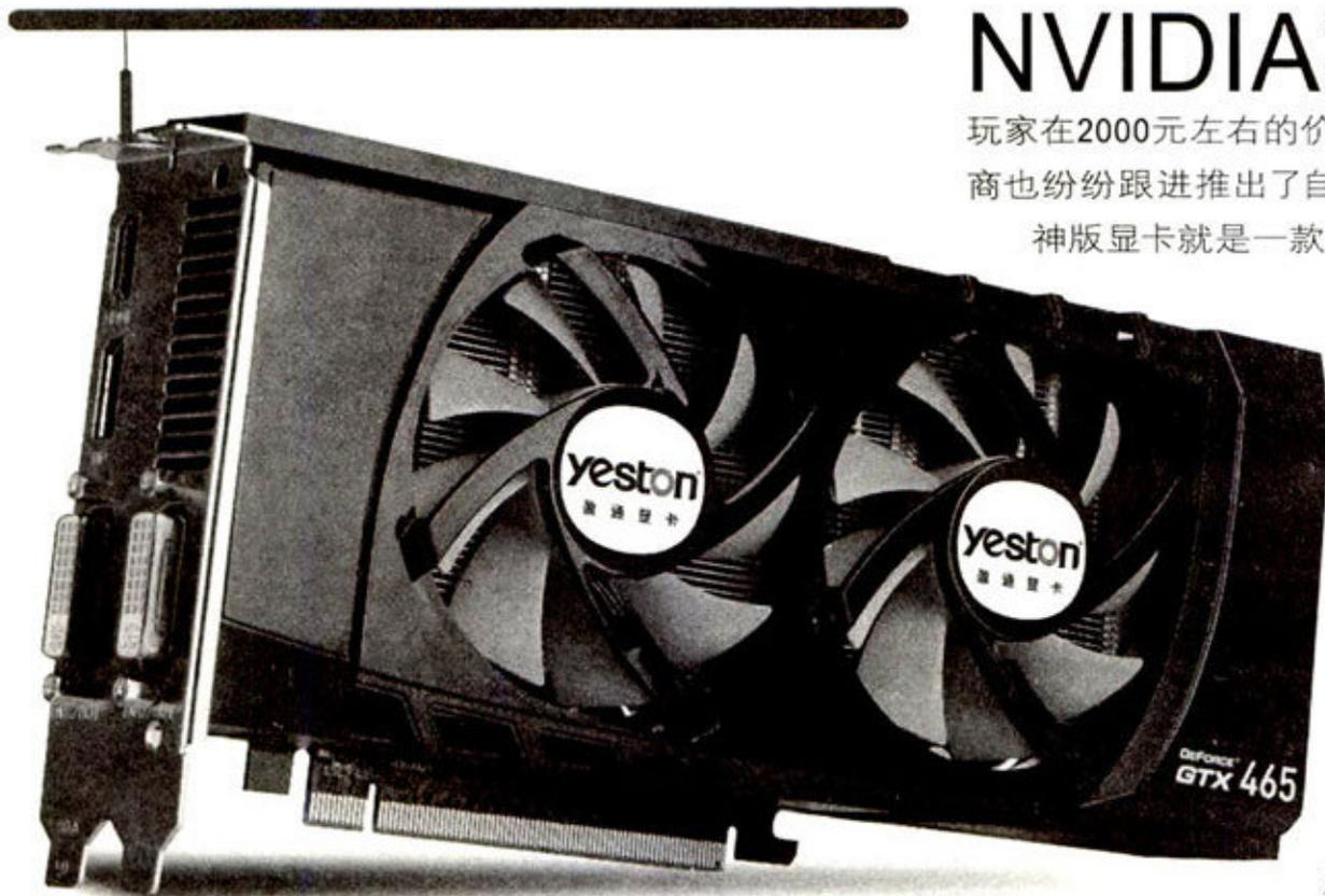
该显卡的核心频率、显存频率和流处理器频率分别为608MHz、3206MHz、1215MHz,和公版保持一致。它采用4相核心、1相显存的供电设计,核心PWM芯片采用安森美NCP5392(最大可控制4相供电),全部使用三洋SEPC固态电容。虽然它的供电相数和公版保持一致,但是它每相核心供电搭配了4个“两上两下”的MOSFET,整个核心供电部分合计16个MOSFET(公版的核心供电只有12个MOSFET),可以进一步分摊
