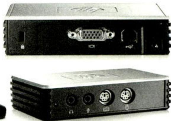
① 瘦客户机除了通过USB接口连接主机以外，其两面的接口分别用于连接显示器、键鼠、耳机和麦克风，不需要网线连接，更加简洁。
