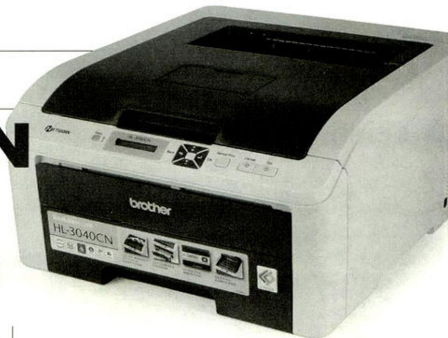
可以将彩色打印的速度提高到与黑白打印相同，因此成为目前彩色商用打印机必备的技术。而使用LED打印技术的环保优势在使用时可以直接体验到：我们发现，兄弟HL-3040CN工作时并不像普通激光打印机那样会产生刺激性，让人非常不舒服的气体，对于办公室白领来说，更加环保健康。除此之外，LED打印技术还有减少机械构件数量，提高设备稳定性的好处。
