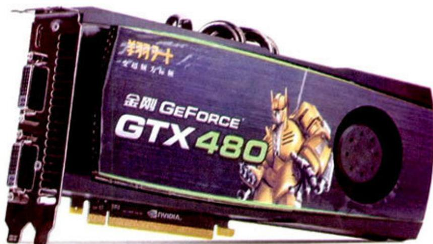
翔升金刚GTX480 1536M D5是一款采用公版设计的GeForce GTX 480显卡，核心频率、显存频率和流处理单元频率分别为700MHz、3696MHz和1401MHz。该显卡的附件比较丰富，8Pin转接头和Mini HDMI接口转HDMI接口的设备一应俱全，附加值较高。
