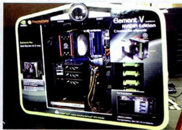
◆ Element V NVIDIA版机箱,主要是为GeForce GTX 480三卡SLI强化了散热设计,增加了带风扇的显卡导风罩。
