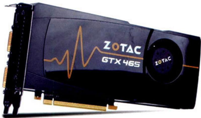
该显卡由柏能科技代工, 在P1025公版PCB方案的基础上对部分元器件进行了优化, GPU待机温度满载温度分别为46°C和88°C。索泰对该显卡提供3年免费质保服务。
