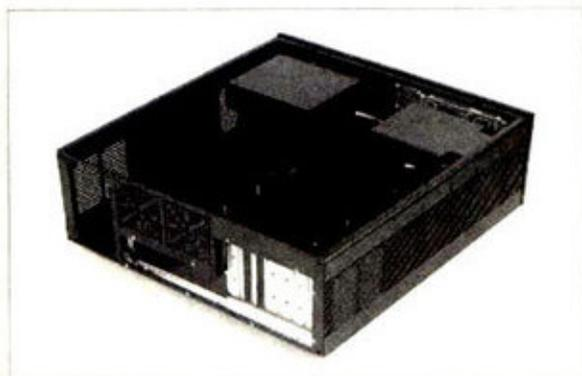
① 打开机箱顶盖,依照将要安装显卡的位置去掉扩展槽挡板。底板上预装的铜柱刚好适合标准ATX主板;如果安装Micro-ATX主板就还要安装额外的铜柱。
