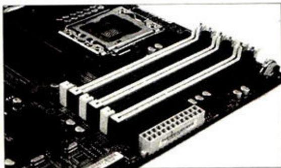
只能将单根内存插在X1或者Y1上面，X1为第一组内存通道中远离处理器的那根内存插槽，X2为第一组内存通道中靠近处理器的那根内存插槽，以此类推。此外还必须遵从以下法则：
