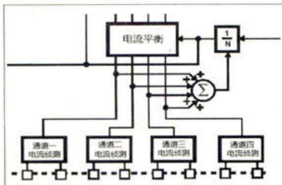
① 图2 电流平衡控制
