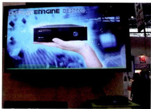
◆ 别小看了迷你电脑。这台Aopen DE7000 1.3L迷你电脑采用Core 2 Duo处理器和使用MCP7A-LP芯片组的主板，集成的GeForce 9300显卡，配置不弱，播放3D高清视频完全没问题。
