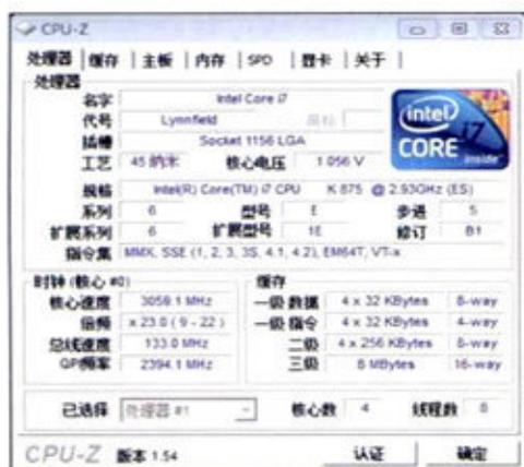
**测试手记:** 很多出厂较早的主板无法开启Core i7 875K的倍频调节功能,但是在更新新版BIOS之后一般都可以打开倍频调节选项。依靠调节倍频我们就可以将处理器超频到4GHz,甚至更高。
