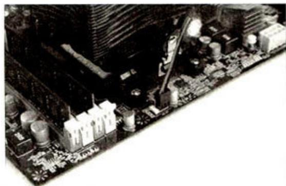
① 在主板装入机箱之前,建议先把CPU、散热器和内存安装好,并把散热器的电源线接好,否则在机箱内操作会不太顺手。
