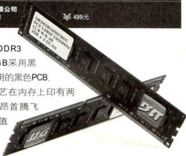
的眼睛位置，内存还配备了两颗LED指示灯，在工作时会发出绚丽的红光，让它看上去更加耀眼。除了漂亮的外表，这款内存拥有良好的做工。它采用8层PCB、双面16颗设计。同时，它还具备金邦内存特有的DBT动态高温老化技术，在出厂前经过严格的品质测试，增强了内存工作中的稳定性。
