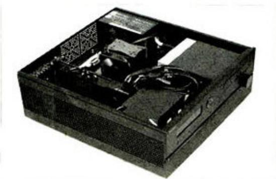
⑤ 最后插上显卡,装回光驱架和硬盘架,连接好各个设备的电源线和数据线,并整理线材就完成了这套HTPC平台的安装。
