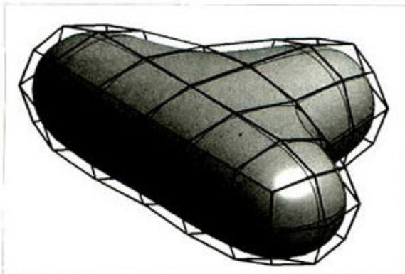
① 在电脑眼中，图形就是由顶点坐标组成的框线，顶点越多，画面越精细。
