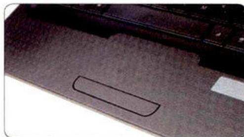
① 一体化设计的腕托和触摸板, 触摸板比较靠近键盘, 容易误操作。
