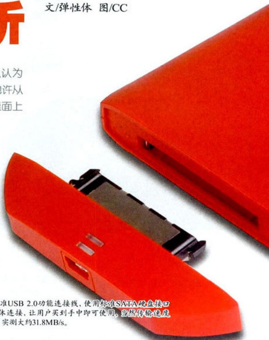
① 原配标准USB 2.0功能连接线,使用标准SATA硬盘接口与硬盘本体连接,让用户买到手中即可使用,当然传输速度要慢一些,实测大约31.8MB/s。
