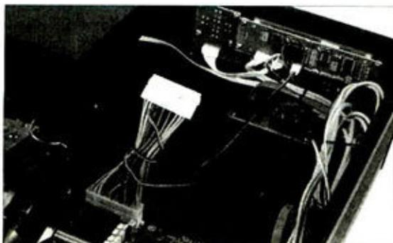
④ 把主板装入机箱之后,一定记得要使用附件中提供24Pin转接线,将分离的2Pin供电线连接到LCD监控电路板上,这样才能正常使用机箱的LCD监控功能。
