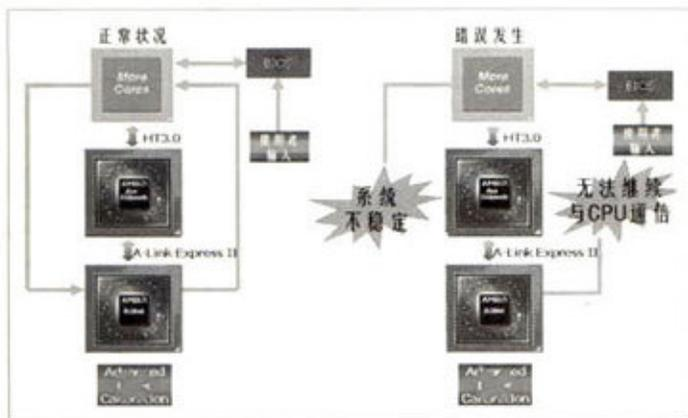
① 软件开核原理示意图显示一旦发生开核失败，即可能造成系统彻底死机。
