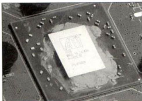
☉ Radeon HD 5670 640SPU的GPU核心
