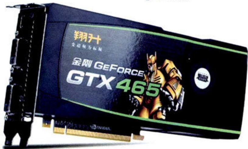
该显卡采用P1025公版PCB方案，采用4+1相供电设计，PCB正面具备8颗规格为128MB/32-bit的GDDR5显存，组成1GB/256-bit规格。该显卡附送了Mini HDMI转HDMI的转接线。
