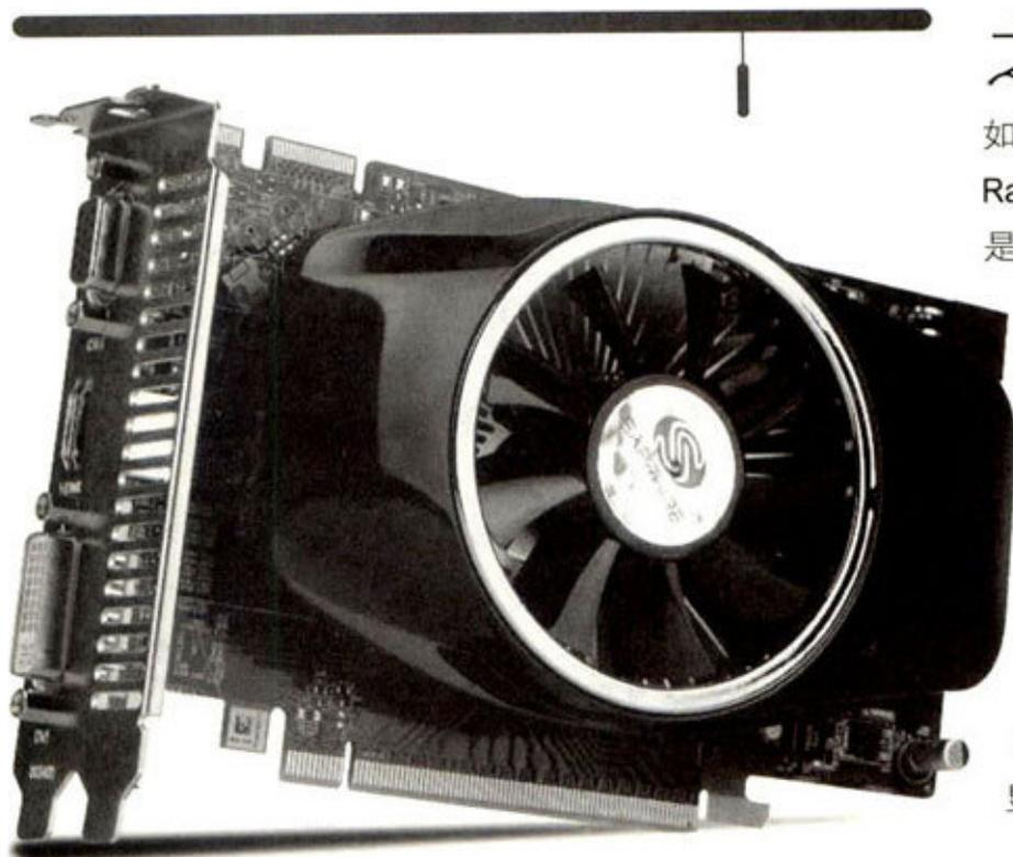
之前AMD曾经推出过一款名为Radeon HD 5670的中端DirectX 11显卡。SPU (流处理算术逻辑单元) 为400个。如今为了提升产品的竞争力，AMD推出了具备640个SPU的Radeon HD 5670。和HD 5670 400SPU采用Redwood核心不同的是，HD 5670 640SPU采用简化版的Juniper核心，具备八组SIMD阵列 (一组SIMD阵列包含16个SP (流处理器)，一个SP包含5个SPU) 和640个SPU (8×16×5)。它的核心频率、显存频率分别为750MHz、4000MHz，核心频率比HD 5670 400SPU的775MHz稍低。在价格方面，AMD建议该产品的价格不低于649元。
