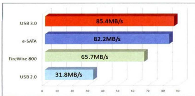
① 上图为使用GoFlex Pro的测试成绩,可以看到USB 3.0的传输速度最快, e-SATA大致相当,二者均高于FireWare 800与USB 2.0。事实上,传输速度还与使用的存储介质有莫大关系,如GoFlex Desk的速度要优于GoFlex Pro,后者还要优于普通GoFlex。总之,内部存储介质(硬盘)的传输速度越快,越有利于USB 3.0等接口的速度发挥。
