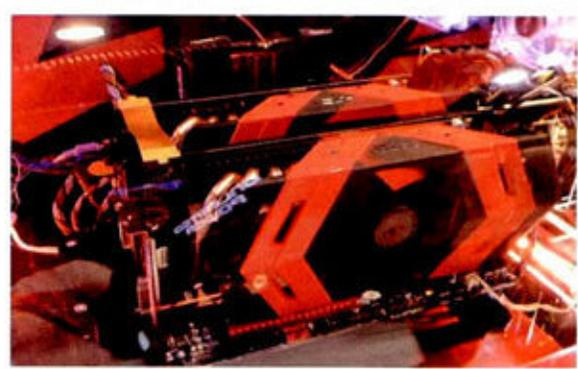
◆ Ares战神显卡的大型风扇能产生6倍于公版风扇的风量,无氧纯铜打造散热鳍片是保证正常工作的关键。
