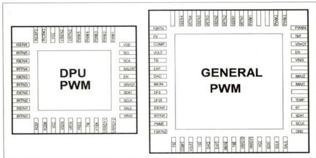
图8 PWM控制器引脚比较
