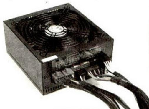
① 在安装电源时,只选用必要的模组线材,节省机箱内部空间。笔者只用了24Pin主电源线、4+4Pin供电线、一根SATA线和两根PCI-E 6+2Pin线。
