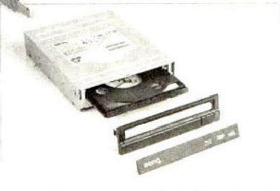
① 由于机箱自带光驱挡板,因此BD光驱在安装前要先卸下舱门。
