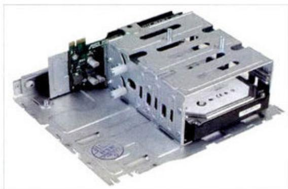
华硕TS mini提供了两个3.5英寸硬盘位，安装时只要将硬盘插入后就会自动固定。
