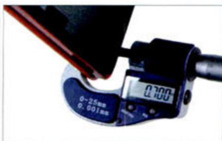
① 机箱侧板的实测厚度为0.7mm,属于中端机箱的用料水准。
