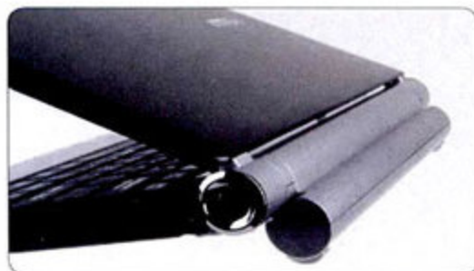
① 6芯大容量电池采用了L型设计,因此U160放在桌上使用时机身底部与桌面之前有一定的倾角,对使用键盘的手感和散热都有一定的好处。
