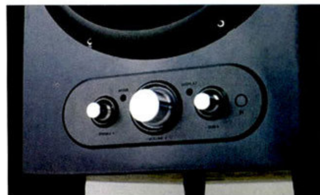
① 低音炮面板下方分别是高音、主音量及低音旋钮, 但在有遥控器的前提下, 这几个旋钮的作用就不明显了。
