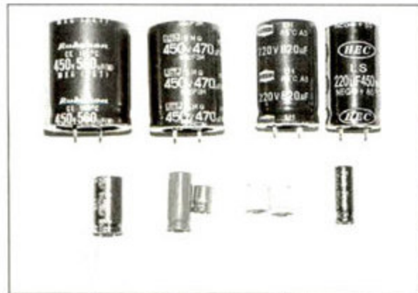
① 电源的高压滤波电容（上排）和低压滤波电容（下排）
