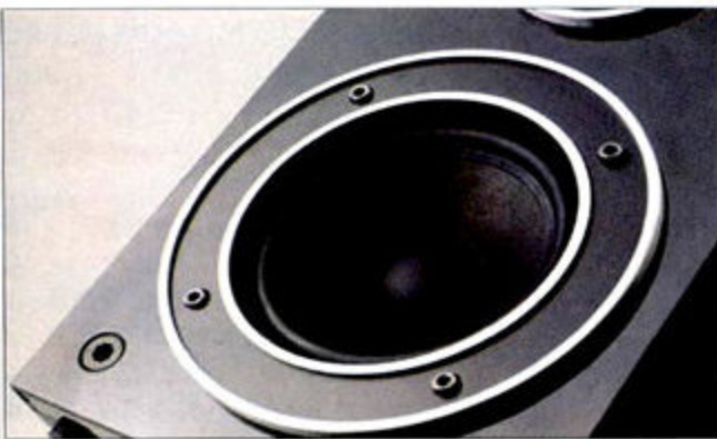
从G010的1英寸丝膜高音单元和4英寸中音单元来看, 它的卫星箱实际是按照2.0标准来设计的。
