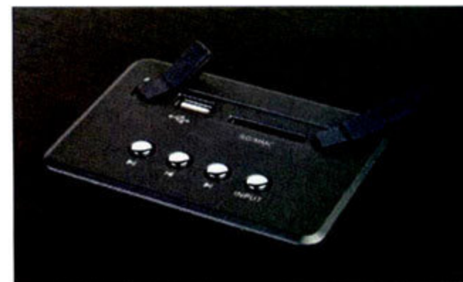
① 低音炮顶部的USB接口、SD/MMC插槽, 以及直读播放控制按键。比较人性化的是, 卡槽上还设计了防尘胶皮。
