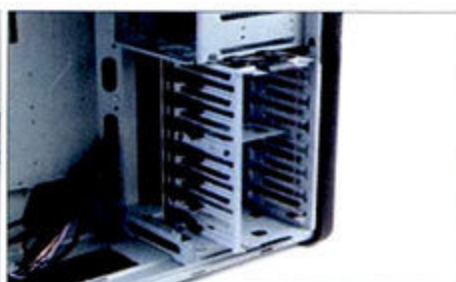
① 硬盘架可以整体拆卸下来,并转向90°安装。
