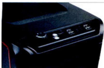
① 顶部前端的风扇调速器是Tt元素火“环保版”机箱的一大特征
