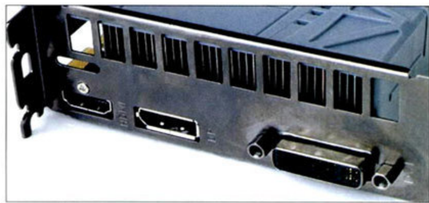
① 工程样品采用DVI+Mini HDMI+Displayport接口，正式版本会和公版保持一致。
