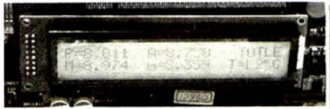
① 该测试仪可对显卡平均功耗、实时功耗、最大功耗进行测量。
