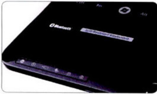
① 状态指示灯集中位于机身前端左侧,而需要随时观察的大小写切换状态灯在最靠右的位置,使用键盘时也能观察得到。
