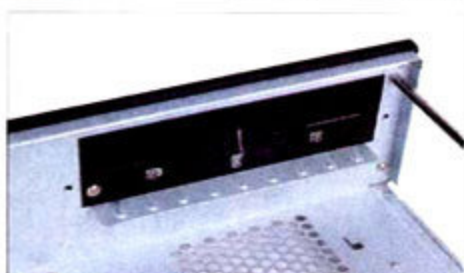
③ 光驱接口的位置设计了大量的EMI触点, 增加机架与光驱的接触, 更好地形成封闭的电磁屏蔽环境, 减少电磁辐射。
