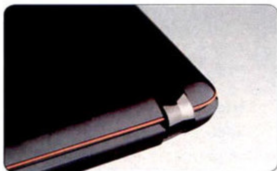
① 盾形镜面漆金属转轴裸露在顶盖上
