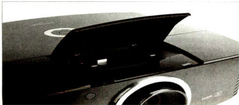
① 丽讯H5080的镜头位移按钮被放到了机身顶部的一个内凹的隐藏仓内，用户调节时，只需在机身顶部轻轻一按，弹开舱门即可调节，轻松方便。
