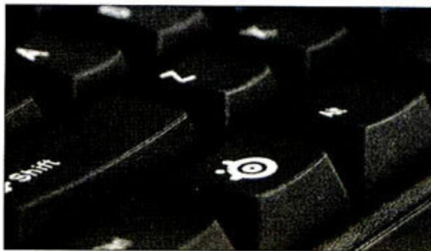
② 采用激光填料技术之后，可以很轻易地在黑色的键帽上烧出白色的字符。
