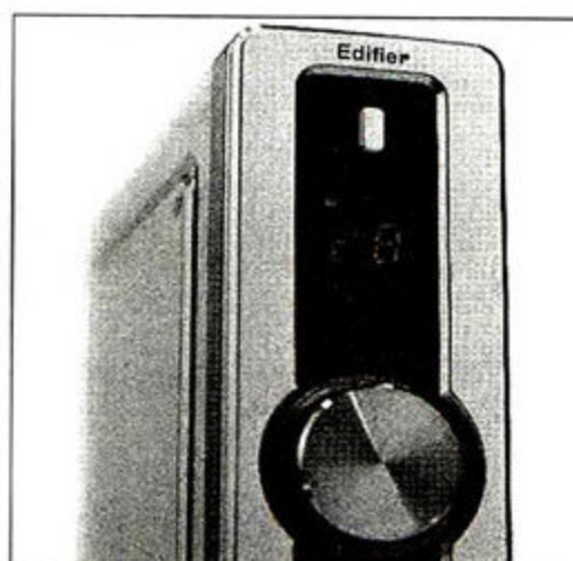
② 功放盒面板上半部分是待机切换开关和屏显，需要注意的是，按下待机开关并没有切断电源，用户如遇长期外出，则应关闭功放盒背部下方的总电源。
