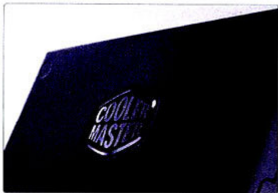
① 外壳采用喷砂阳极化处理，手感也不错。
