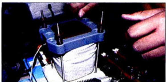
④ 然后在“大炮”上安装扣具,并转紧相应螺丝即可。
