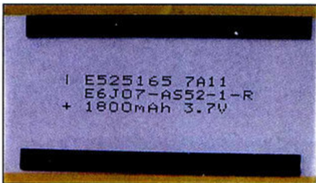
① 汉王电纸书N618使用了一块3.7V 1800mAh的锂电池, 大约可以为整机提供4000次翻页所需的电量。
