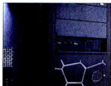
① 隐藏的前置接口，两个USB 2.0接口被设计在两侧，这样不会出现同时插入USB设备冲突的情况。
