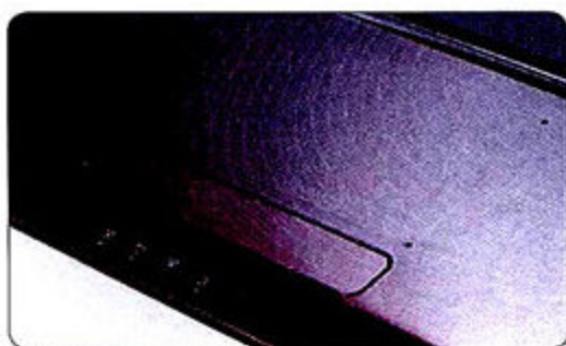
① 真正与腕托融为一体的触摸板, 四个角的蓝色LED灯就是触摸板边界的提示。
