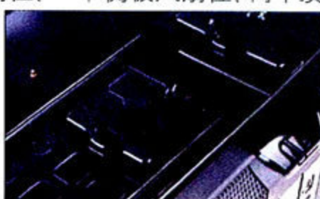
① 光驱位、软驱位、硬盘位均提供了一个免螺丝工具, 装卸方便, 如果能提供更多的免螺丝工具就更好了。
