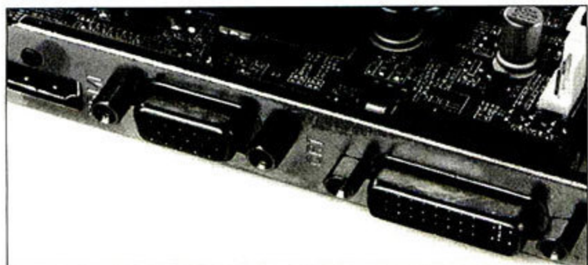
① 挡板经过了镀镍处理，接口进行了金属全屏蔽防护。
