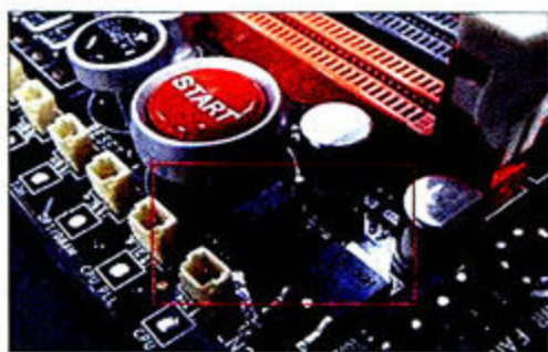
① 为减少遭遇Coolbug，在使用这款主板进行极限超频时，应将跳线模式设置为LN2 Mode即液氮模式。
