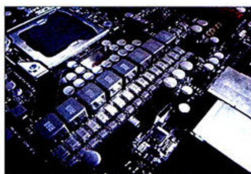
① 处理器供电部分采用大量DirectFET MOSFET
