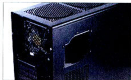
① 丰富的风扇预留位, 背板还提供了水冷孔。
