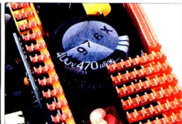
① 硕大的470uF主电容，隐藏在铝挤F型多凹槽式散热片下。
