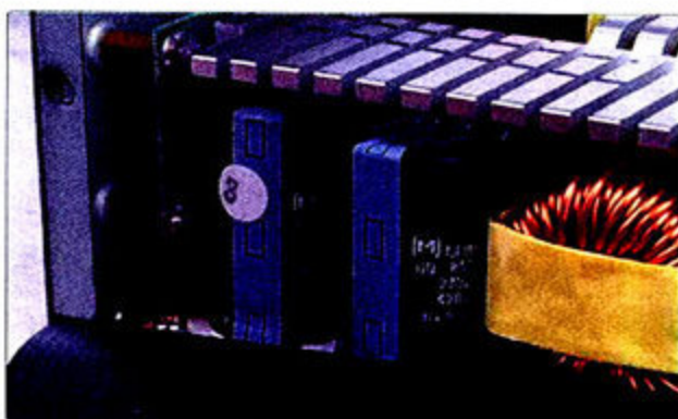
② 采用两颗270uF主电容，散热片相当厚实。
