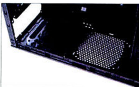
① 电源下置设计, 并且电源风扇的通风孔加装了防尘网。
