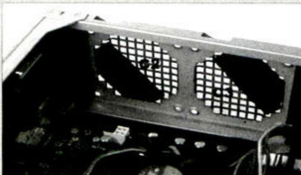
① 图11 C2和C3通风口用隔音棉遮挡了一半(其厚度被削减到了2.5mm),能够有效降低风噪。
