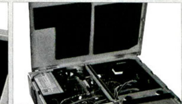
① 图12 侧盖板的隔音棉需要精确地裁剪,否则会盖不上。其中盖板上的通风口已经被完全封堵,有效阻隔了噪音。
