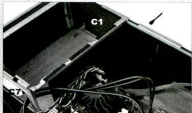
① 图8 C1通风孔用隔音棉完全封堵,阻止了硬盘噪音的外露。
