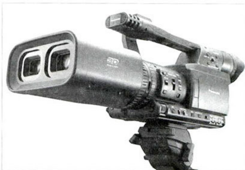
① 图4 松下的双镜头摄影机AG-3GA1,可以满足电视转播的需要。
