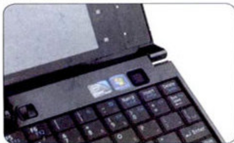
① 在U1010/2010上非常经典的富士通U系列超便携电脑的方形指点杆。这里告诉大家一个秘诀——使用这根指点杆一定要轻，包括进行双击或单击操作时一样，只需要轻点即可完成，用力过大一定会造成光标的漂浮。
