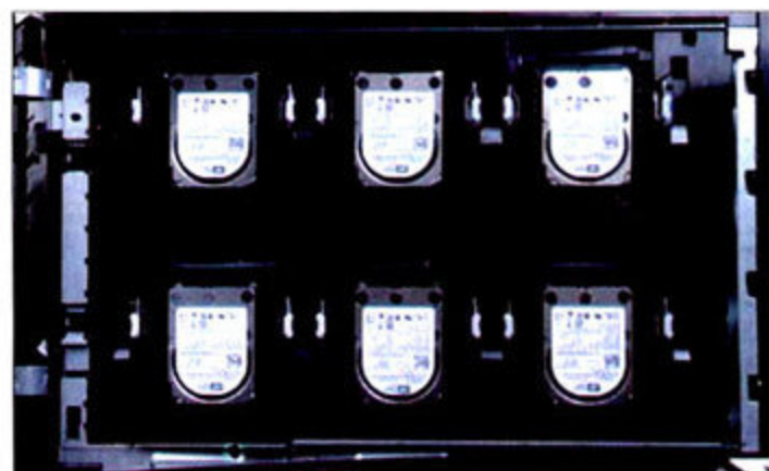
① 放置在背板位置的硬盘采用无线绳免工具拆卸支架安装
