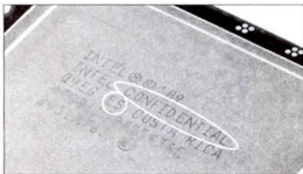
① 英特尔ES处理器的识别方法很简单,若金属背壳上刻有“CONFIDENTIAL”、“ES”字样,并且没有标明具体型号,那么基本上可以确认为ES版本。
