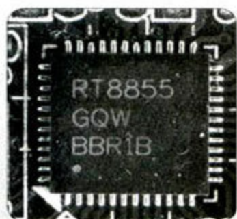
图4 Richtek是我国台湾省的PWM芯片生产厂商,产品大量被应用在主流产品中。其PWM芯片特征是产品型号前面一定会有“RT”字样,比如图中RT8855就是一款典型的四相模拟供电芯片。
