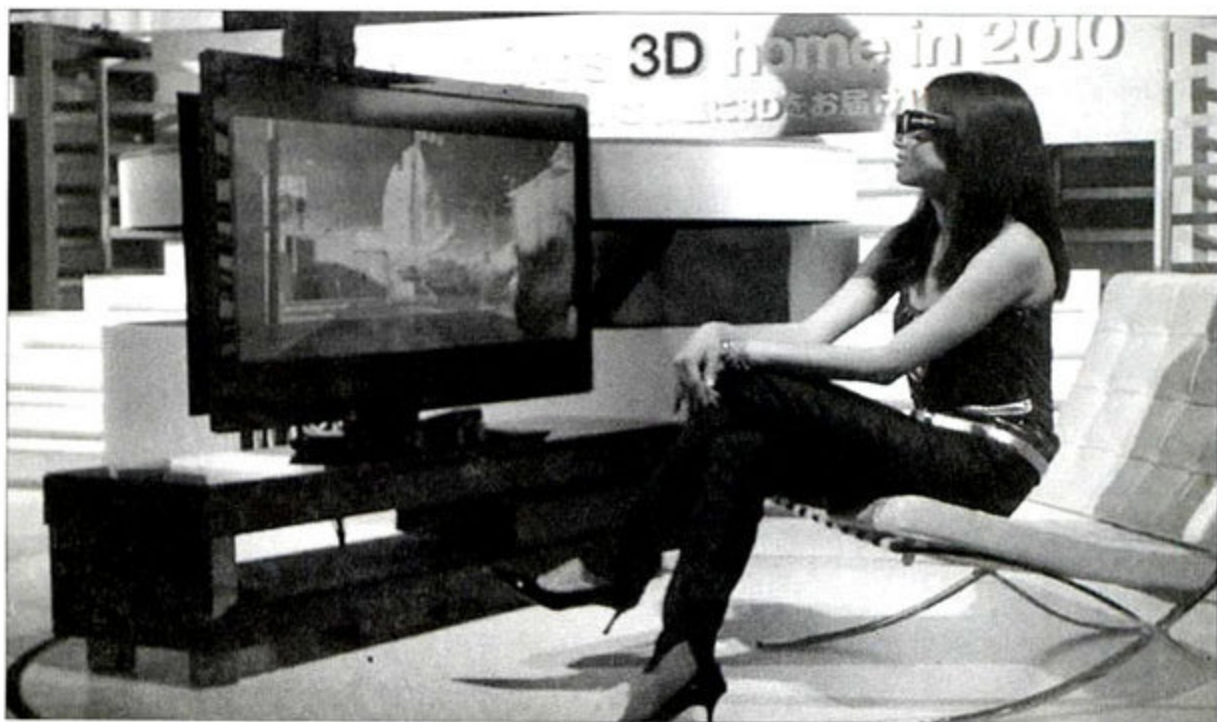
图10 索尼即将推出的3D电视系统,观看者需要佩戴专门的眼镜,其技术方案与XpanD影院系统相类似。数字-模拟(基站-机顶盒)-模拟-数字(3D电视机)的反复转换,你可以想象,再优秀的算法也难以抵消信号的失真。
