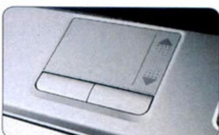
① 优雅A500-i3的触摸板手感不错,而且滚动条位置还设计了单独的区隔,可以防止误操作。锋锐K46A(左)的触摸板面积宽大,定位准确,只是表面过于光滑,在手指有汗时移动不便。
