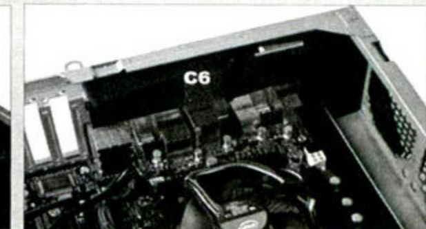
① 图10 C6通风口被隔音棉遮掩了一半,余下部分用透气海绵覆盖。
