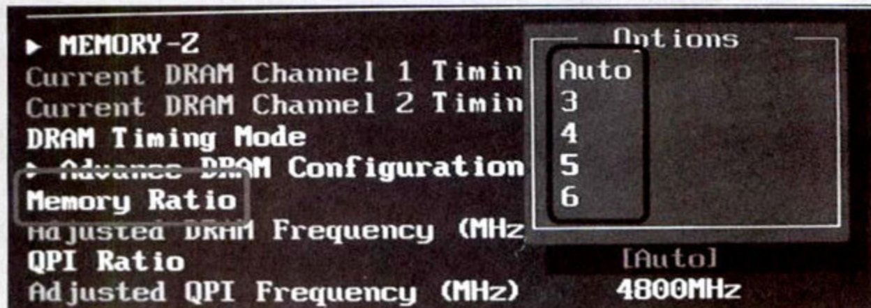
① 在使用Core i7处理器+P55主板时，BIOS中的内存分频选项。
