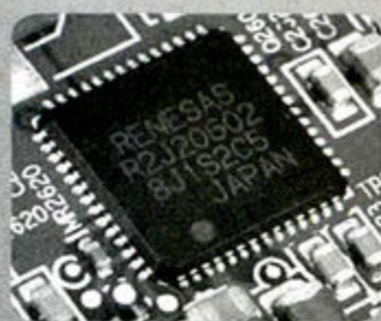
图6 RENESAS中文名称为瑞萨,是日本的电子产品公司。RENESAS的PWM芯片的特点是在芯片表面会打上公司的名称,比如图中用于公版Radeon HD 4770显存供电的一相PWM就直接打上了RENESAS的字样,另外,RENESAS的这颗PWM也集成了MOSFET的驱动在内,因此体积相对较大。
