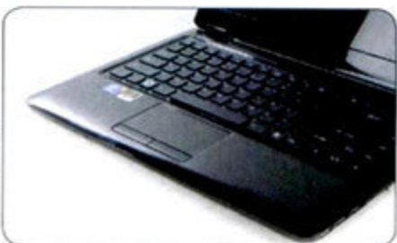
① 锋锐K46A(左)的C面也采用了膜内漾印技术,虽然容易沾染指纹,但质感相对更好一些。
