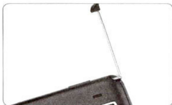
TD30t的触控笔同时又是CMMB信号接收天线。
