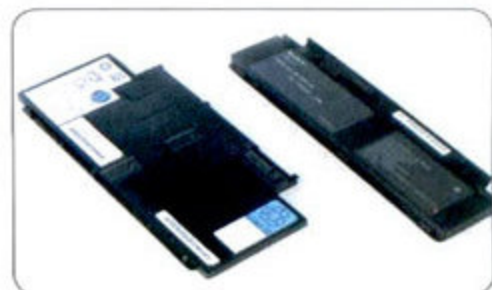
① 电池比较：平板式的锂聚合物电池也是UH900得以“小型化”的重要因素。
