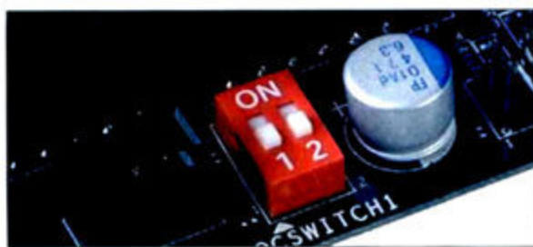
① 通过易超频开关,普通用户也可轻松将处理器超频至3.6GHz。
