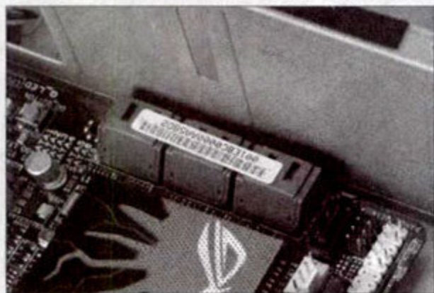
图4 主板SATA接口与硬盘仓挡板过近，普通数据线无法插入。
