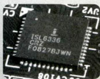
图5 Intersil是一家著名的美国PWM厂商。其产品品质优秀、功能丰富,比如常见的自动供电相数控制功能就被广泛采用在Intersil公司旗下的PWM产品中。目前Intersil的PWM产品主要用于中高端、主打超频功能的主板上。Intersil产品的特点是PWM芯片上有一个大大的LOGO“i”,这也是它区分与其它家产品的重要标志。
