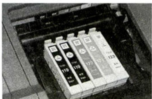
① 双黑墨盒配置是ME OFFICE 1100进行高速黑白图纸输出的保证
