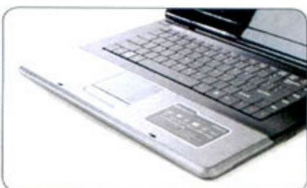
① 锋锐K46A(左)的C面也采用了膜内漾印技术,虽然容易沾染指纹,但质感相对更好一些。
