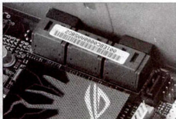
图5 采用“L”型数据线，并将其削薄后方能安装。
