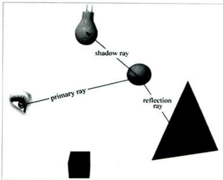
图4 光线追踪原理示意(primary ray: 监察光线; reflection ray: 反射光线; shadow ray: 阴影光线)。
