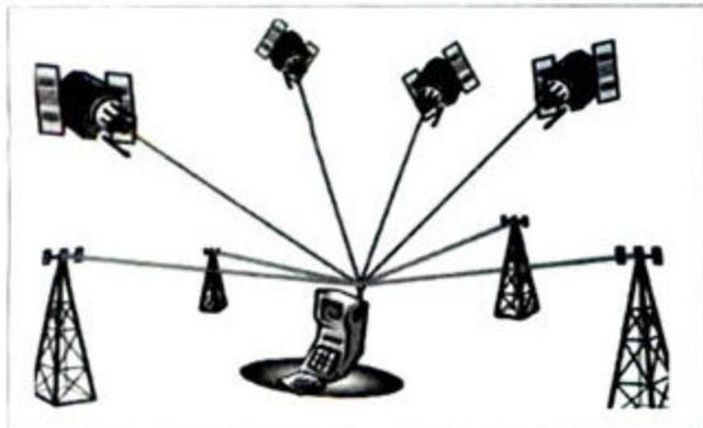
① 手机利用A-GPS技术定位的示意图
