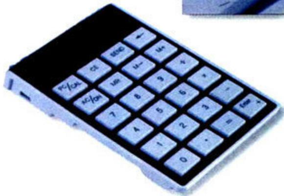
**测试手记:** K100U计算器不仅可以搭配K1100U键盘使用,还可以直接接入电脑,当作独立的数字键盘使用,这种应用方式对财会人员很实用。
