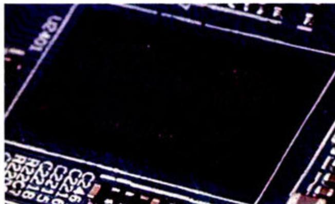
① 蓝宝石HD5570 1024MB DDR3正反共具备八颗规格为64M×16bit的三星SDRAM DDR3显存。
