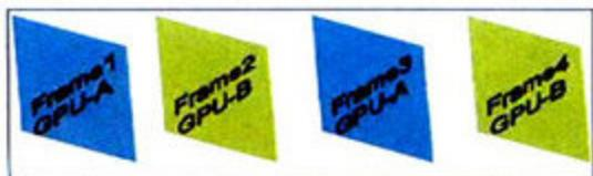
分成两部分，一个核心渲染上半部分的画面，另外一个核心负责渲染剩余部分，然后通过PCI-E总线将从卡数据传递到主卡，并且合成出完整画面。一般来说，AFR渲染模式能更明显地提升3D运算性能。而SFR的兼容性更好，但由于3D游戏画面的渲染负载划分不易做到平均，可能存在上半部分渲染内容偏少，下半部分渲染内容过多的情况，因此SFR渲染性能不及AFR。
