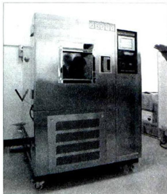
会通过5%浓度的盐水和盐雾测试机进行8小时~10小时的腐蚀测试，看这些元件表面是否会出现氧化生锈的痕迹，如果出现锈蚀现象则视为不合格。同时，鼠标还会经过老化测试，在65℃的温度下，需要正常工作168小时。如果是新产品新方案，测试时间会更长，一般会三个月。经过严苛的测试之后，产品品质才会更有保障。
