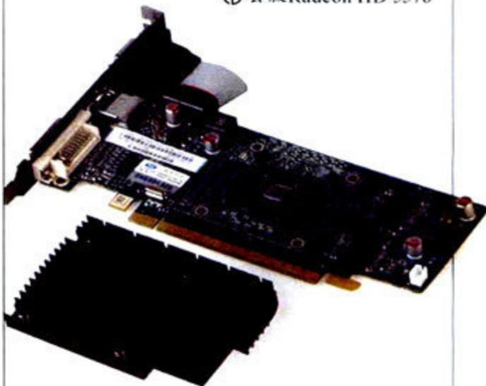
① 蓝宝石HD5450 512MB DDR3也采用了刀版设计，接口为DVI+VGA+HDMI。由于该显卡的核心规格很低，因此只搭配了黑色铝制鳍片进行散热。此外，1+1相的供电设计也完全能够满足该显卡的需求。
