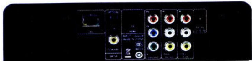
背部接口非常丰富,从左到右分别是LAN、SPDIF光纤/同轴、HDMI、分量输出、AV OUT、AV IN和电源接口。而机身侧面还设有两个USB,一个方形USB和一个多合一读卡器接口,可以很方便地与移动硬盘以及其它多媒体设备连接。
