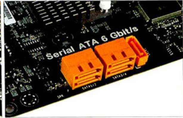
③ C. 主板上5个SATA 6Gbps接口，还有一个通道被放置到了后部的eSATA接口。
