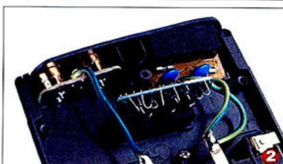
② 电话、网络和有线电视的接口也有各自的MOV和保险丝。
