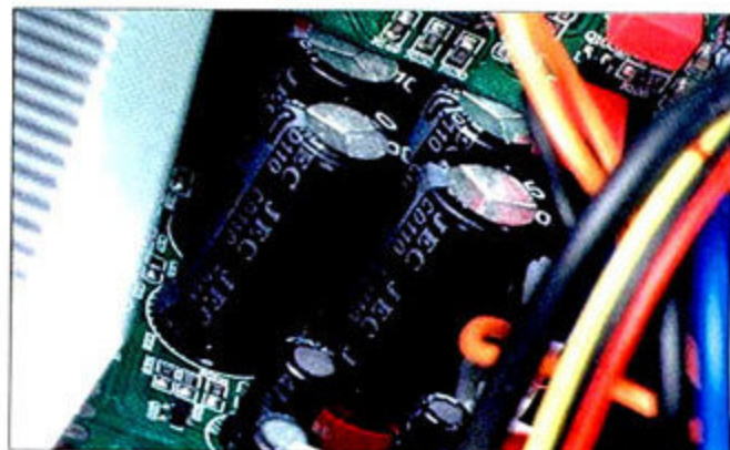
⑤ 四颗1000uF的滤波电容并联构成了4000uF的总容量
