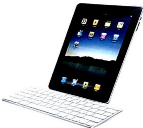
① 键盘底座不仅可以用于iPad充电, 还能作为外接键盘使用。
