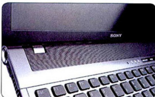
① 圆柱形中轴得到了进化,与下沉式转轴进行了结合,这种设计更适合大尺寸机型。
