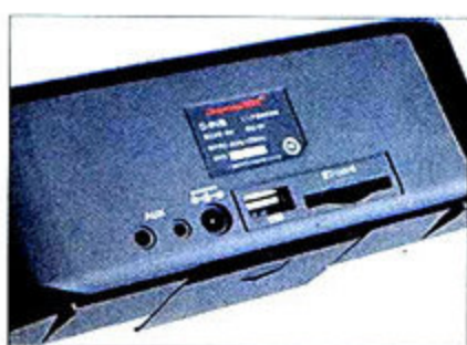
① 机身背部的接口，依次为3.5mm和2.5mm AUX输入、电源接口、SD卡U盘和SD卡接口
