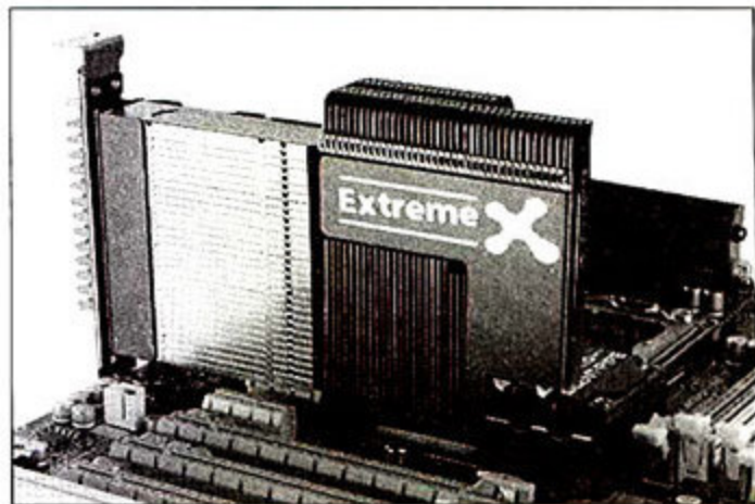
① 技嘉X58A-UD7配备了独有的“Hybrid Silent-Pipe”的双热管辅助散热槽
