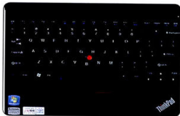
① 为了保证键盘和触摸板的手感, X100e的C面设计煞费苦心,不但采用了6行键盘设计,而且触摸板的左右按键位于机身边缘,以最大化利用空间。
