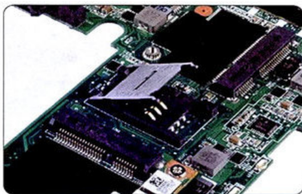
① X100e主板上提供了2组Mini PCI-E插槽和SIM插槽,并预留了天线,可以提供更丰富的无线网络连接。
