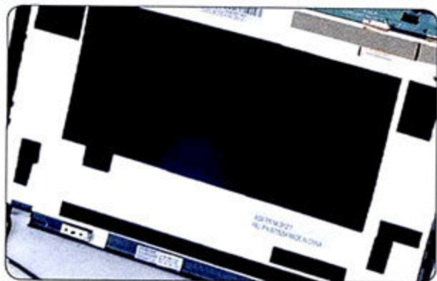
① 顶盖内侧设计了泡沫材质的薄垫,可以起到缓冲保护作用。
