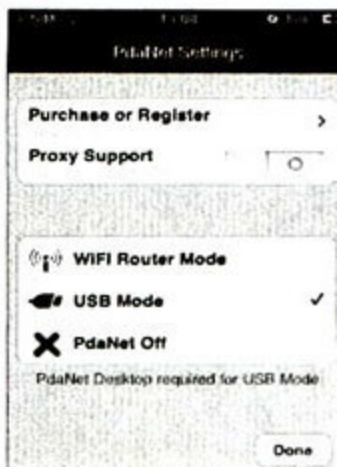
① 如果电脑不支持Wi-Fi连接,那么也可以用USB数据线与iPhone与之相连,在此之前请先将iPhone上的PdaNet软件设为USB模式。
