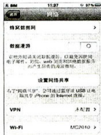
① 在iPhone的“设置”→“通用”→“无线网络”下启用“网络共享”功能(需要插入联通3G USIM卡才会出现该选项)
