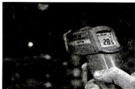
① 本测试中MOSFET、北桥芯片和南桥芯片的温度，是指用红外线测温仪测得其散热片的最高温度。
