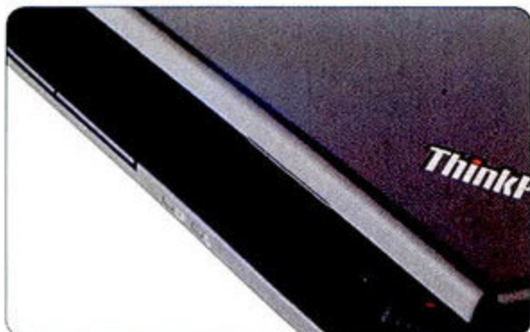
① 虽然显示屏顶部设计了一个用来帮助打开显示屏的条状“把手”，但由于转轴似乎过于紧密，打开显示屏仍然不太顺手。
