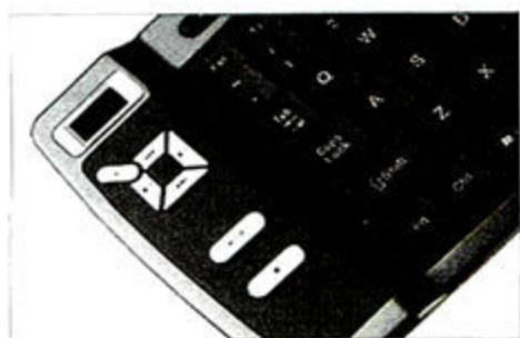
⊖ 键盘左侧拥有鼠标滚轮和完整的媒体播放热键
