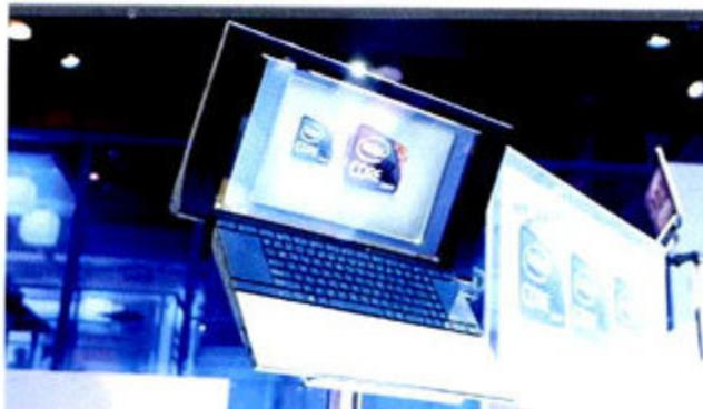
① 华硕的梦幻Core i7机型NX90Jq,被英特尔作为典范产品,高高地悬在展位最醒目的位置。这款19英寸的笔记本电脑不仅硬件配置极为强悍(采用Core i7处理器,大容量内存和硬盘,BD Combo光驱, GeForce GT 335M显卡,USB 3.0接口),而且还通过了B&O音频技术认证。
