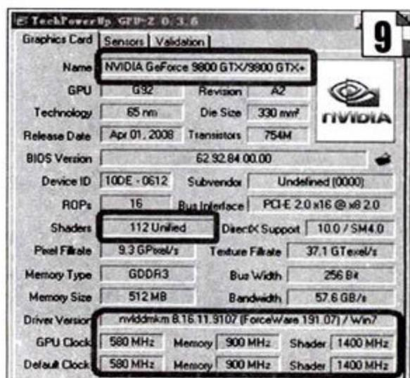
GeForce 9800 GT显卡了。接下来进入DOS界面, 运行“nvflash -4 -5 -6 MOD98GTX.rom”命令(图8), 把修改后的BIOS刷新到GeForce 9800 GT显卡上。待刷新BIOS完毕之后, 重新启动电脑就能够看到GeForce 9800 GT的设备ID已经被修改为GeForce 9800 GTX+, 只不过频率还是原来的580 MHz /1400 MHz /1800MHz, 并且流处理器依然为112个(图9)。
