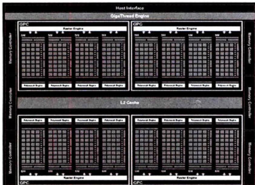
从以上的数据看，GF100提供了数量更多的CUDA核心，GT200仅有240个CUDA核心，而GF100达到了512个。与GT200相比，GF100的架构中不再有TPC这一级的单位，而增加了一个叫做GPC的单位。SM依然存在，在GF100中每个GPC包含4个SM，每个SM有32个CUDA核心，而GT200的每个SM仅仅包含有8个CUDA核心，可以说GF100的每个SM的单精度计算能力比GT200的SM提高了3倍。相比较GT200核心，GF100拥有以下四点的性能改善：
