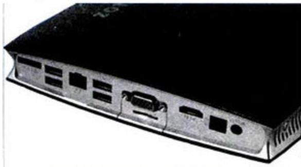
⑩ 索泰魅酷MAG提供了6个USB接口和速度更快的eSATA接口，可以直接播放移动硬盘中的高清片源。
