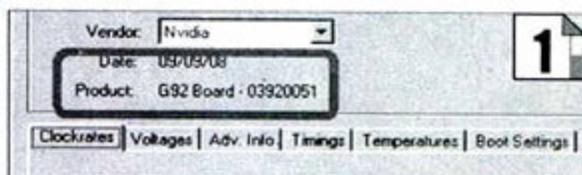
存品牌、显存类型、显存时序尽可能一致), 例如笔者手中这块GeForce 9800 GT使用了HY的GDDR3显存颗粒, 因此必须下载使用GDDR3的HY显存颗粒、PCB版本号为03920051的GeForce 9800 GTX+的BIOS文件。
