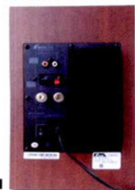
③ 音箱背部的高音和中低音采用分离式的接线方式
