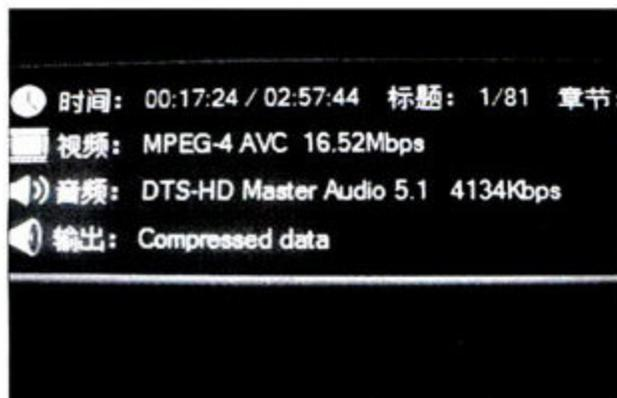
图4: 蓝光电影中的DTS-HD MA 5.1声道音轨,音频输出显示的是压缩数据,也就是源码输出。
