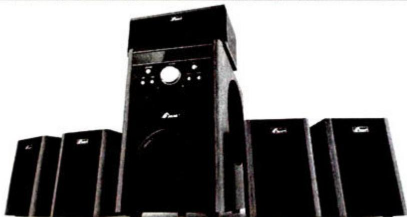
三诺AV-6501是一款“轻量级”的5.1声道音箱,它没有夸张的体积和功率,价格也相对便宜,不过其87W的RMS总功率满足15平方米左右的房间还是足够了。在单元配置方面,它使用了一只6.5英寸低音单元+五只3英寸中高音单元的搭 配,并通过七颗TDA2030A功放IC进行驱动。由于定位相对低端,AV-6501的中置音箱和环绕箱采用了相同的结构,单只3英寸中高音单元足以应付回放人声的需求,如果是想获得较好的高音,就显得有些不足。不过在箱体用料方面,这款音箱没有任何缩水,其中低音炮的箱体厚度达到12mm,卫星箱的前障板和侧板的厚度分别为6mm和9mm,有效防止箱体谐振现象的产生。
