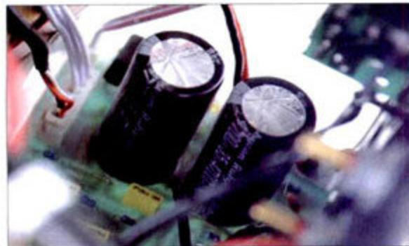
① N-35G摩机冠军版前级部分的两颗35V/4700µF的电解电容
