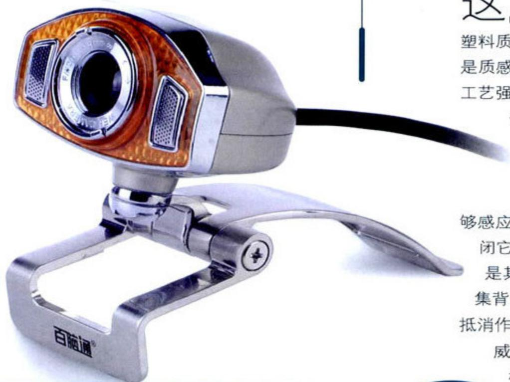
这是一款来自奥尼国际旗下百脑通品牌的摄像头新品——威影至尊版。不同于市场中造型千篇一律、充满塑料质感的大路货，威影至尊版在外观设计上下足了工夫。一是质感好，威影至尊版除了在底座采用铝美合金，并通过拉丝工艺强调这种金属质感之外，还为机身上的塑料材质进行了金属色喷漆，并嵌入了亮银色的镶边。二是通过能够变换七种色彩的“七彩魔灯”，提升产品的视觉效果。半透明的前面板内置有背光灯，连接上电脑后会自动点亮。机身上的金属镶边能够感应手指动作，轻触它即可切换背光的色彩，当然也可以关闭它。镜头两边的蜂窝状格栅，分别内置有两个麦克风，这是其特有的双咪隐形抗噪麦克风。它们分工明确，一个收集背景噪音，另一个收集用户声音，然后利用正、负弦波的抵消作用，起到消除噪音，保持通话清晰的作用。
