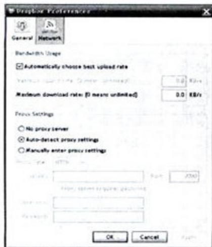
时才需要简单设置——右键单击任务栏Dropbox图标,选择“Preferences”,进行相应参数的更改。此配置菜单也提供同步带宽限制,用以防止占用过高带宽造成网络阻塞。
