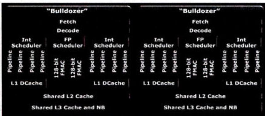
“Bulldozer”的四核心处理器实际上是由两个“核心模块”并联而成, 依旧共享三级缓存和北桥模块。
