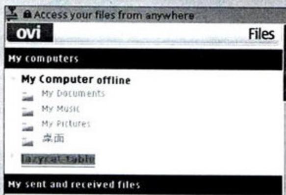
**Step 2** 手机会启用https加密协议来传输账户信息,具有较高的安全性。验证通过后,手机屏幕上将显示Ovi Files客户端电脑上所有的盘符。如果页面左上角的连线状态为offline,就需要手动点击客户端电脑的名字进行刷新。
