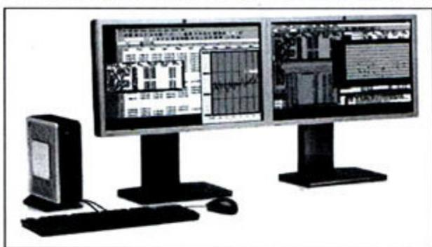
1.访问层-桌面展现层：用户可以使用传统台式电脑、笔记本电脑、瘦客户端其中的任何一种终端，通过使用惠普远程图形软件(RGS)，在显示器上远程操作刀片PC上的业务界面；
