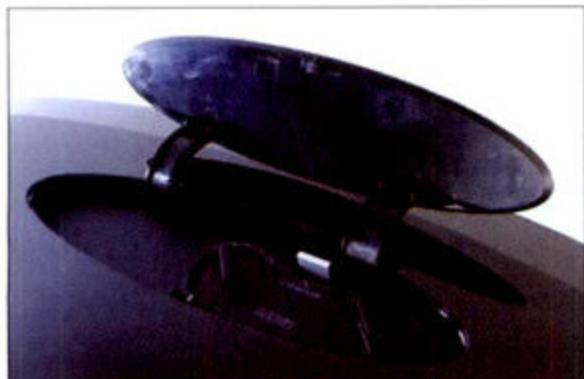
① 大多数投影机都把镜头的位移调整旋钮设计在机腹的前部，调节时非常不方便；而比较人性化的设计是放在机身的侧面，方便用户进行调校。奥图码HD86则干脆将其放到了机身顶部的一个内凹隐藏仓内，用户调节时，只需在机身顶部轻轻一按，弹开舱门即可调节，轻松方便。
