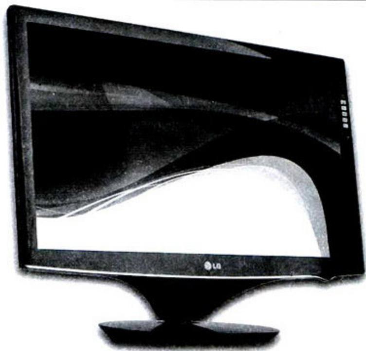
LG今年显示器产品中最漂亮的造型是什么?相信绝大多数用户都会投票给W86系列的夜光杯造型,采用了白光LED背光后的W2486L仍然继承了这一经典的设计,更融入了此前产品所没有的,最薄仅19mm的机身,整体观感又上了一个台阶。做工方面值得称道的是W2486L椭圆形的底座,虽然看上去并不大,但其内部的金属配重份量十足,为24英寸的大尺寸屏幕提供了稳定的支撑。从整体来看,它是一款强调设计的产品,因此价格也不便宜,再加上大尺寸的屏幕,W2486L在目前采用白光LED背光的显示器中,属于面向中高端消费群体的产品。
