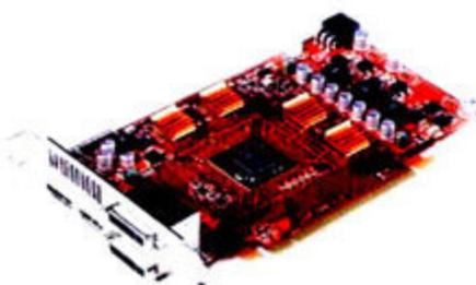
② 拆掉热管散热器后PCB的正面，可以看出该显卡采用了优化后的非公版设计。
