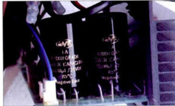
① N-35G摩机冠军版后级部分的两颗10000µF的英国NOVER电解电容
