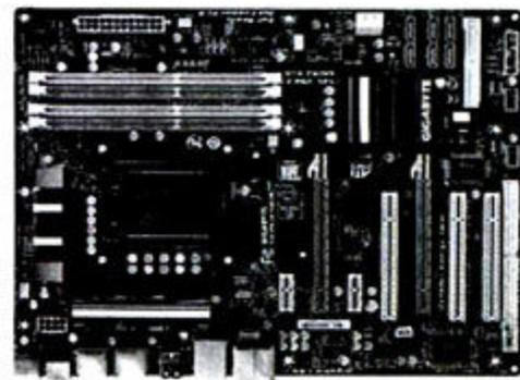
继发布一批P55主板后，技嘉又趁热打铁带来了“333”技术的P55A系列主板。它采用标准的ATX板型，蓝白配色清爽宁静，整片主板依然继承了技嘉高端产品用料扎实的血统。除了配备USB 3.0、SATA 3.0和三倍供电以外，技嘉还把2条PCI-E 1x、1条PCI-E 16x、1条PCI-E 4x和3条PCI接口也通通放了进去，保证扩展的需求。
