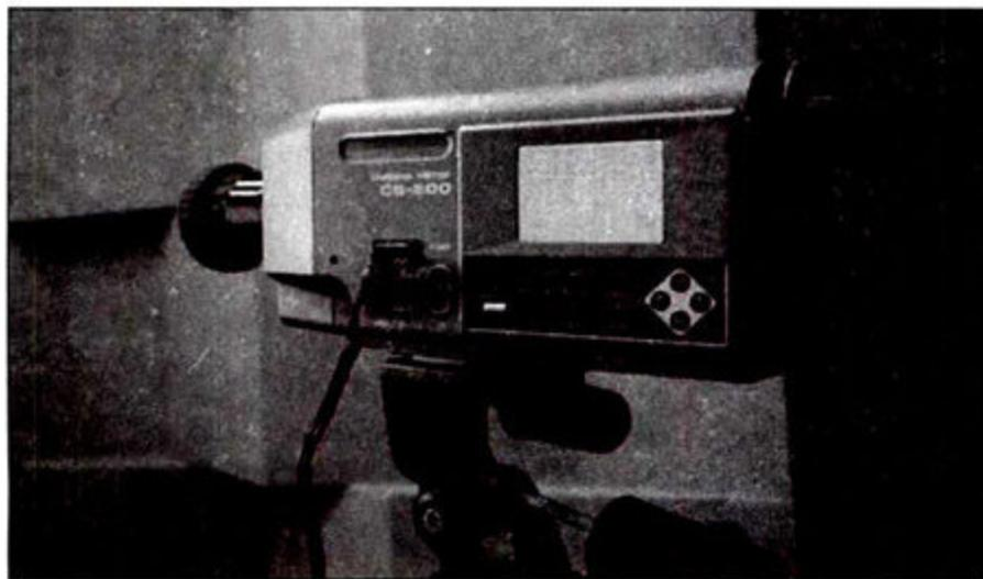
① 客观性能测试中采用的柯尼卡美能达CS-200分光色度仪
