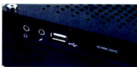
① DN12配备了三合一读卡器和侧面的USB接口, 更方便使用。
