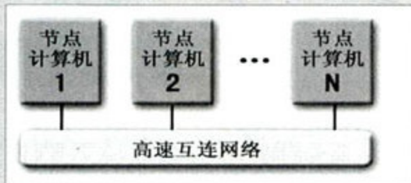
① 机群式超级计算机结构
