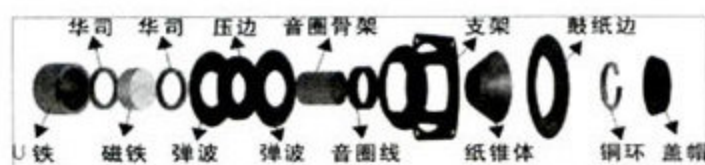
① 慧海F80低音单元分层结构图
