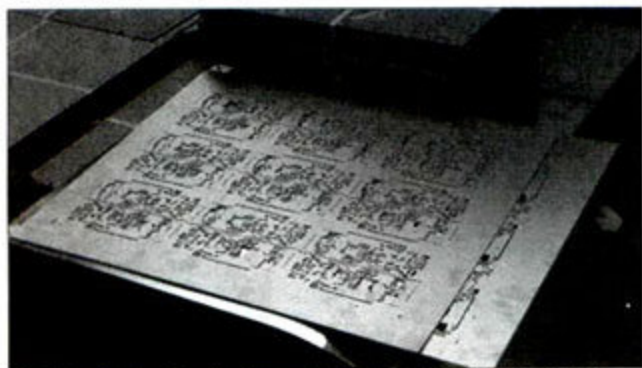
① 没有涂覆阻焊漆的PCB铜层暴露在空气中极易氧化。
