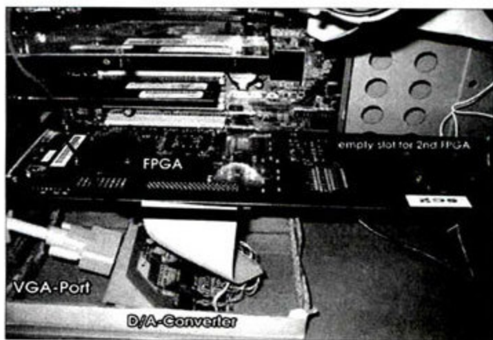
① 由2个FPGA组成的SaarCOR
