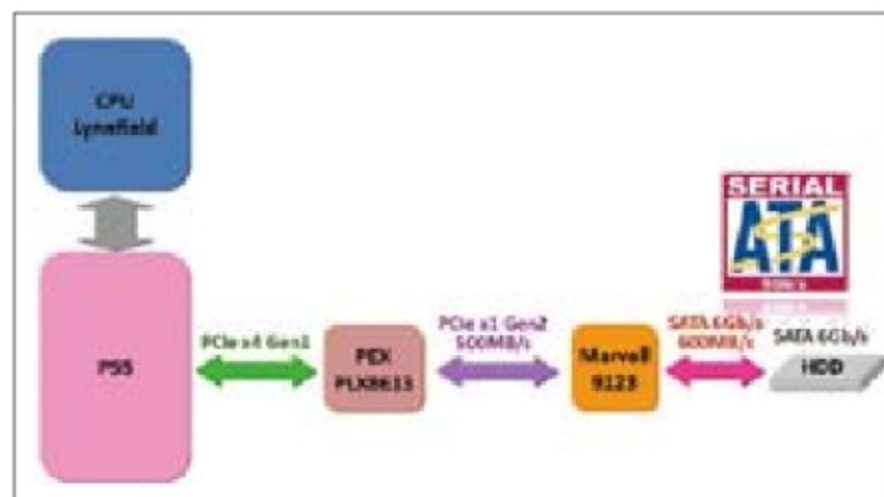
通过PLX 8613桥接芯片的巧妙转换,华硕主板以500MB/s的带宽连接Marvell 88SE9123。
