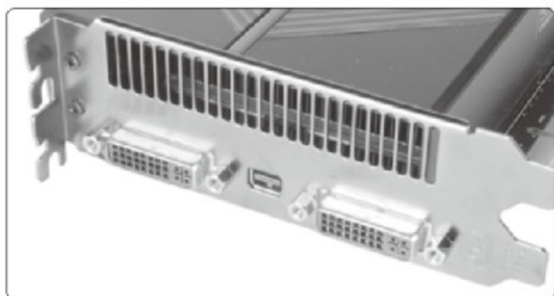
① Radeon HD 5970的接口为双DVI+M in DisplayPort, 依旧支持三屏输出
