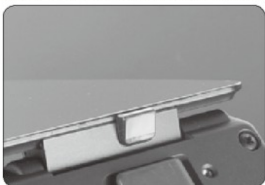
① 两个胶垫在打开时既可以起到防止屏幕打开过度的作用,也可以作为脚垫,设计颇见巧思。
