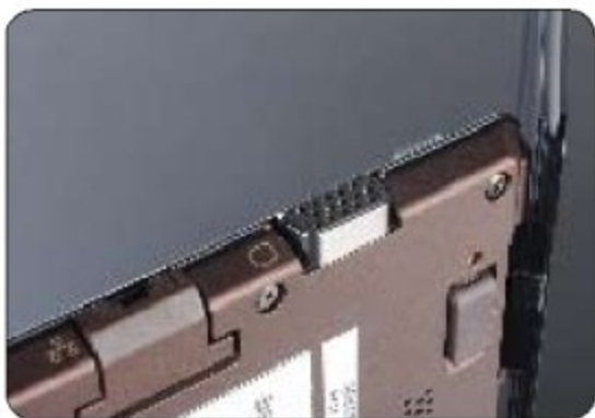
① 为了在扩展性与轻薄两方面取得平衡,VAIO X的设计可谓煞费苦心,下部几乎裸露并与底部保持水平的VGA接口就是明证。
