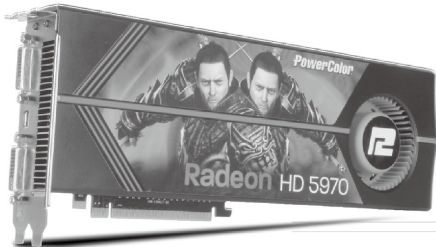
① Radeon HD 5970的接口为双DVI+M in DisplayPort, 依旧支持三屏输出
