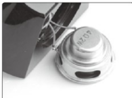
① 单元的阻抗为4Ω,最大承载功率为2W。
