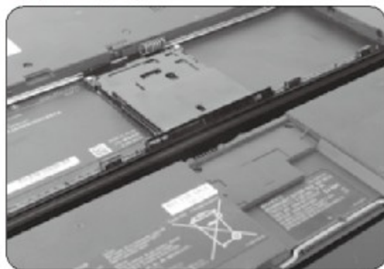
① 4个电芯分开两边放置,中间的空间被触摸板模块和读卡器模块利用起来,真应了“寸土寸金”。
