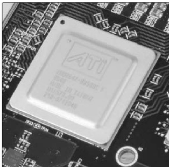
④ 两颗GPU之间的桥接是由AMD与PLX共同研发、代号为AMD8647-BB50BCF,能够提供PCI-E通道功能的PCI Express Switch芯片来完成,PLX的桥接芯片曾被应用在Radeon HD 3870X2/4870X2上。相比过去AMD双核心显卡使用的PLX PEX 8547芯片而言,AMD8647-BB50BCF支持PCI-E 2.0(PLX PEX 8547支持PCI-E 1.0,双x8的带宽只有6.8GB/s),两颗GPU可以以21.8GB/s的速度进行数据交换。此外,该芯片还能最多支持48条PCI-E通道,支持最多拆分成3个连接端口,支持3芯片互联。
