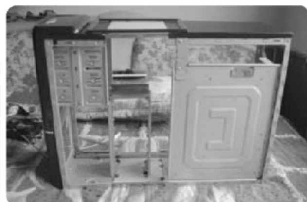
① 暗夜公爵机箱加长之后的架构，明显可以容纳更长的显卡。
