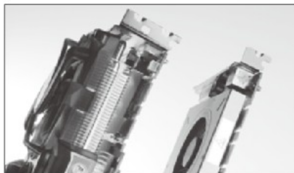
④ GTX 260+无双显卡(右)与双槽散热器的GeForce GTX 260+显卡厚度对比
