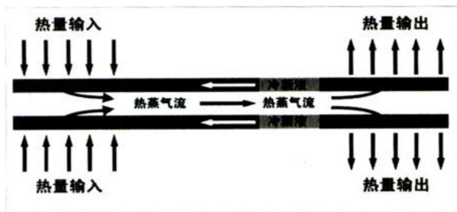
热管的内部结构和工作原理示意图
