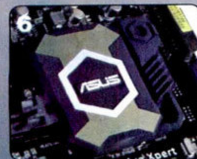
6 PCH散热片同样使用 CeraM!X陶瓷镀膜散热片设计
