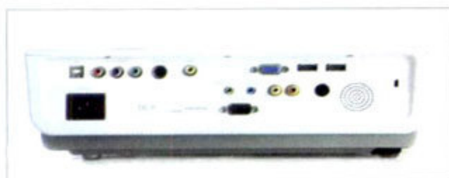
出于成本考虑，明基W1000的接口配置稍有精简，只保留了两组HDMI、1个VGA、1个USB、色差端子、复合端子、红外线接收器和一个+12V输出接口（支持电动幕布）等，尽管没有高端机型那么丰富，但也能够满足用户的需求。这基本上是目前万元级1080p投影机的标准配备。
