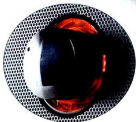
▲ 位于前面板右侧的音量旋钮，通电后旋钮周围会亮起红色光圈。
