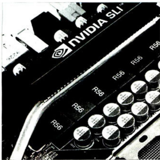
穿Fin工艺由于成本较低、制造方便而渐渐流行了起来。诸如技嘉、华硕以及其他主板生产商普遍采用此类技术。这款高端X58主板散热片就采用了穿Fin技术。
