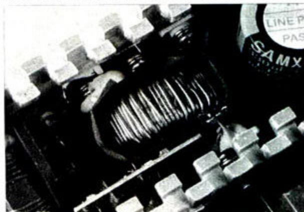
主动式PFC的电感线圈往往位于高压滤波电容的前方 主动式PFC的功率因数则高达0.9以上，明显优于被动式PFC。两者的分辨也相当容易。
