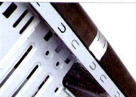
▲ 主机架与侧板接触处设计了密集的防辐射触点
