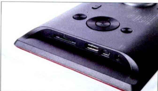
▲ PF7066B的接口都位于背部左侧,包括了三合一读卡器、USB HOST/SLAVE接口以及外接电源接口。
