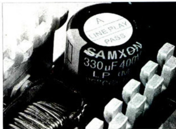
鑫谷劲翔500静音版电源采用主动式PFC，因此使用容量为330µF的高压滤波电容就能满足需求。该电容的耐压值为400V，耐温值为85℃。
