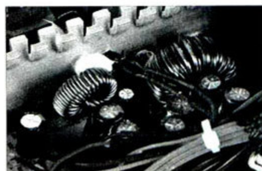
低压滤波电路部分主要看电感线圈
