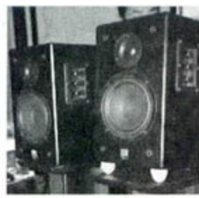
为了让所有参赛音箱在同一标准下进行公平竞争,每套音箱在进行听音评判之前都会摆位调试,并使用手持式声压计,利用白噪声和粉红噪声进行音量调节。
