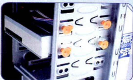
➤ 光驱和硬盘采用的提拉式锁扣
