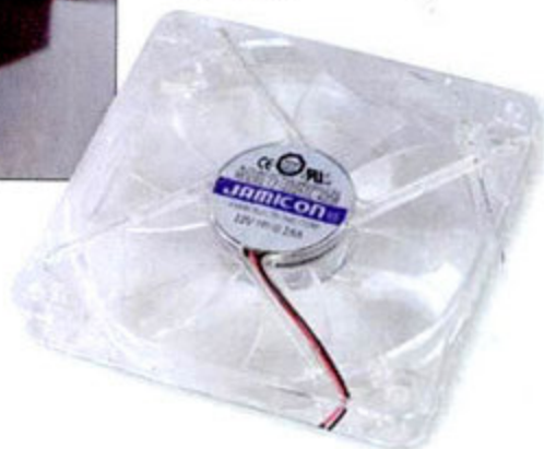
▼ 从机箱卸下来的前置风扇,静音和散热效果不错。
