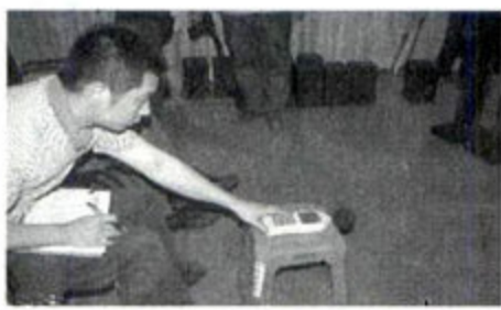
为了让所有参赛音箱在同一标准下进行公平竞争,每套音箱在进行听音评判之前都会摆位调试,并使用手持式声压计,利用白噪声和粉红噪声进行音量调节。
