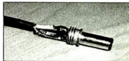
由于厂商配送的充电器插头与电源线为一体式结构,破损后只能更换整个插头。
