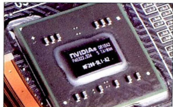
➤ MARS显卡上的NF200 SLI桥接芯片，该芯片主要负责两颗显示核心之间的数据通讯。
