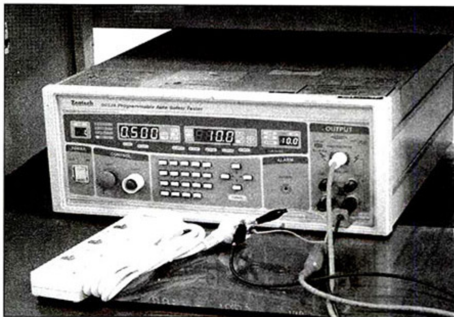
Zentech 9032A综合测试仪,检测排插绝缘阻抗。
