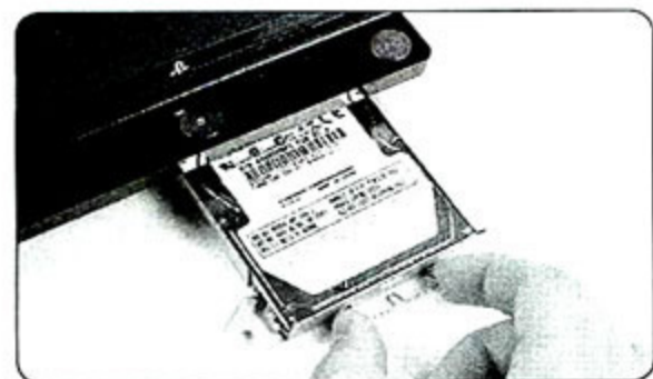
> 拆下电源键下方的挡板，拧下螺丝，即可抽出由东芝制造的2.5英寸120GB SATA硬盘。硬盘标签上有“MADE IN CHINA”字样。
