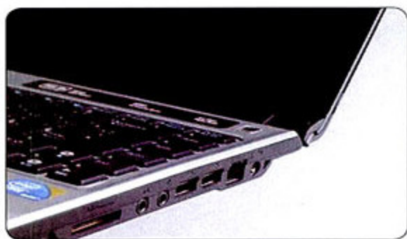
■ 左右借口布局合理, 接口丰富, 包括VGA和HDMI在内的多功能扩展接口丰富了UL30A的应用层面。不过也正是为了兼顾VGA接口, UL30A的左侧局部看起来略略有些“臃肿”。
