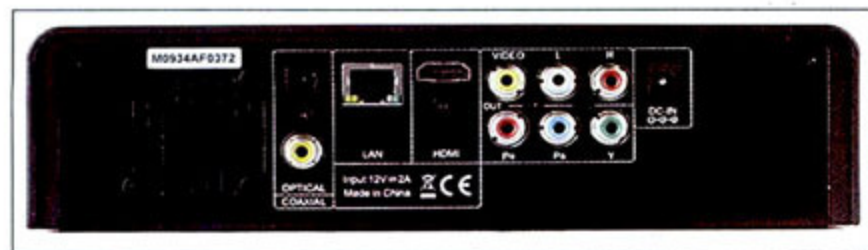
背部的接口比较全面, 音频视频输出都比较完备。左边是采用主动式散热的4cm散热风扇, 可以有效地将热量排出。
