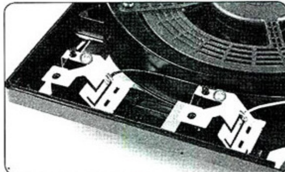
> 风扇下方的蓝牙和Wi-Fi天线部分均由一颗螺丝固定。
