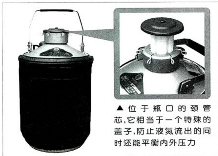
一个符合标准的存储式液氮杜瓦瓶
