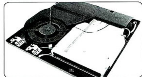
> 除去主机外壳上的螺丝(少数螺丝位置较为隐蔽)，打开上盖，才发现PS3 Slim原来还穿了一件“内衣”。
