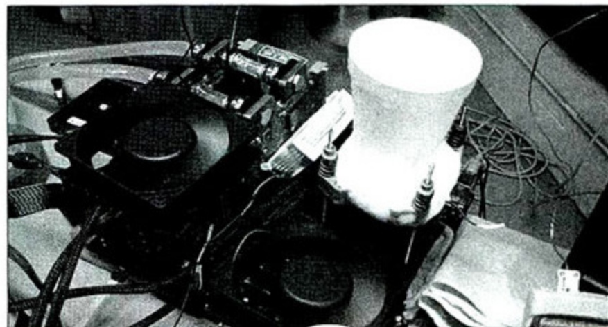
这个平台同时使用了液氮、暴力风扇和水冷散热
