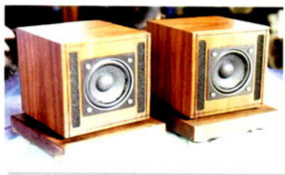
▶ 采用迷宫式箱体设计的天权无源音箱,与密闭箱和倒相箱等设计相比,具有更为深沉的低音,可以弥补小口径单元低频的不足。
