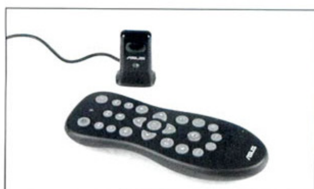
遥控器也出现在了显卡包装里, 接收器上还有侦测光线亮度的元件。
