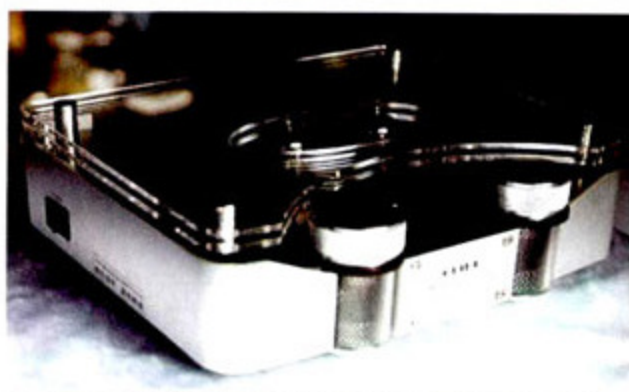
▶ 同为前胆后石设计的纯甲类麒麟座功放,后级为场效应管。
