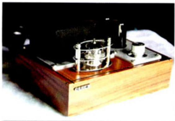
▶ 天马座功放为前胆后石设计,后级采用国产LM1876TF晶体管,外形小巧时尚。
