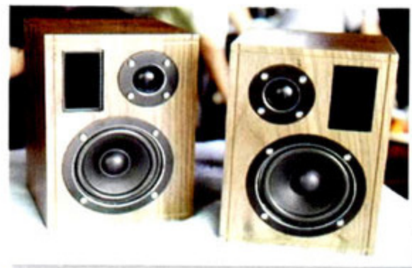
▶ 天枢采用双腔体结构设计,既能保证低频的量感又能保证解析力,相比天权,其节奏感更明显,速度感更好。
