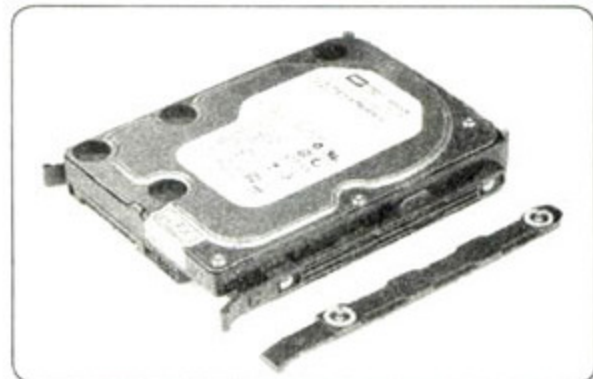
> 硬盘先安装导轨，再轻轻推入硬盘架就完成了安装。
