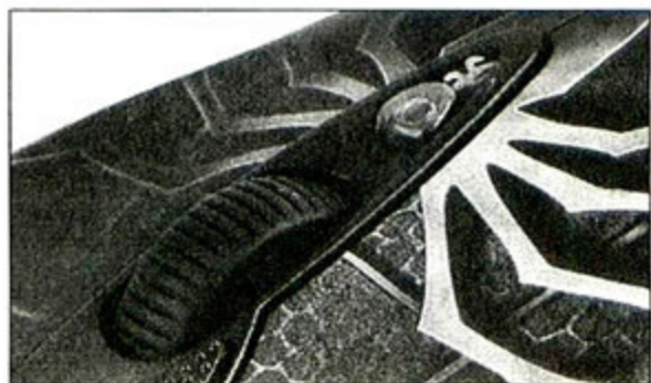
滚轮背后的分辨率调节键,不同背光代表着不同的分辨率。
