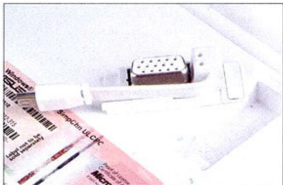
■ 贝壳机的底部被开辟了一块空间出来用于内藏VGA转接头。不得不说这是一个非常巧妙的设计,不但很好地保证了贝壳机外观的统一性,而且完全不占据任何额外的空间。不过我们在评测中发现,转接头上的磁条如果能想出更好的固定方法,会更棒。
