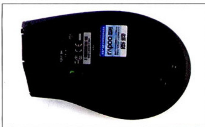
▲ 鼠标底部拥有电源开关和接收器收纳仓
