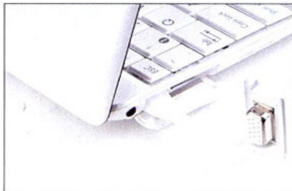
■ 贝壳机的底部被开辟了一块空间出来用于内藏VGA转接头。不得不说这是一个非常巧妙的设计,不但很好地保证了贝壳机外观的统一性,而且完全不占据任何额外的空间。不过我们在评测中发现,转接头上的磁条如果能想出更好的固定方法,会更棒。
