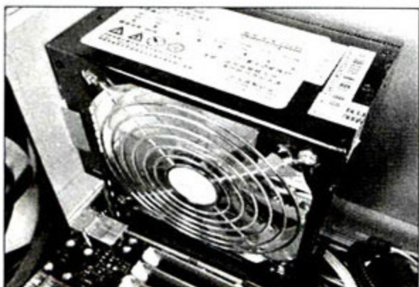
① 标配电源为长城双卡王BTX-500SE，额定功率为400W，拥有4个SATA供电接口，扩展能力不错。
