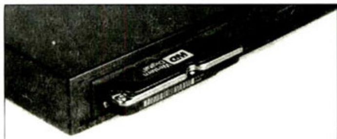
⊙ 关机状态下插入2.5英寸SATA硬盘, 开机后DMP410就能播放存储在硬盘上的高清视频。
