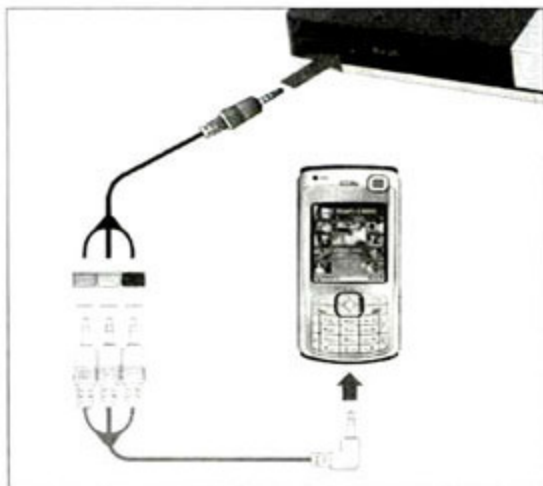
图7 通过智能手机的专用AV数据线连接手机和超便携投影机
