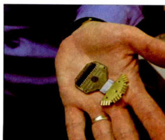
■ 马里奥·潘手里的Intel 8通道(每通道25Gbps)200Gbps集成硅光子发射器
