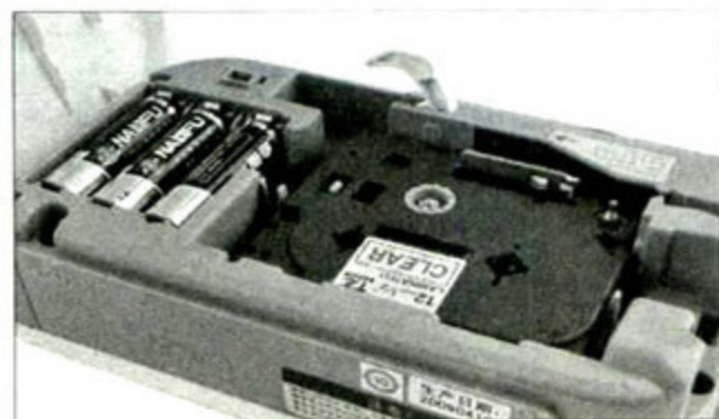
PT-2430PC采用热转印工作模式, 打开侧盖后可以看到电池仓、色带及加热元件等核心部件。
