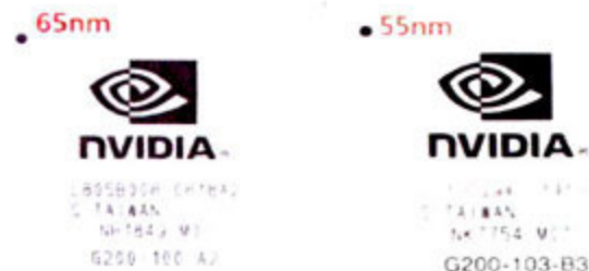
左图为192SP的GTX260芯片，右图为216SP的GTX260+芯片
