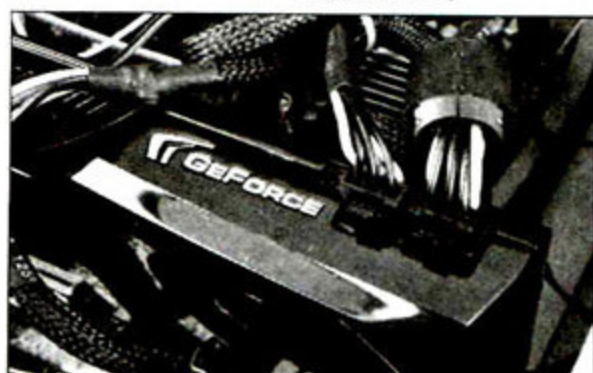
⑥ 两个6 Pin供电接口均被GeForce GTX 260占据，若要使用GeForce GTX 260这样的高功率显卡组成SLI系统，则必须更换电源。
