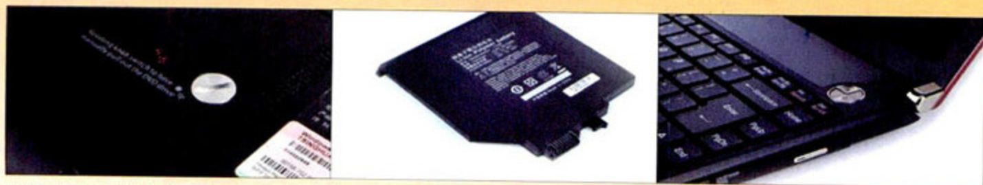
标配第二块电池,置入光驱仓位延长续航时间。
