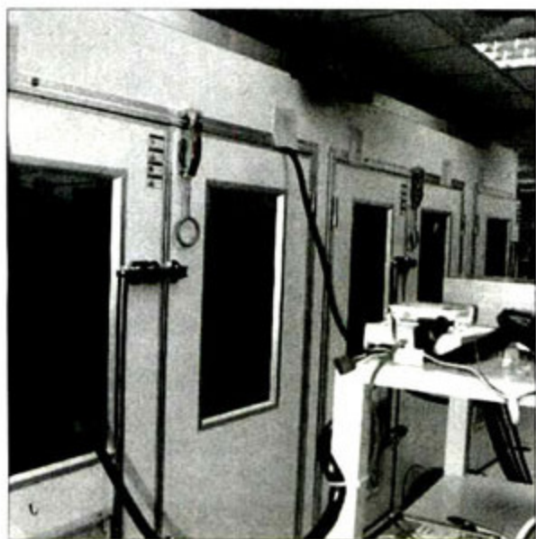
高温测试房,各种型号的主板上市前都要进去接受“考验”。
