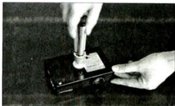
图1 首先给超便携投影机接上脚架，这样更容易调节它的投影机方向、高度和角度。
