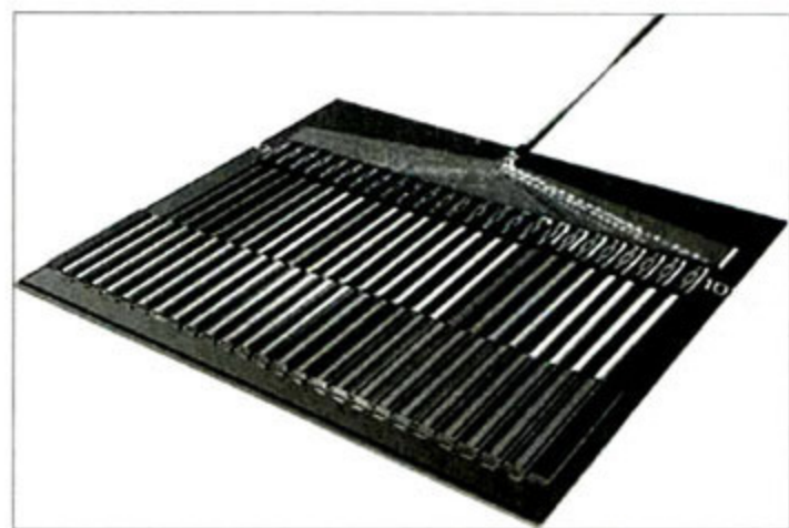
图12 拥有25个混合硅激光器的硅片光传输系统,该系统可实现40Gb/s带宽。
