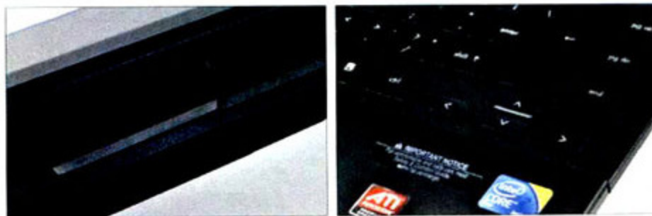
■ Latitude E5400的显示屏采用了卡扣设计,闭合时比较稳固。 ■ ProBook 4411s的上下方向按键面积偏小,使用时有些不便。
