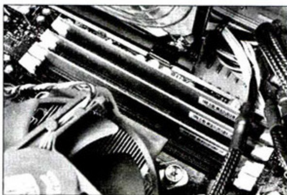
② 雷神X7标配的主板仅有4条内存插槽，仅能支持一组三通道内存系统，若要扩充内存容量则必须废弃原配的内存，扩展性受限。
