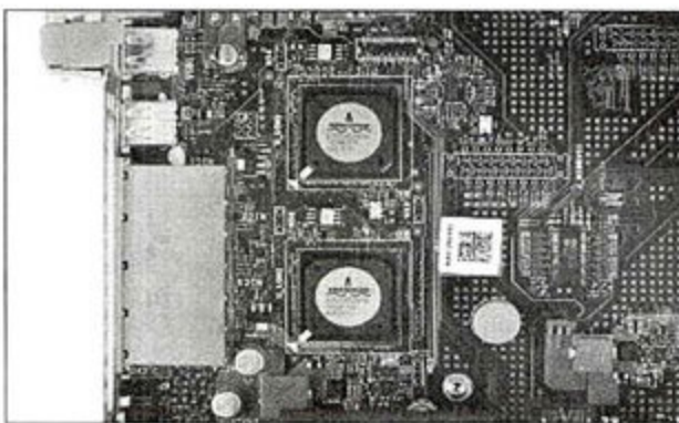
两颗Broadcom NetXtreme II 5709芯片提供了4个千兆网络接口,支持网络冗余和负载均衡功能。
