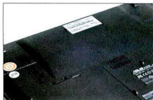
底部盖板凸起设计有利于内部形成有效的气流循环
