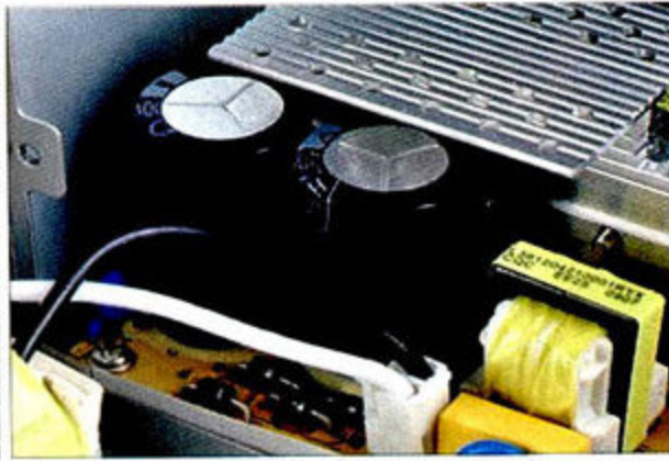
▲ 该电源使用了两个HEC 220μF高压滤波电容
