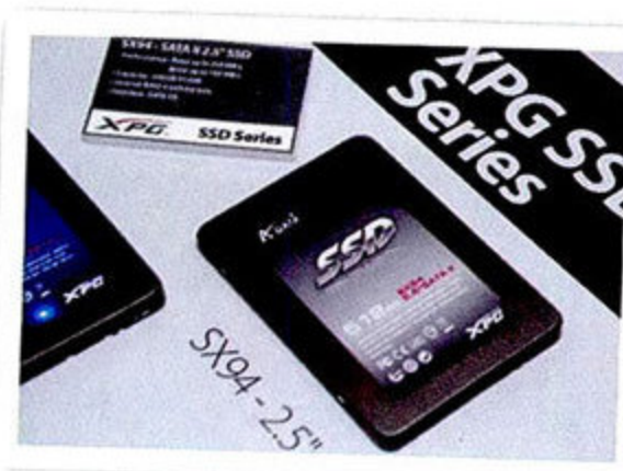
■ 再让我们看看SSD产品，威刚的这块SX94读写速度高达230MB/s和160MB/s，据悉内部使用了2×8通道的设计，也就是说8条I/O通道，然后再组成RAID 0。
