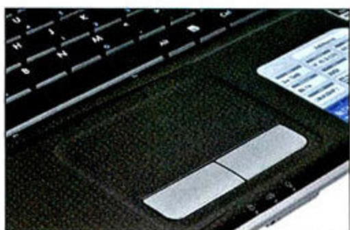
触摸板与腕托同质，小凹点可以有效防止移动不顺畅的问题。
